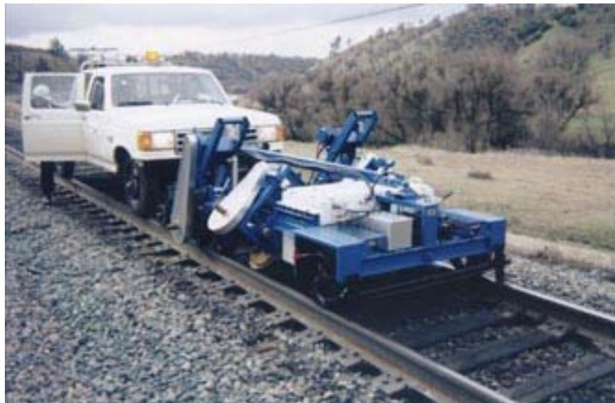
**Slika 2.1.4. Tribometar za ispitivanje željezničkih tračnica.**
