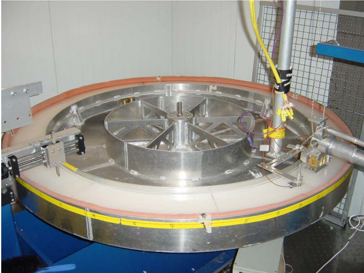
Slika 2.1.3. Posebna vrsta tribometra koji služi za određivanje faktora trenja između snijega i različitih materijala od kojih se proizvode skije.
