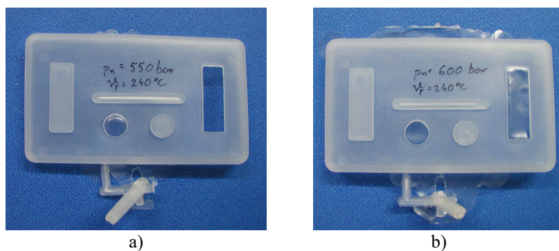
Slika 9.22 Pojava srha na otpresku (hibridni kalup): a - p_n = 550 \text{ bar} i \vartheta_T = 240 \text{ °C} , b - p_n = 600 \text{ bar} i \vartheta_T = 240 \text{ °C}
