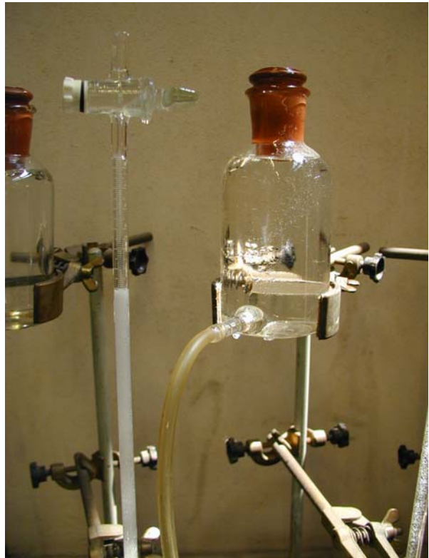
Slika 3.8 Izjednačavanje nivoa pri očitavanju razine vodika
