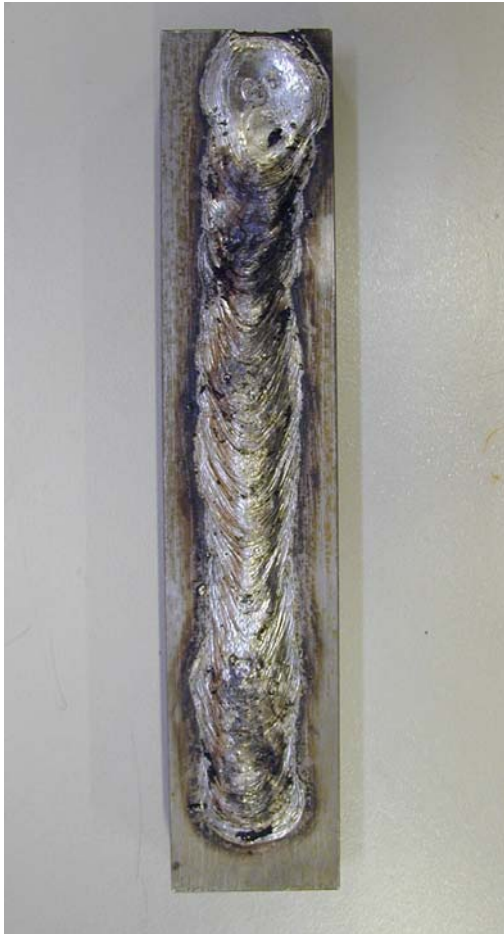
Slika 3.11 Navareni uzorak za određivanje difundiranog vodika -REL
