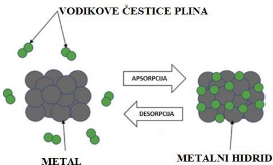
Slika 9: Skladištenje vodika pomoću metalnih hidrida [22].
