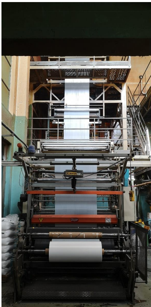
Slika 3.10. Namotavalica u liniji za proizvodnju crijevnog filma
