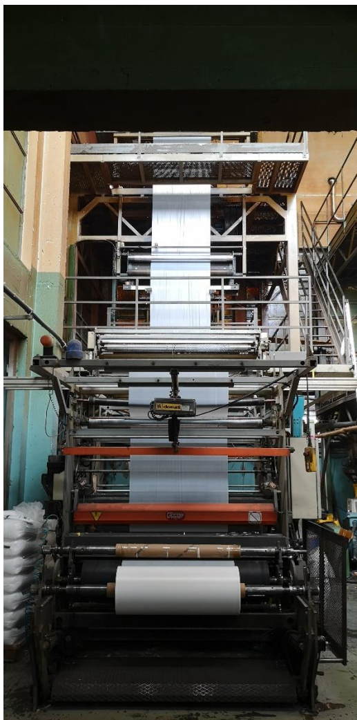
Slika 3.10. Namotavalica u liniji za proizvodnju crijevnog filma
