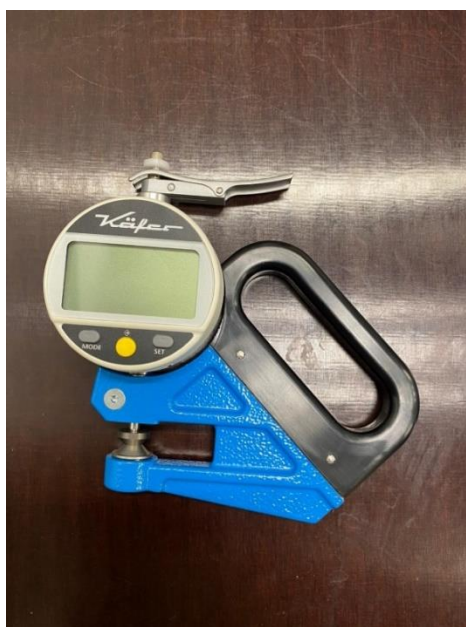
Slika 7.3. Uređaj za mjerenje debljine filmova i folija
