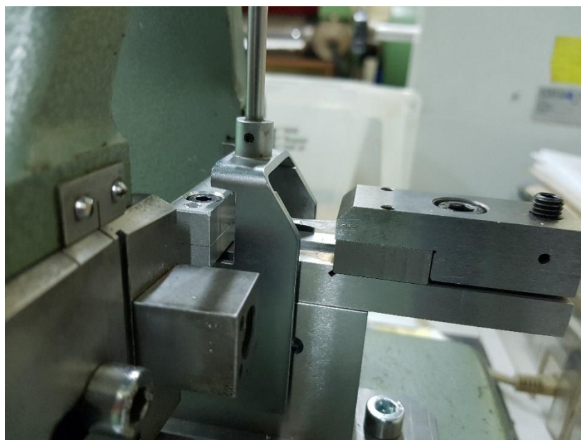
Slika 7.20. Trenutak udara bata na pomični jaram
