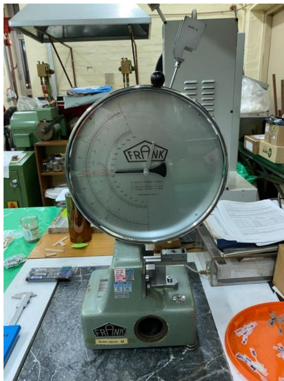
Slika 7.18. Uređaj za ispitivanje rastezne žilavosti – metoda Charpy
