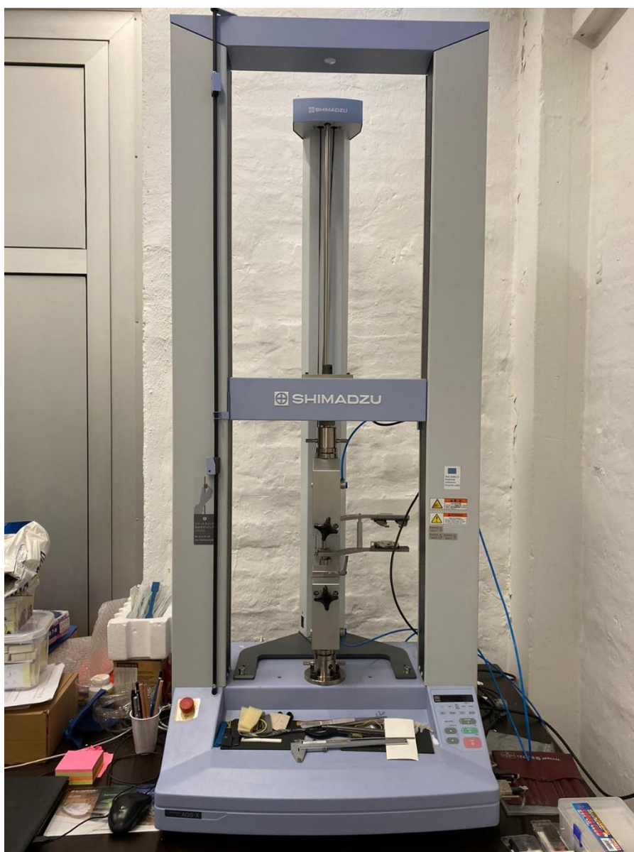
Slika 7.5. Kidalica Shimadzu korištena prilikom ispitivanja
