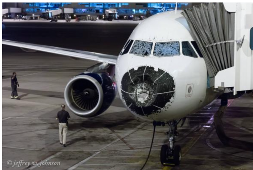
Slika 1.1: Oštećenje na zrakoplovu kao posljedica udara leda [1]
