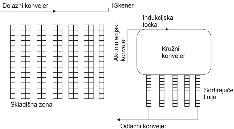
Slika 2-2. Shematski prikaz sustava za sortiranje [54]
