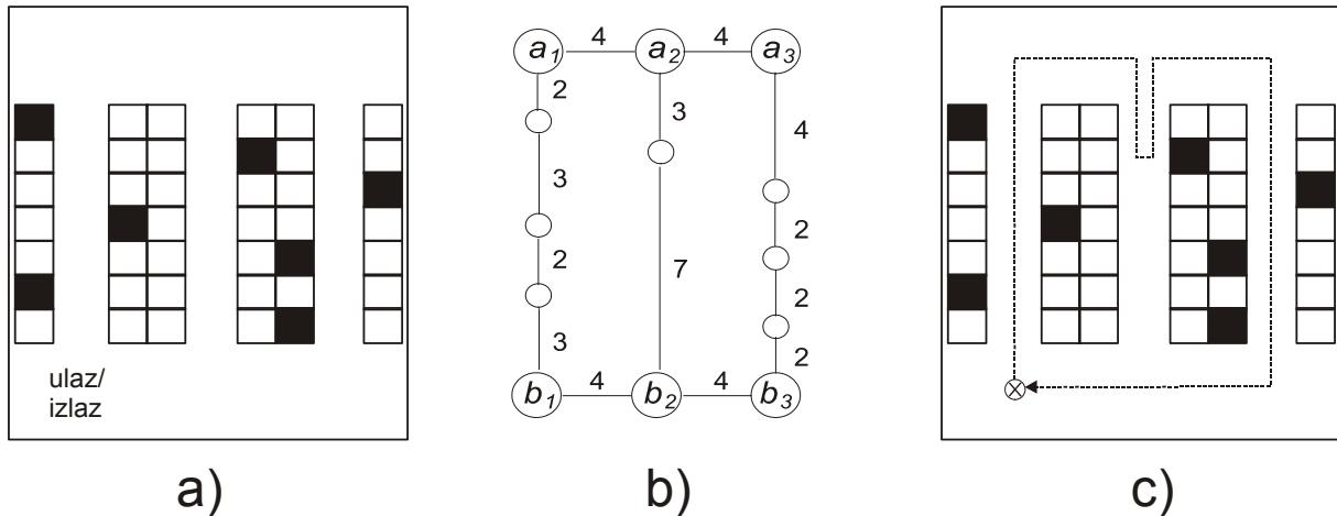
**Slika 3-8.** Shema primjene dinamičkog modeliranja i rješenja kombiniranim metodom routinga; a) primjer skadišta s traženim lokacijama, b) reprezentacija skadišta pomoću grafa, c) optimalna ruta kretanja
