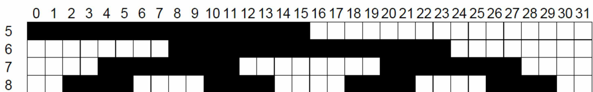
Slika 2.11. Princip metode Gray koda
