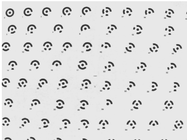
Slika 9.1. Detalj planarnog kalibracijskog objekta
