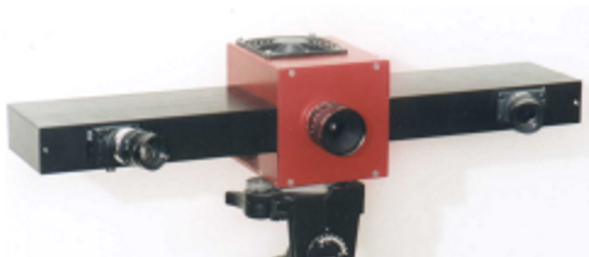
Slika 2.1. Projekcijski digitalizacijski sustav "Atos"
