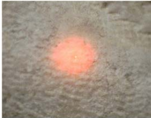
Slika 4.4. Gubitak definicije točke zbog prodiranja projicirane zrake u osnovni materijal
