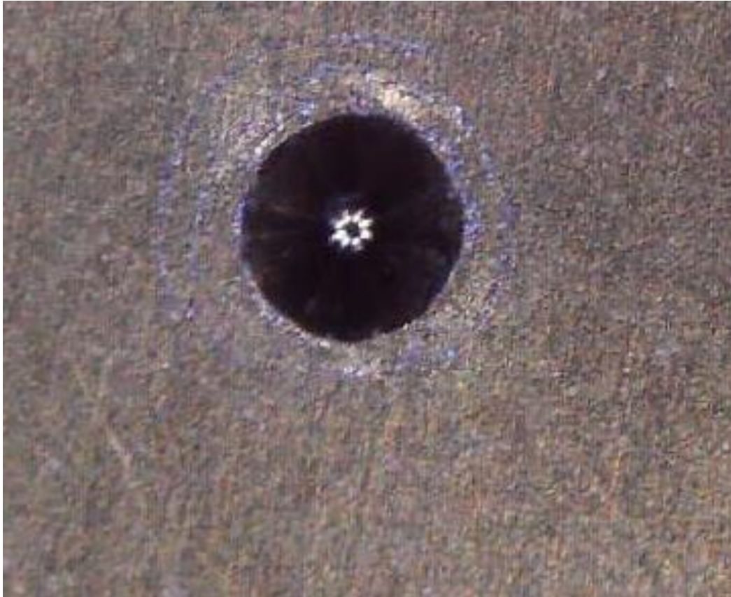
Slika 24 Rezultat ispitivanja prionjivosti TiN prevlake na EBM leguri
