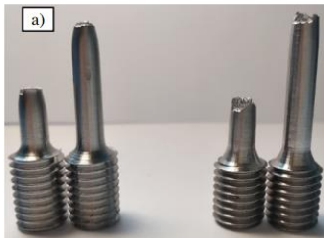
Slika 5 Usporedba lomne površine SLM uzorka (desno) i kovanog uzorka (lijevo) [31]
