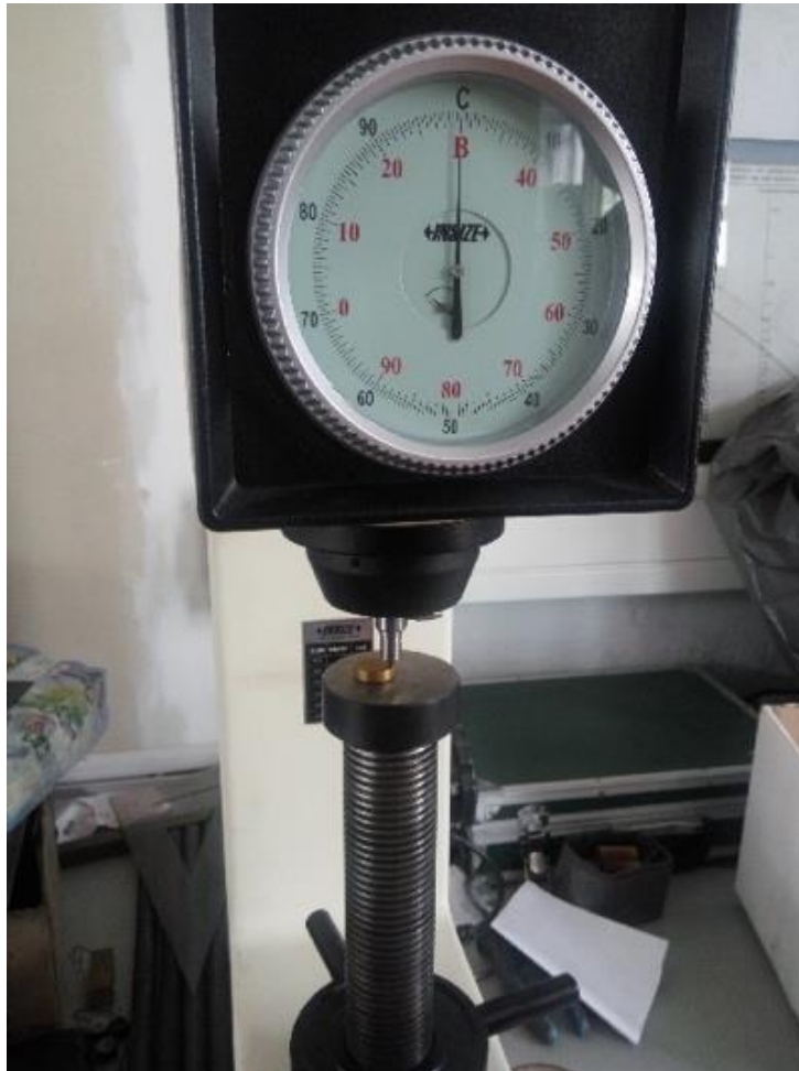
Slika 21 Ispitivanje adhezivnosti prevlake TiN na Rockwell-ovom tvrdomjeru
