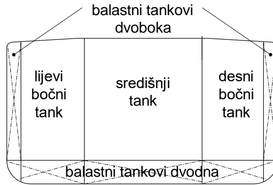
Slika 18. Tanker s dvostrukom oplatom i dvije uzdužne pregrade
