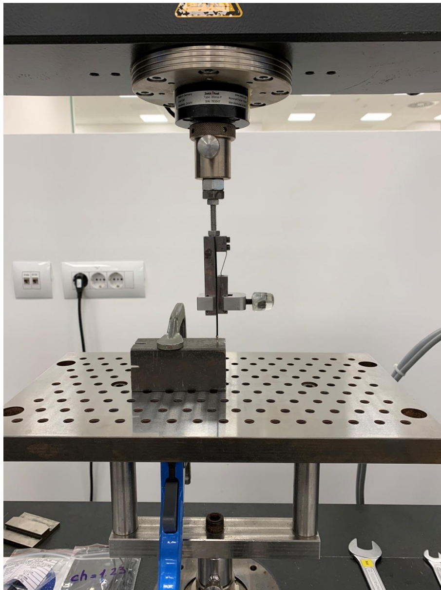
Slika 64. Postavljanje ispitnog uzorka na kidalici
