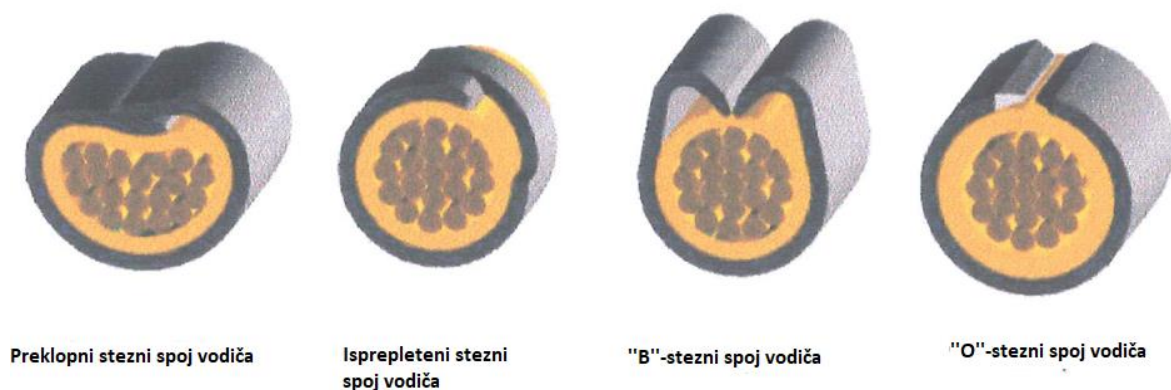
Slika 33. Oblici izolacijskog steznog spoja vodiča [18]
