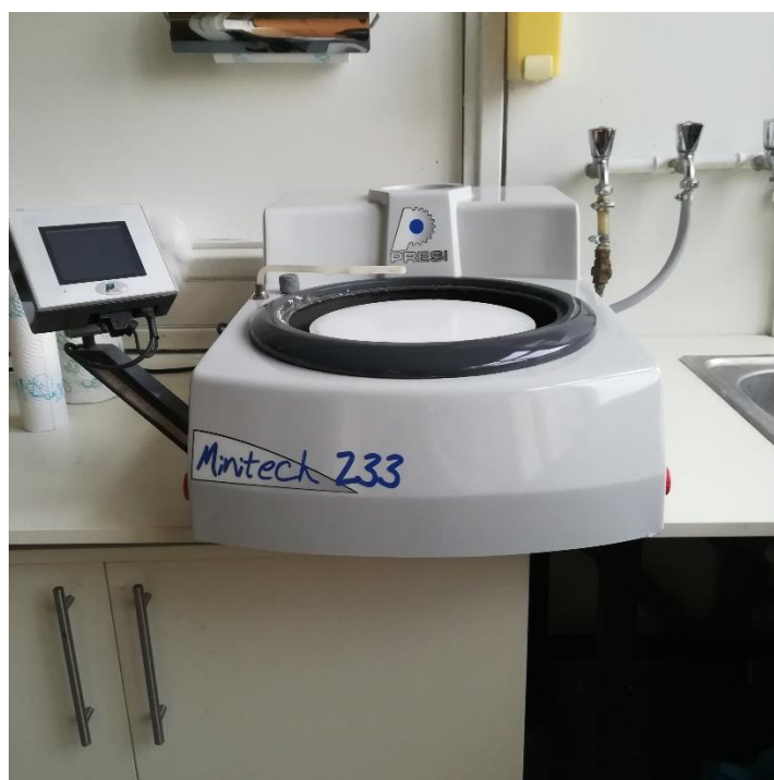
Slika 33. Uređaj za brušenje uzoraka
