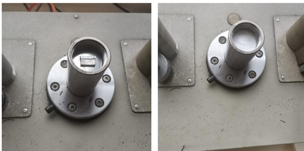
Slika 30. Postupak oblaganja uzorka prstena u polimernu masu
