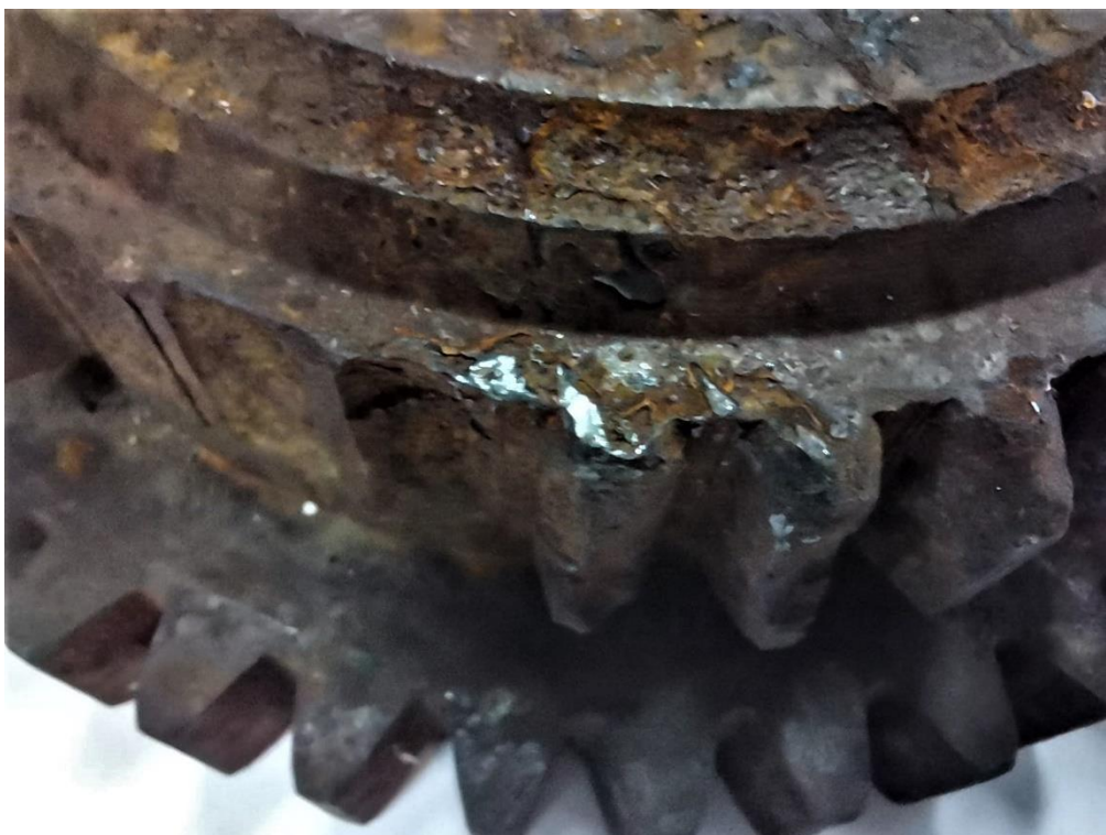
Slika 65. Prikaz korijena pukotine uslijed umora površine
