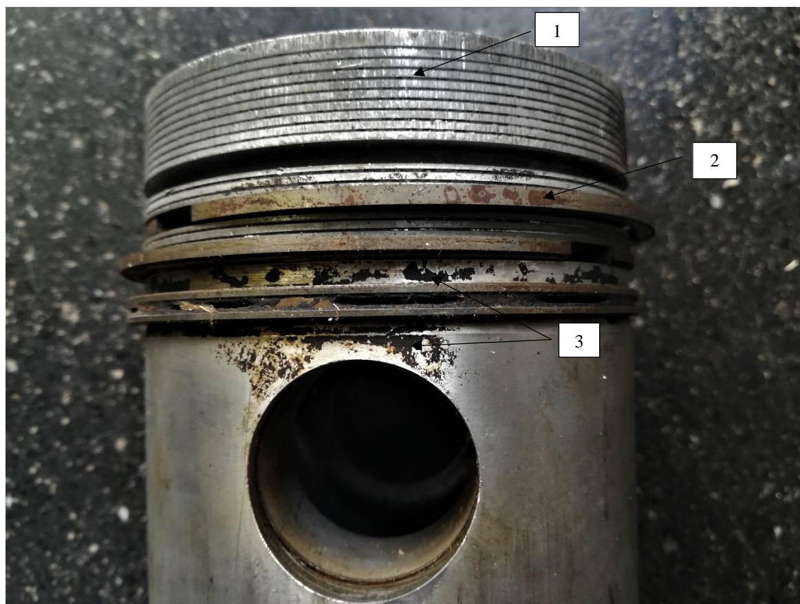
Slika 55. Tijelo klipa s označenim mehanizmima trošenja
