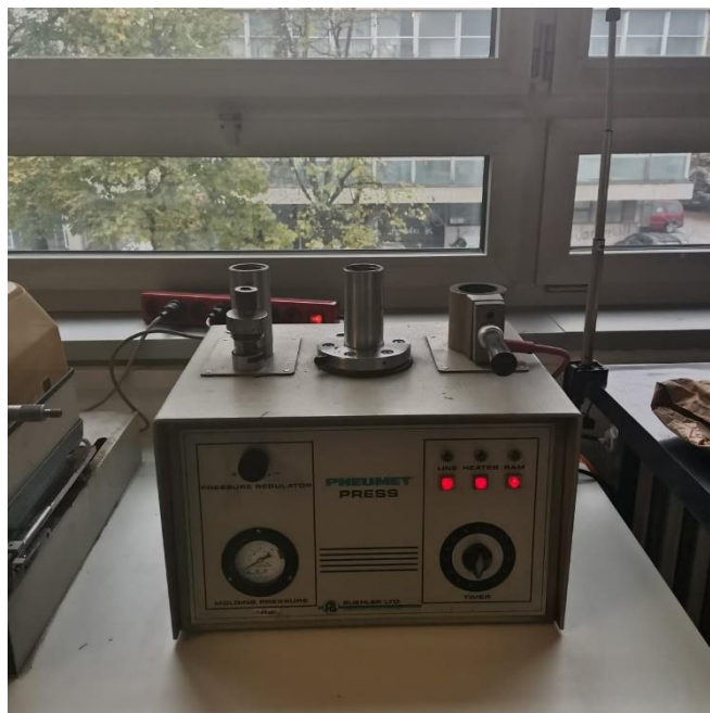
Slika 31. Uređaj za oblaganje uzoraka u polimernu masu
