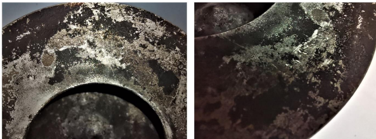
Slika 53. Abrazijsko trošenje čela klipa
