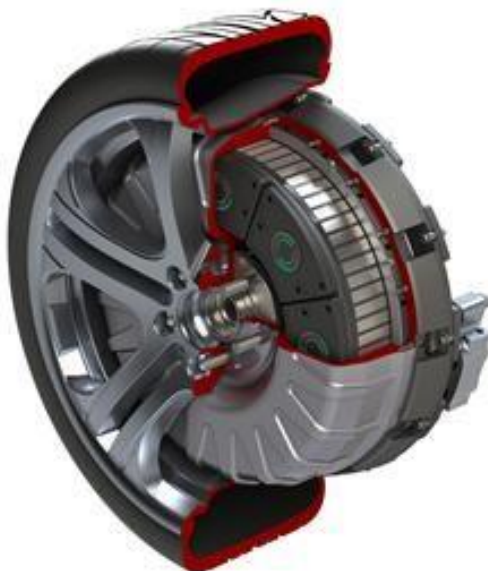
Slika 34. Elektromotor unutar kotača [81]
