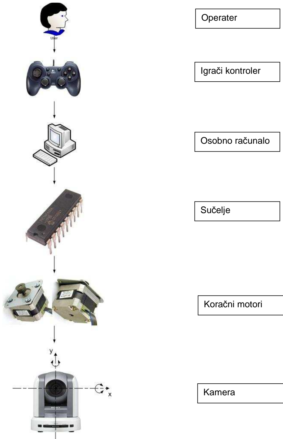
Slika 2. Principijelni prikaz rada makete
