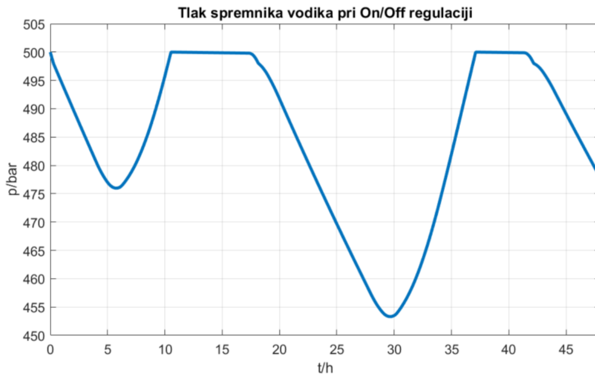
Slika 43. Tlak spremnika pri "On-Off" regulaciji
