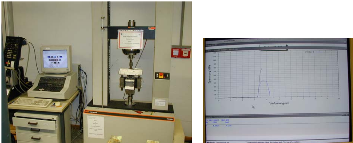
Slika 38. Oprema za mikrosmično ispitivanje smještena na TU Berlin.
