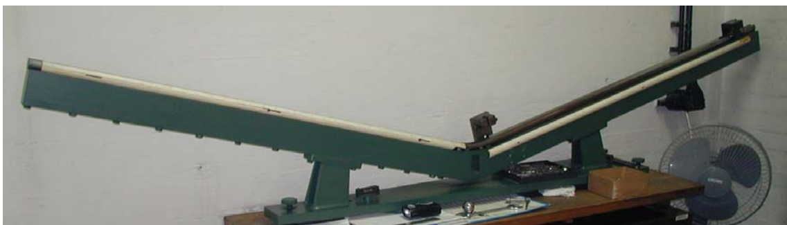
Slika 34. Uređaj za ispitivanje udarne radnje loma Zgaginom metodom.
