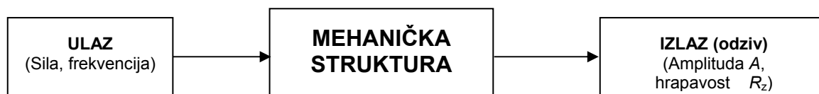
Slika 1.1. Svojstva samouzbudnih vibracija pri obradi odvajanjem čestica
