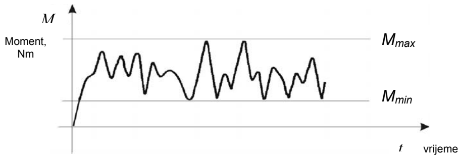
Slika 2.11. Dijagram promjene momenta
