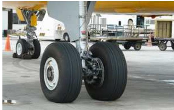
*Slika 18: Cilindar stajnog trap-a i stajni trap zrakoplova koji jedan je od primjera gdje se koristi višepretvornička ultrazvučna metoda ispitivanja [3]*
