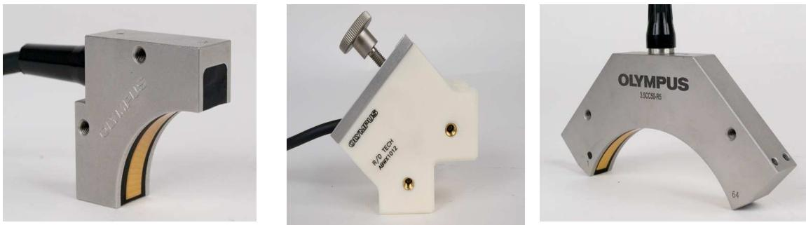
Slika 22: Sonde za ispitivanje rubova [5]
