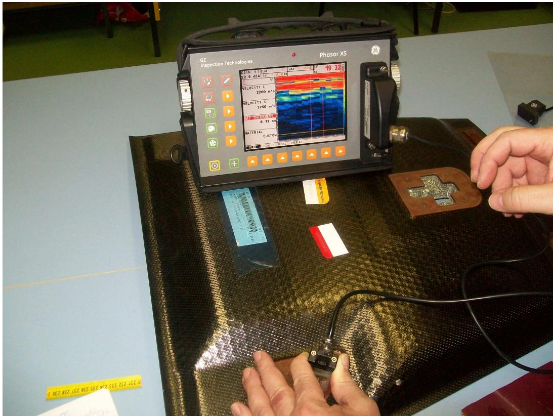
Slika 41: Linearno ispitivanje i stvaranje linearног B-prikaza
