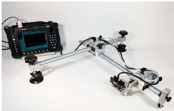
Slika 20: PA uređaj za ispitivanje kompozita [5]
