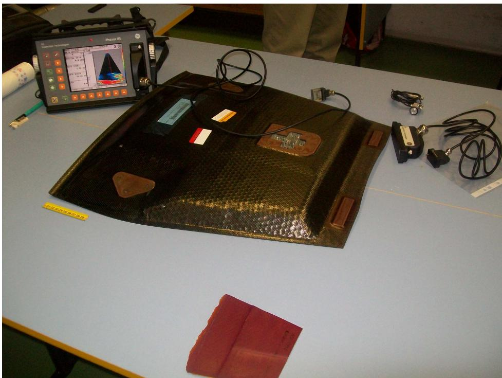
Slika 38: PA oprema i ispitivani uzorci od kompozita
