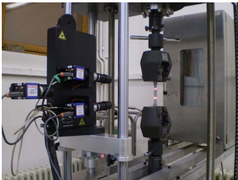
Slika 2.5 Eksperimentalno određivanje svojstava vlaknima ojačanih kompozita, LEM
