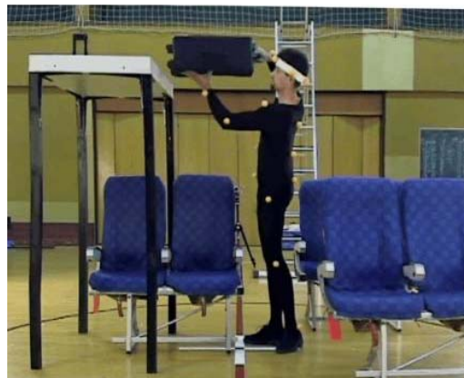
Sl. 89. Kinematogram slijeđenja ispitanika mocap sustavom VatoSABA 2.1.
