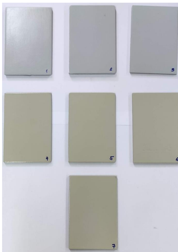
Slika 5.22. Atmosferski sušeni uzorci prije početka testiranja
