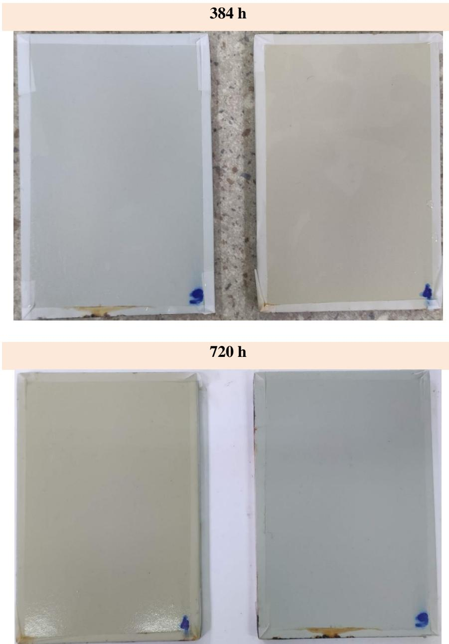
**Slika 5.39. Uzorci nakon 384 i 720 h provedenih u vlažnoj komori**
