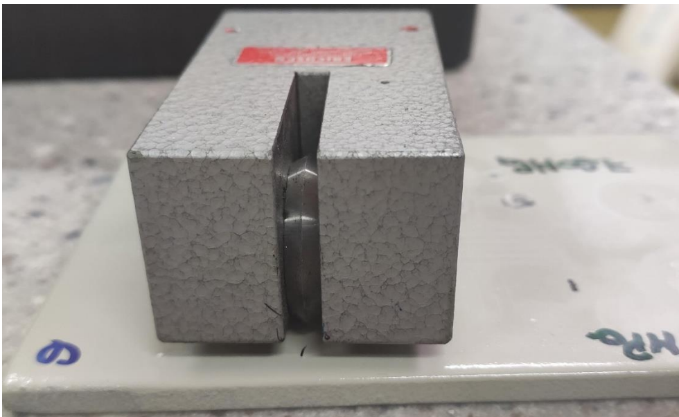
Slika 5.36. Postavljanje utega na uzorak
