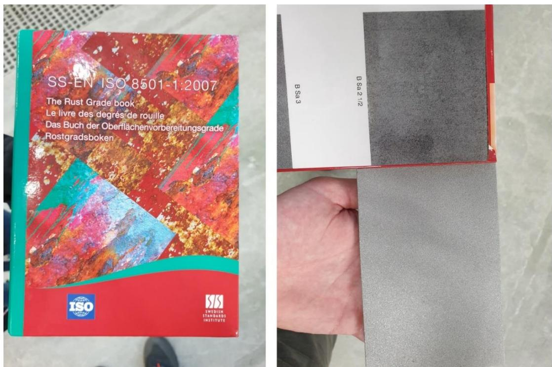
Slika 5.2. Određivanje razreda čistoće površine prema normi ISO 8501-1
