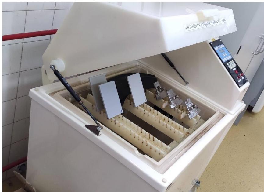
**Slika 5.38. Vlažna komora, Laboratorij za zaštitu materijala, FSB**
