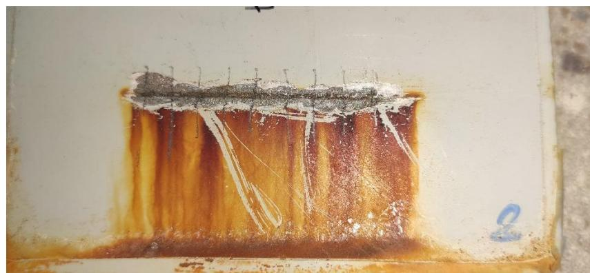
**Slika 5.48. Urez pripremljen za mjerjenje zone korozije na uzorku broj 2**
