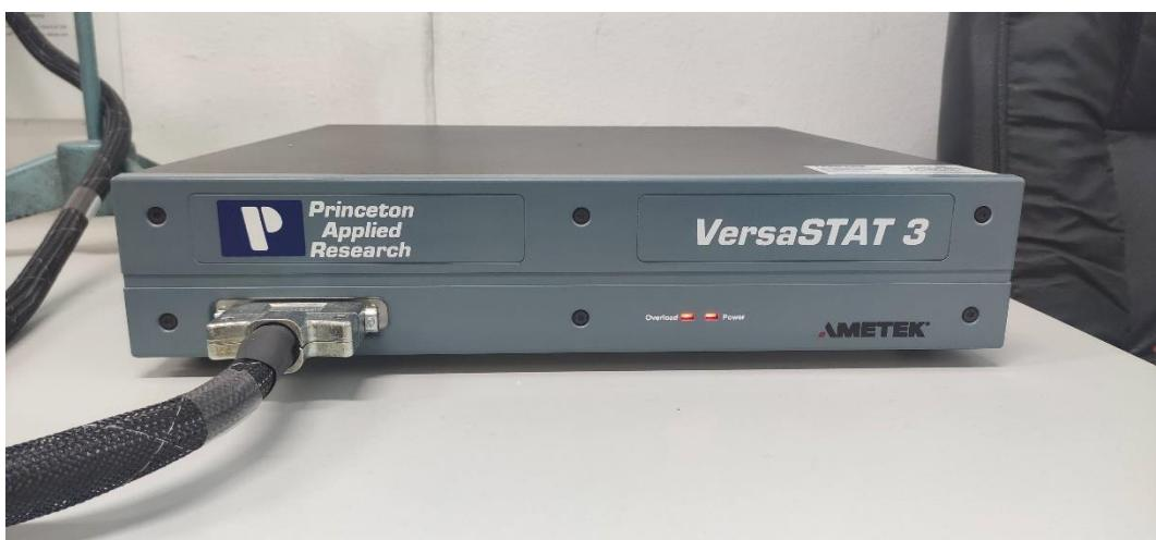
**Slika 5.29.** Uredaj za provođenje EIS ispitivanja, VersaSTAT 3, Laboratorij za zaštitu materijala, FSB
