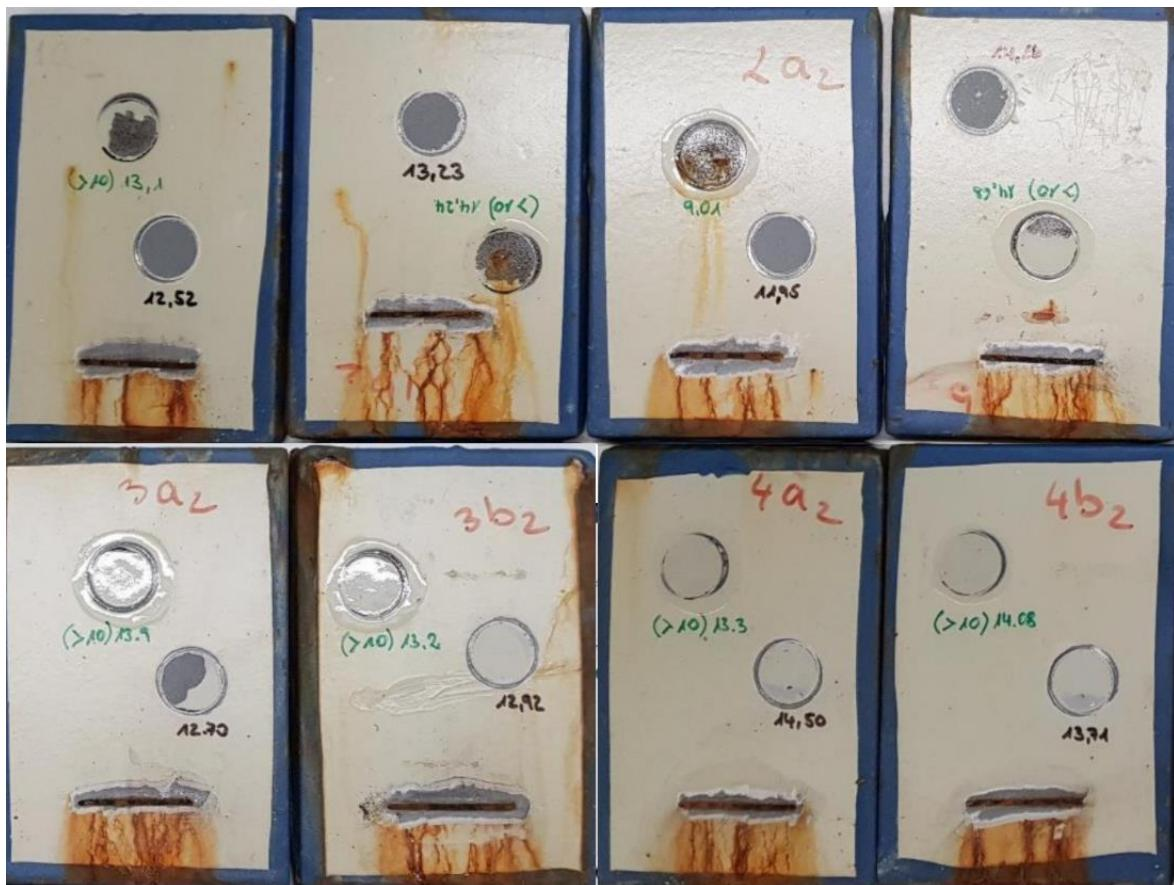
**Slika 5.21. Rezultati *Pull off* testiranja nakon slane komore na uzorcima iz Končar-MK**
