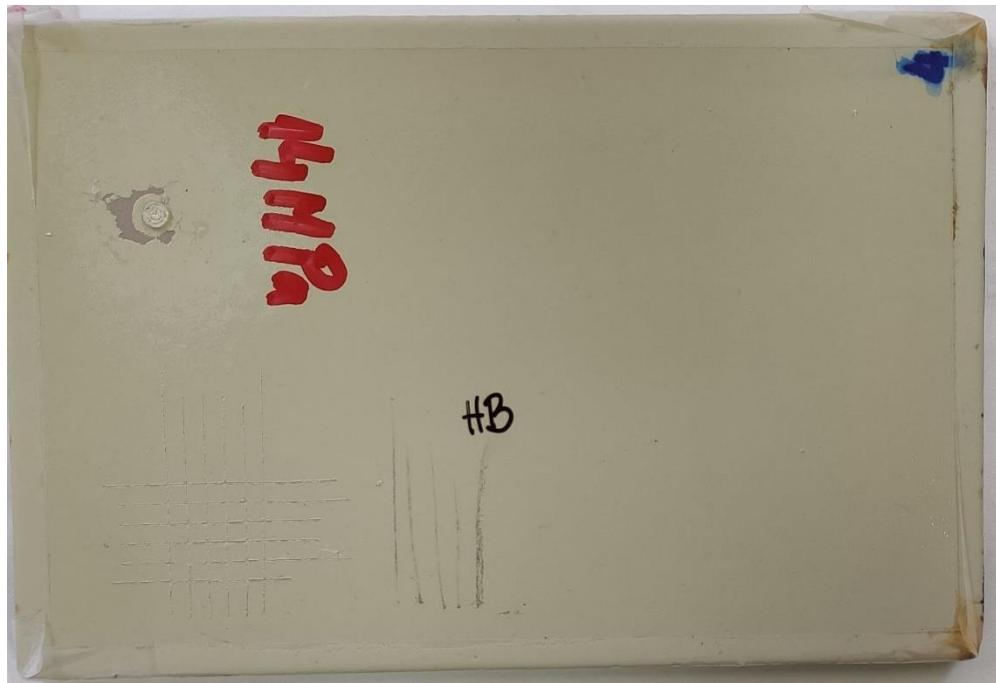
**Slika 5.44. Rezultat mjerenja tvrdoće premaza olovkama na uzorku broj 4**
