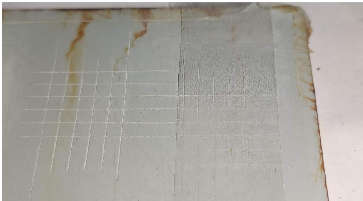
Slika 5.49. Rezultat *Cross cut* ispitivanja na uzorku broj 2
