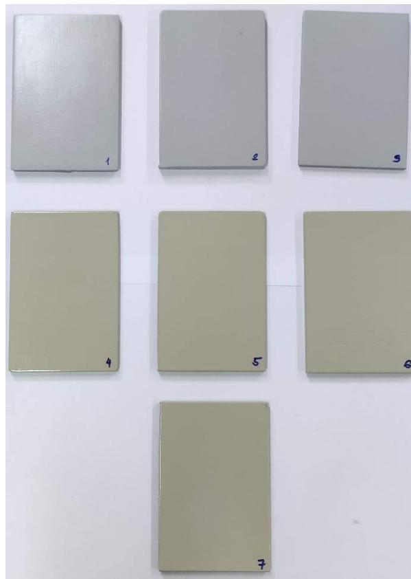
Slika 5.22. Atmosferski sušeni uzorci prije početka testiranja
