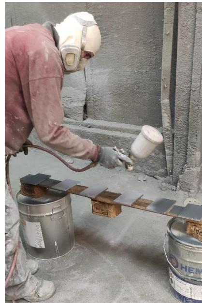
**Slika 5.8. Nanošenje boje zračnim pištoljem**
