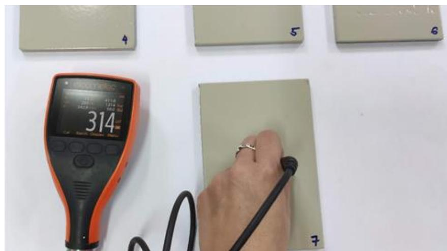
Slika 5.23. Mjerenje DSF-a uređajem Elcometer 456
