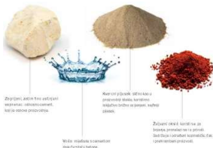
Slika 7. Sirovine za proizvodnju betonskog crijepa [5]
