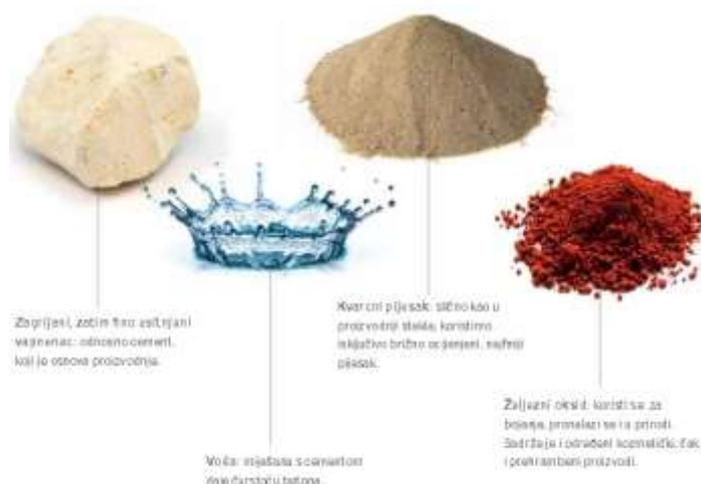
**Slika 7. Sirovine za proizvodnju betonskog crijepa [5]**
