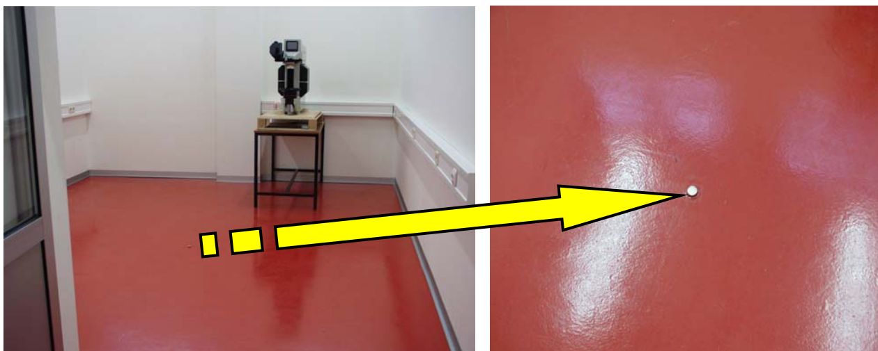
Slika 5.4: Točka gravimetrijskih i nivelmanskih mjerenja u LIMS-u
