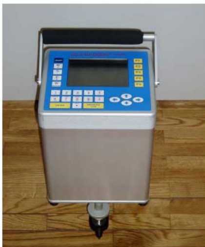
Slika 5.2: Relativni gravimetar Scintrex CG-5 a) prikaz cijelog uređaja b) prikaz ekrana CG-5 gravimetra
