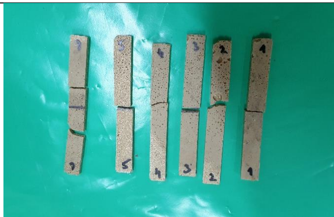
Slika 6.43. Ispitna tijela od PLA i 40 % ljuški jaja nakon ispitivanja žilavosti
