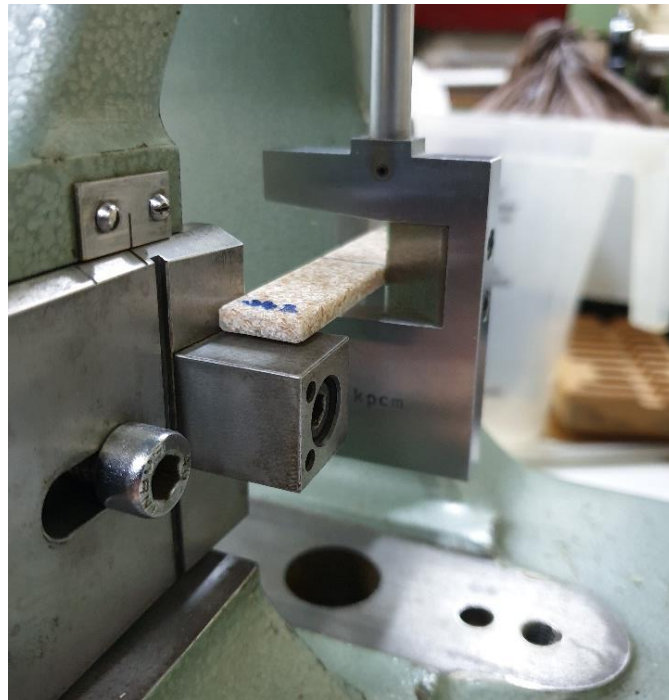
Slika 6.18. Ispitivanje žilavosti na ispitnom tijelu J40-2
