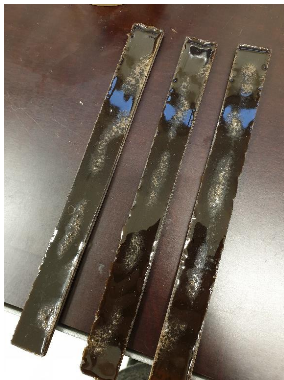
Slika 6.15. Umrežen kompozit izvađen iz kalupa
