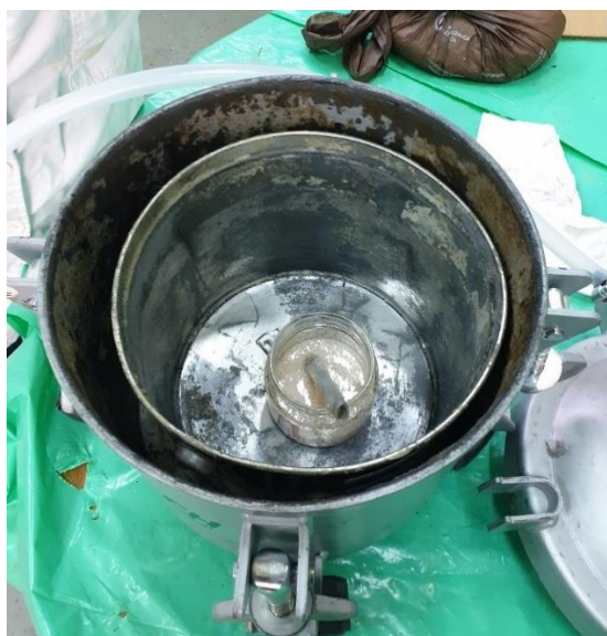
Slika 6.7. Izvlačenje zraka iz smjese u potlačnoj komori
