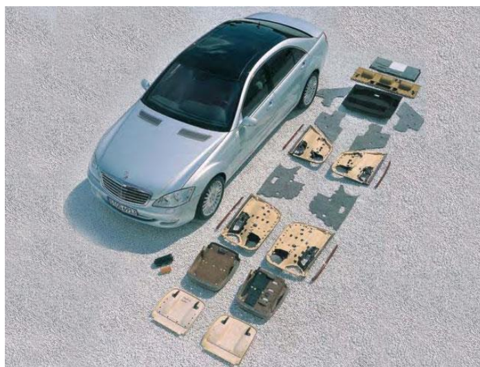
Slika 4.7. Dijelovi automobila napravljeni od prirodnih kompozita [33]
