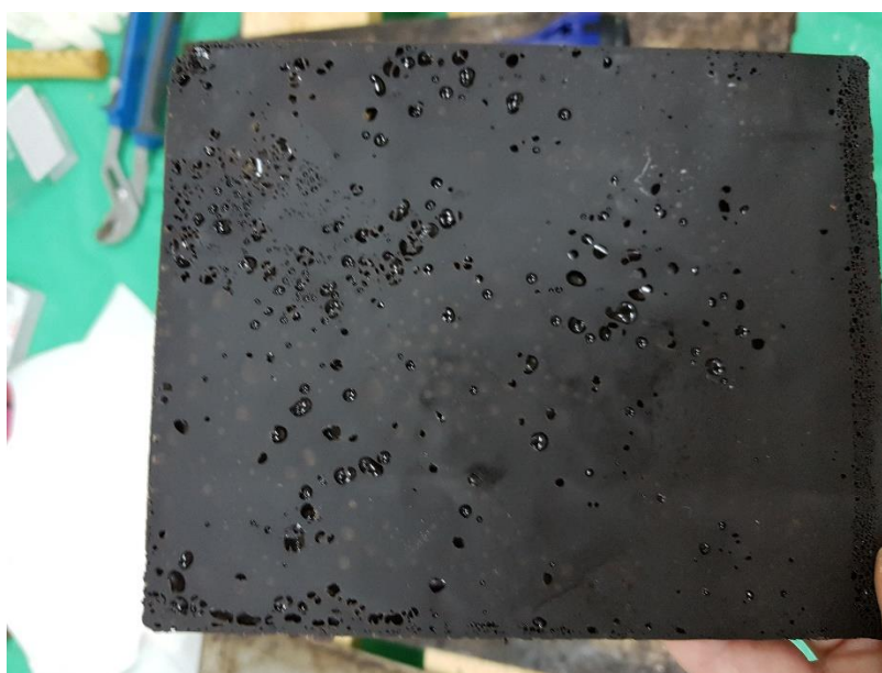
Slika 6.42. Vidljivi ostaci zraka u kompozitu s 40 % ljsaka lješnjaka
