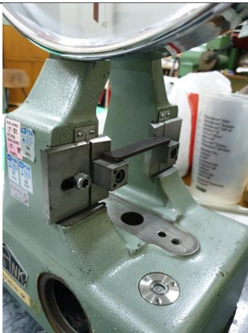
Slika 6.19. Ispitno tijelo LJ20-2 prije i nakon ispitivanja žilavosti
