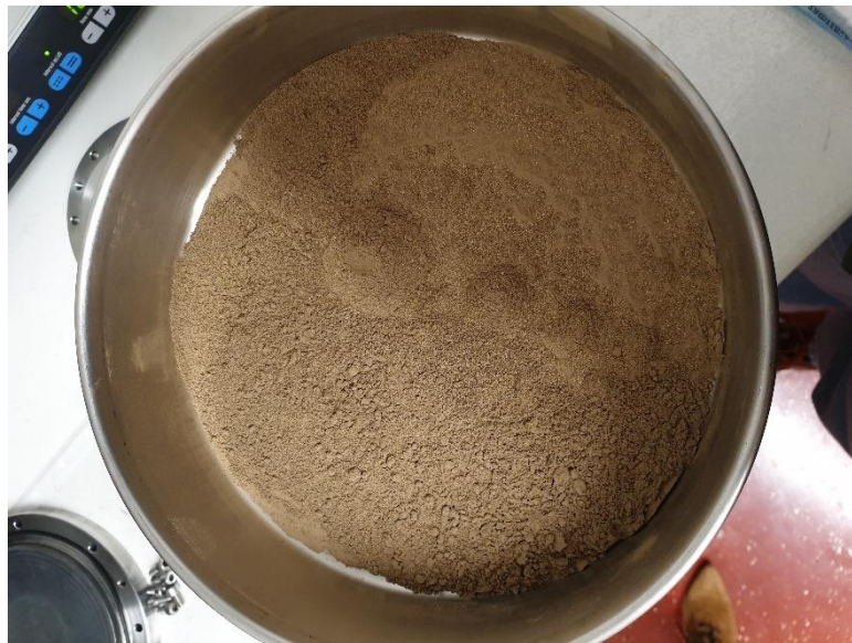
Slika 6.2. Prosijane ljuske lješnjaka, čestice veličine < 300 \mu\text{m}
