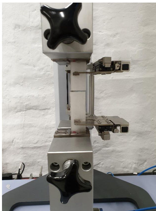
Slika 6.23. Ispitno tijelo E-1 nakon ispitivanja rasteznih svojstava
