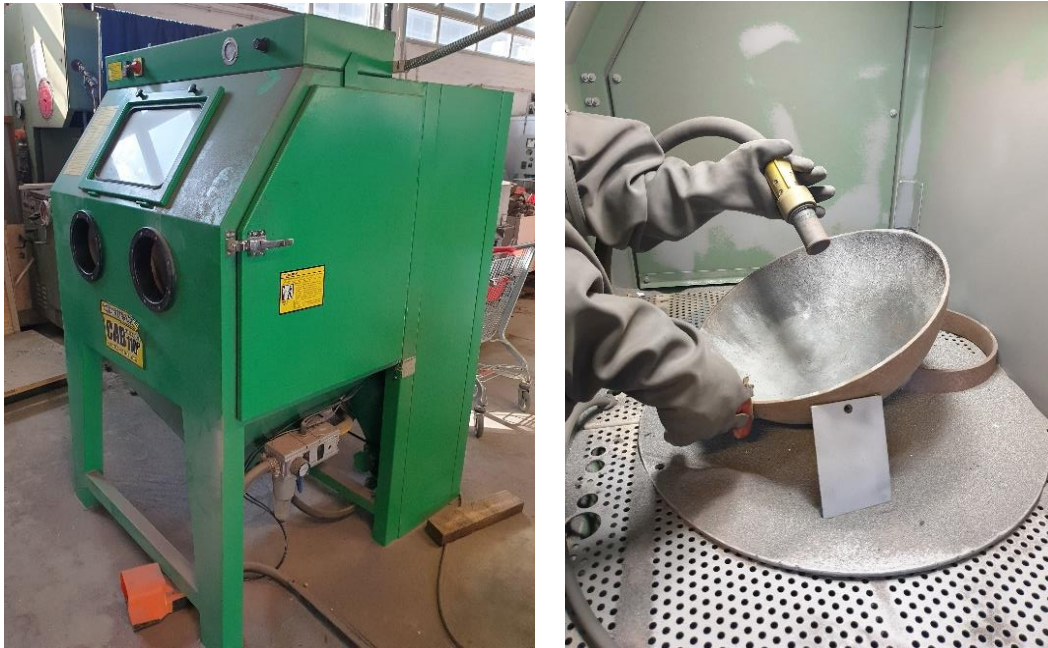
Slika 7.1. Komora za pjeskarenje (lijevo) i postupak pjeskarenja (desno)
