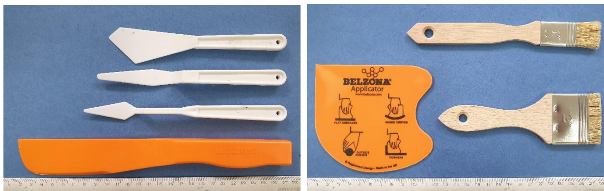
Slika 7.10. Pribor za miješanje i nanošenje premaza: a) plastične špatule i nož, b) aplikator i kistovi
