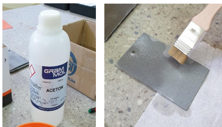
Slika 7.4. Odmašćivanje površine uzoraka acetonom
