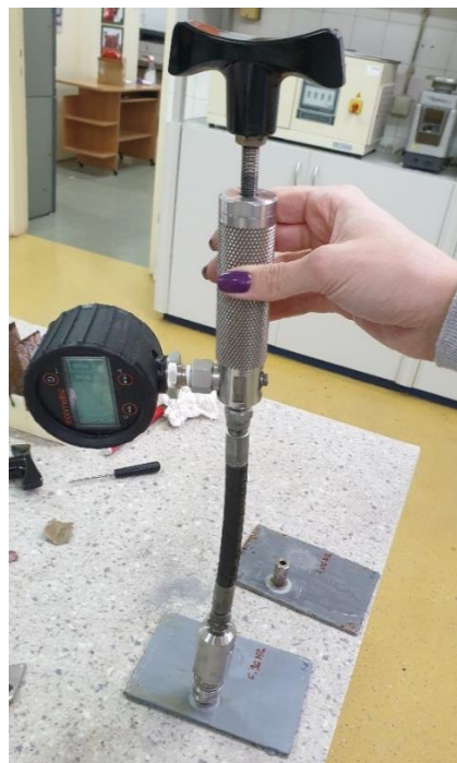
Slika 7.48 Ispitivanje prionjivosti premaza Pull – off metodom
