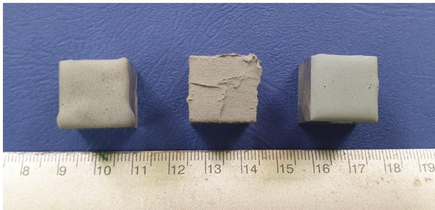
Slika 7.33. Uzorci nakon ispitivanja otpornosti na erozijsko trošenje premaza
