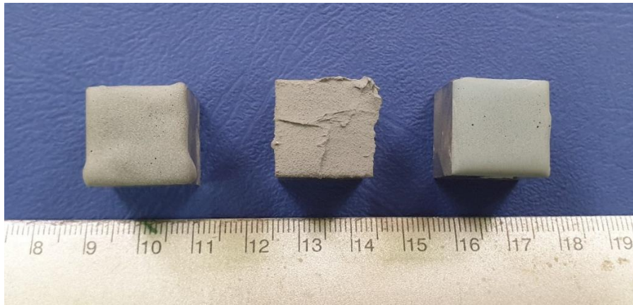
Slika 7.33. Uzorci nakon ispitivanja otpornosti na erozijsko trošenje premaza
