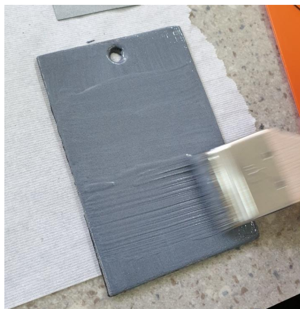
Slika 7.13. Nanošenje Belzona 1321 premaza na ispitni uzorak
