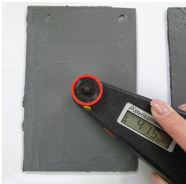
Slika 7.23. Mjerenje debljine filma premaza pomoću uređaja QuaNix 1500
