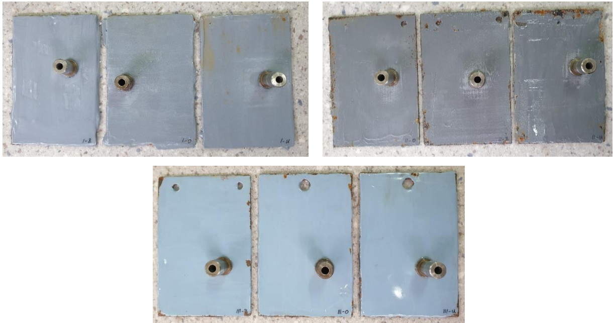
Slika 7.47. Uzorci pripremljeni za Pull – off ispitivanje
