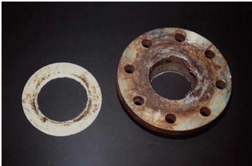
Slika 2.3. Korozijska u procijepu (ispod brtve) na prirubnici od nehrđajućeg čelika koja je izložena mediju bogatom kloridom [5]
