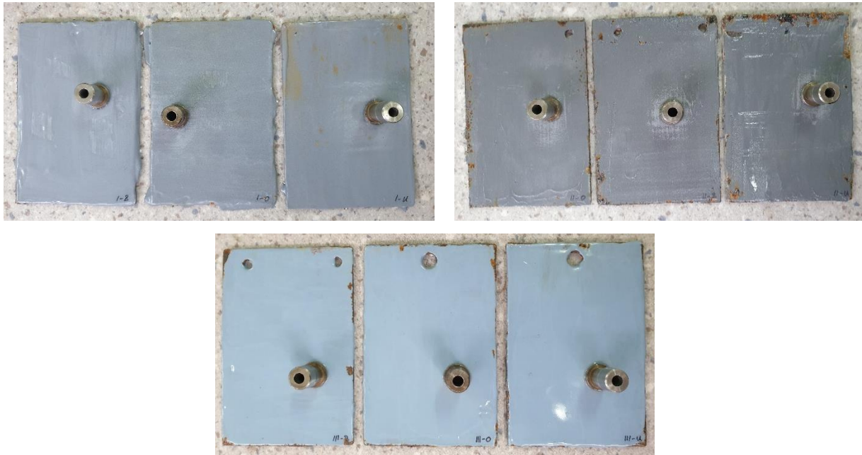
Slika 7.47. Uzorci pripremljeni za Pull – off ispitivanje
