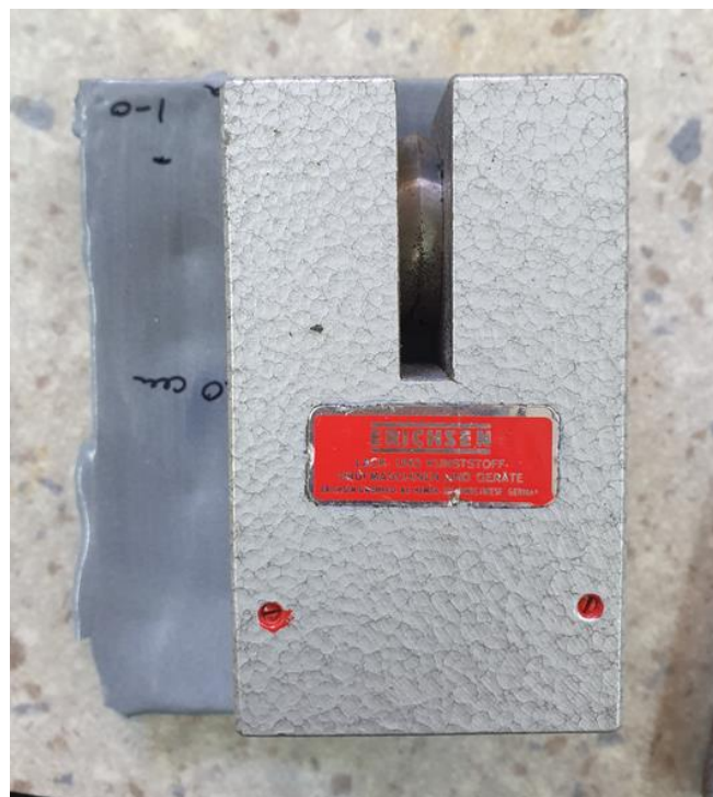
Slika 7.38. Ispitivanje tvrdoće prema Buchholzovom modelu 263
