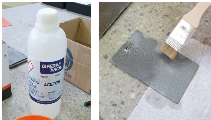
Slika 7.4. Odmašćivanje površine uzoraka acetonom
