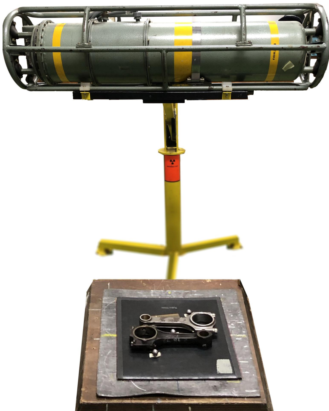
Slika 17. Postupak prozračivanja RTG uređajem
