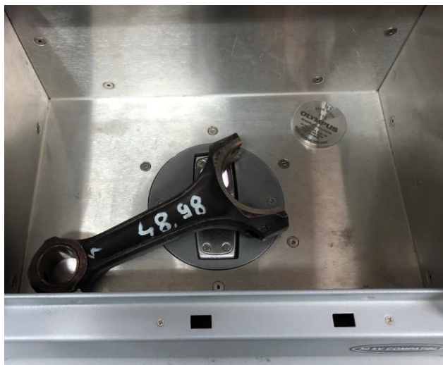
Slika 16. Postupak snimanja klipnjače XRF analizatorom
