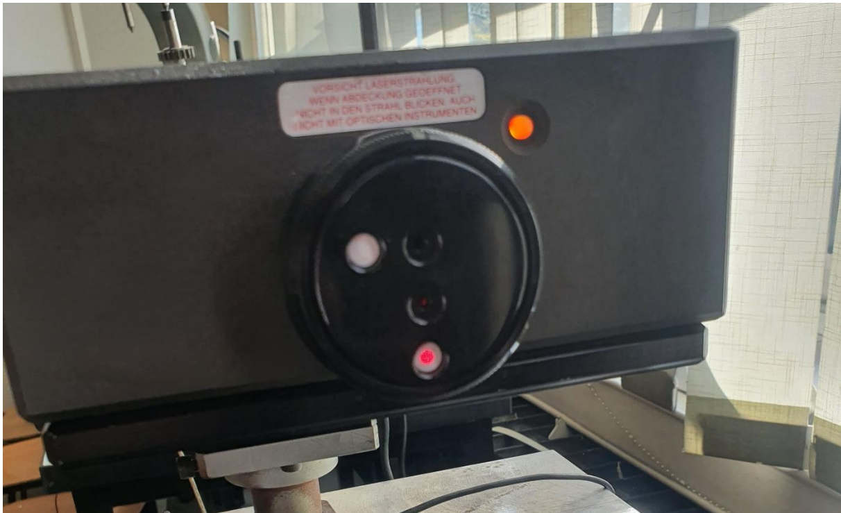
Slika 30 Prikaz dobro poravnatog retroreflektora na piezu
