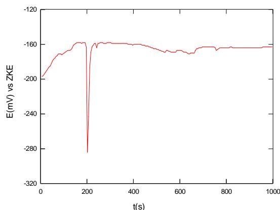
Slika 41. Određivanje potencijala otvorenog strujnog kruga za 10. uzorak
