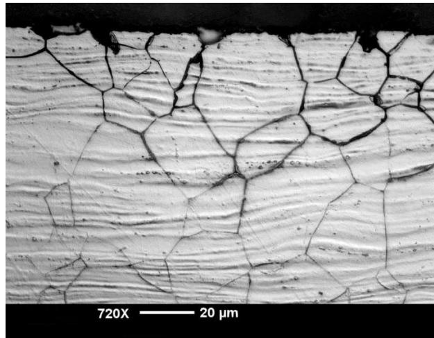
Slika 13. Primjer interkristalne korozije kod austenitnog nehrđajućeg čelika [15]
