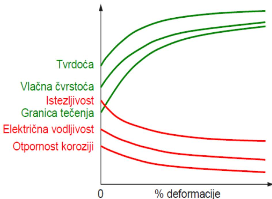
Slika 17. Promjene mehaničkih karakteristika materijala uslijed plastične deformacije [1]
