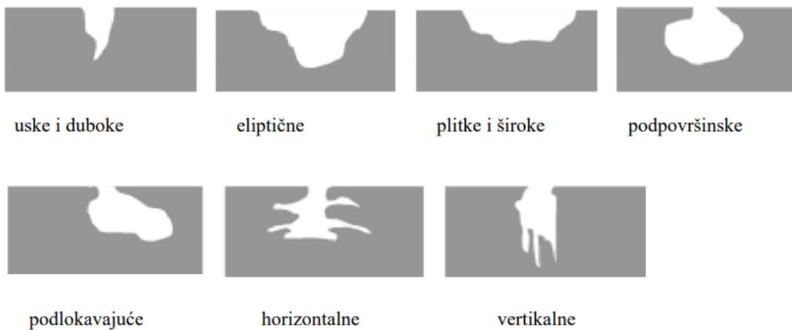
Slika 12. Oblici rupica nastalih rupičastom korozijom [14]
