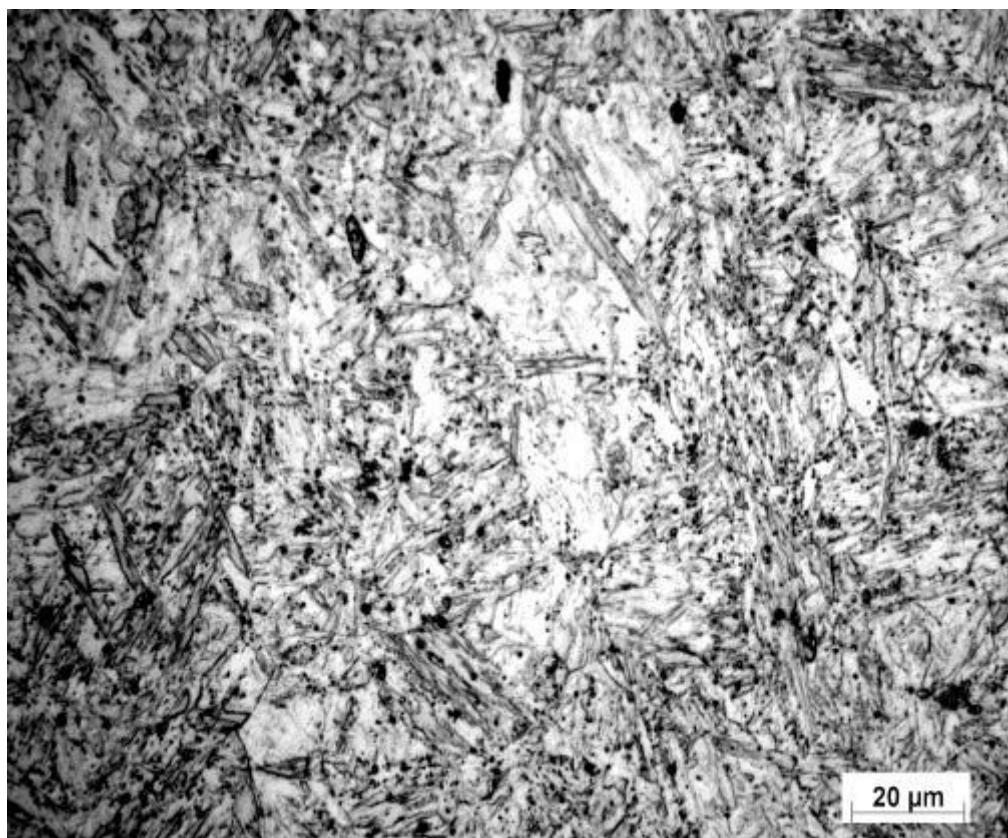
Slika 9. Mikrostruktura precipitacijski očvrsnutog nehrđajućeg čelika [13]
