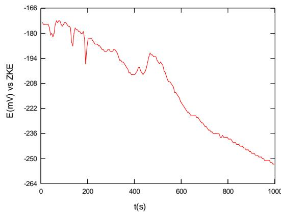
Slika 42. Određivanje potencijala otvorenog strujnog kruga za 11. uzorak
