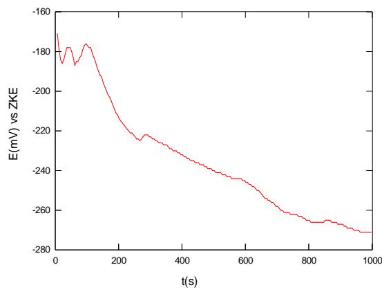
Slika 34. Određivanje potencijala otvorenog strujnog kruga za 3. uzorak
