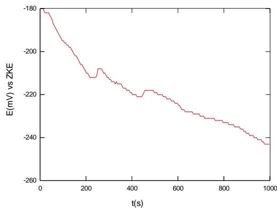
Slika 37. Određivanje potencijala otvorenog strujnog kruga za 6. uzorak
