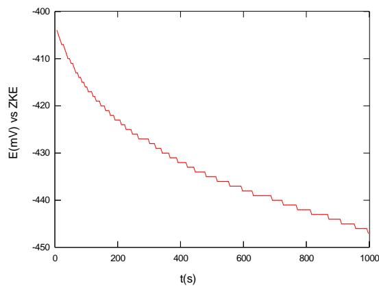
Slika 38. Određivanje potencijala otvorenog strujnog kruga za 7. uzorak
