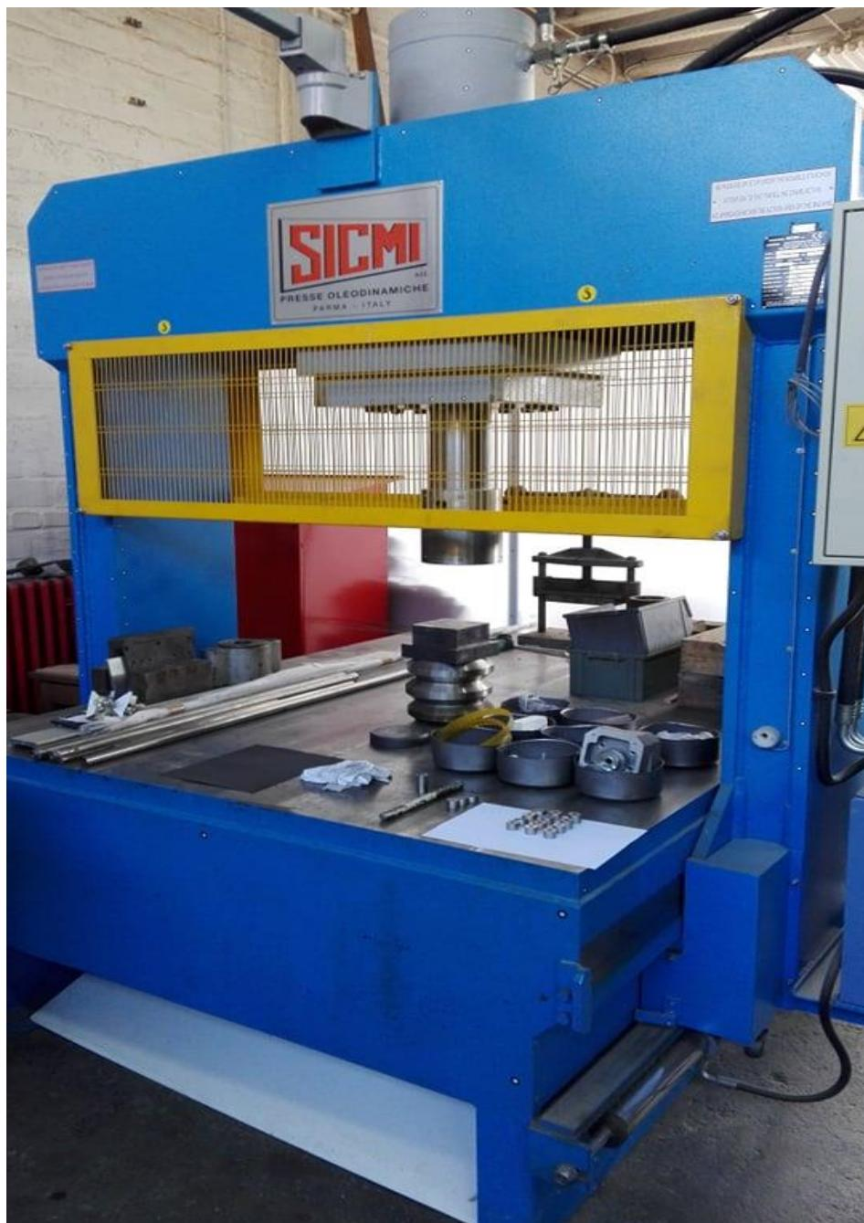
Slika 26. Hidraulična preša SICMI PMM 150 MC, Laboratorij za oblikovanje deformiranjem
