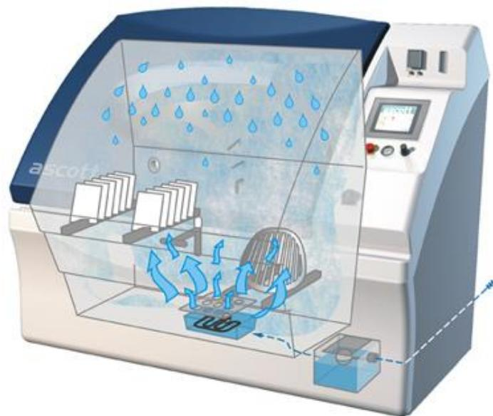
Slika 19. Uređaj za provođenje testa visoke vlažnosti [21]
