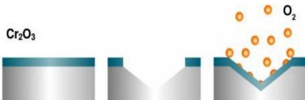
Slika 10. Prikaz procesa samoobnavljanja pasivnog sloja nehrđajućeg čelika [14]
