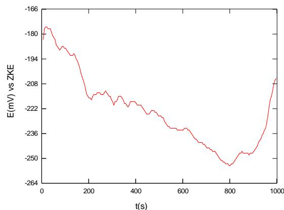
Slika 32. Određivanje potencijala otvorenog strujnog kruga za 1. uzorak
