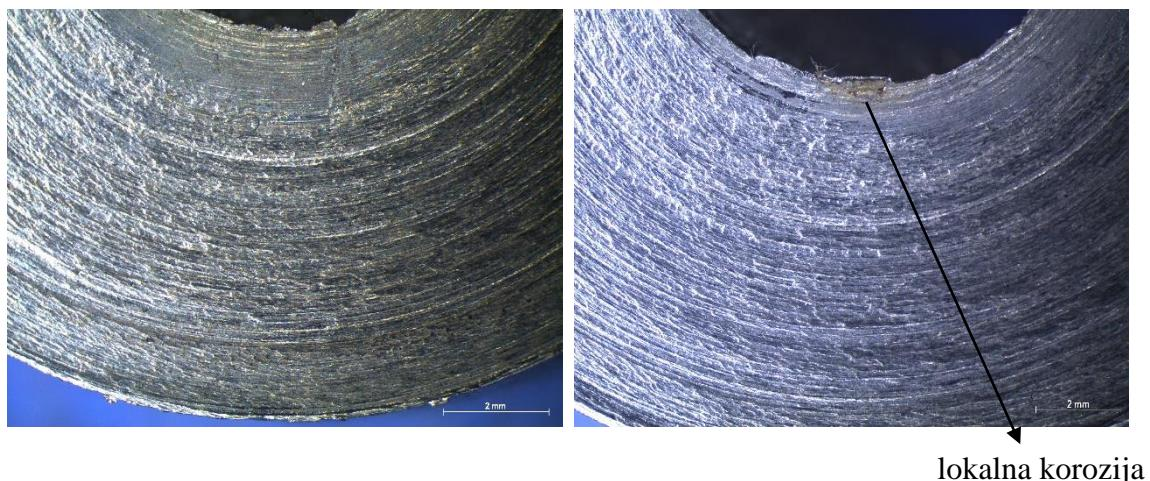
Slika 71. 7. uzorak prije (lijevo) i poslije (desno) provedenih ispitivanja
