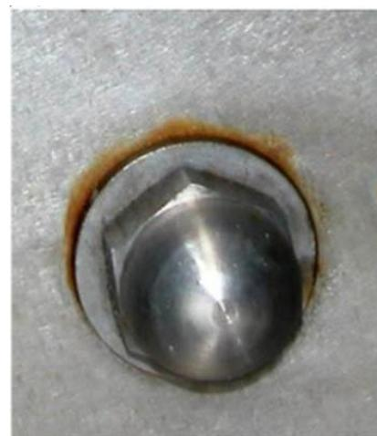
Slika 15. Primjer korozije u procjepu [16]
