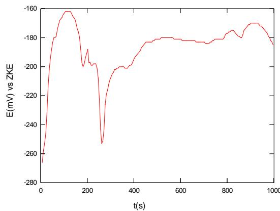
Slika 43. Određivanje potencijala otvorenog strujnog kruga za 12. uzorak
