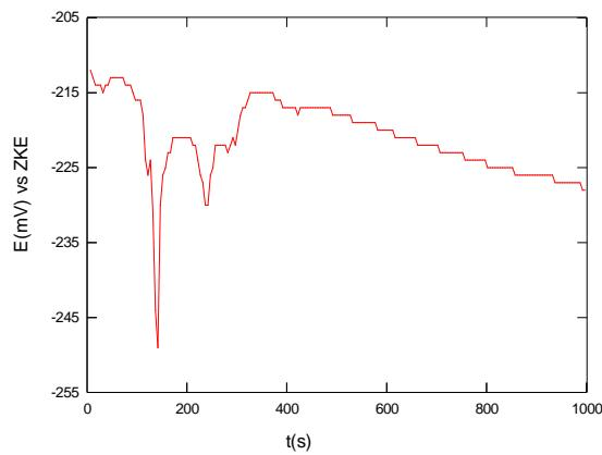
Slika 36. Određivanje potencijala otvorenog strujnog kruga za 5. uzorak
