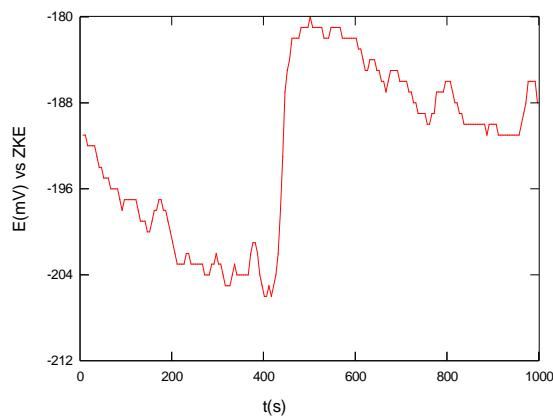
Slika 35. Određivanje potencijala otvorenog strujnog kruga za 4. uzorak
