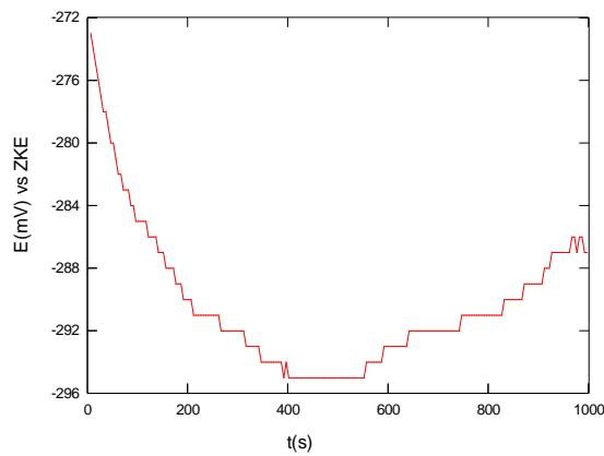
Slika 33. Određivanje potencijala otvorenog strujnog kruga za 2. uzorak
