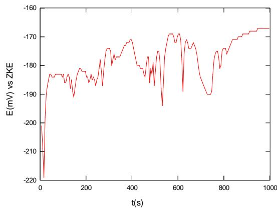
Slika 39. Određivanje potencijala otvorenog strujnog kruga za 8. uzorak
