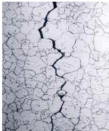
Slika 14. Napetosna korozija [15]
