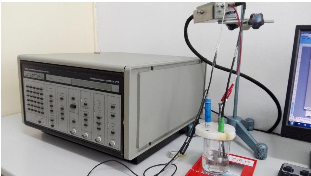
Slika 30. Potenciostat EG&G Princeton Applied Research Model 273A, Laboratorij za zaštitu materijala
