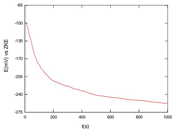
Slika 40. Određivanje potencijala otvorenog strujnog kruga za 9. uzorak
