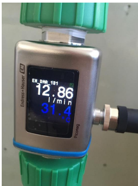
Slika 9. Elektromagnetski protokomjer Endress Hauser
