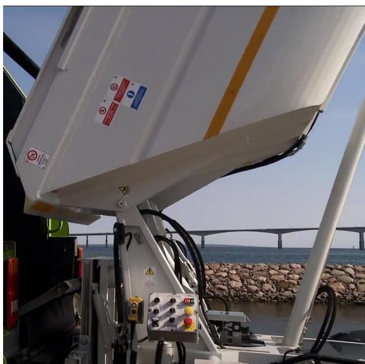
Slika 80. Koncept 1 sustava za samoistovarivanje sanduka – prihvat cilindra na stražnji dio vozila i prihvat sanduka [36]
