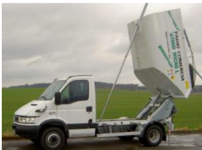
Slika 81. Koncept 2 sustava za samoistovarivanje sanduka [34]
