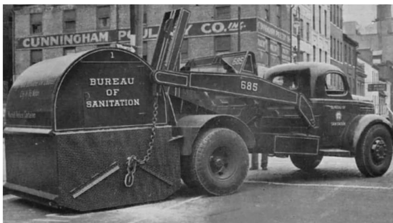
Slika 7. Dempster – Dumpster kamion za odvoz otpada [7]
