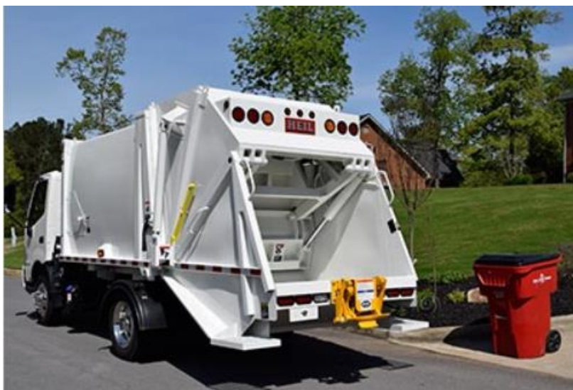
Slika 11. Heil kamion sa stražnjim utovarivanjem [13]
