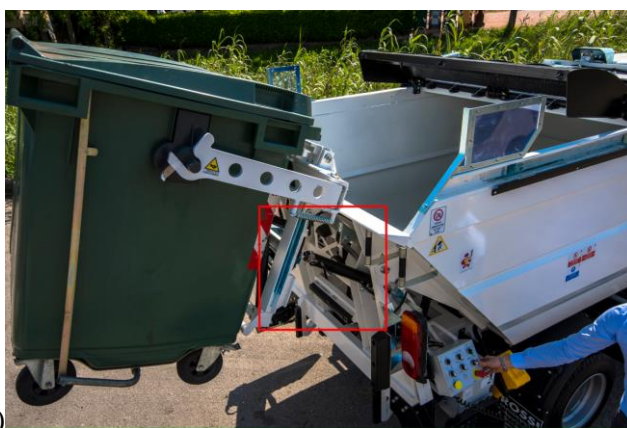
Slika 36. Izvedbe mehanizama za dizanje: a) s jednim cilindrom [33] i b) s četiri cilindra [36]
