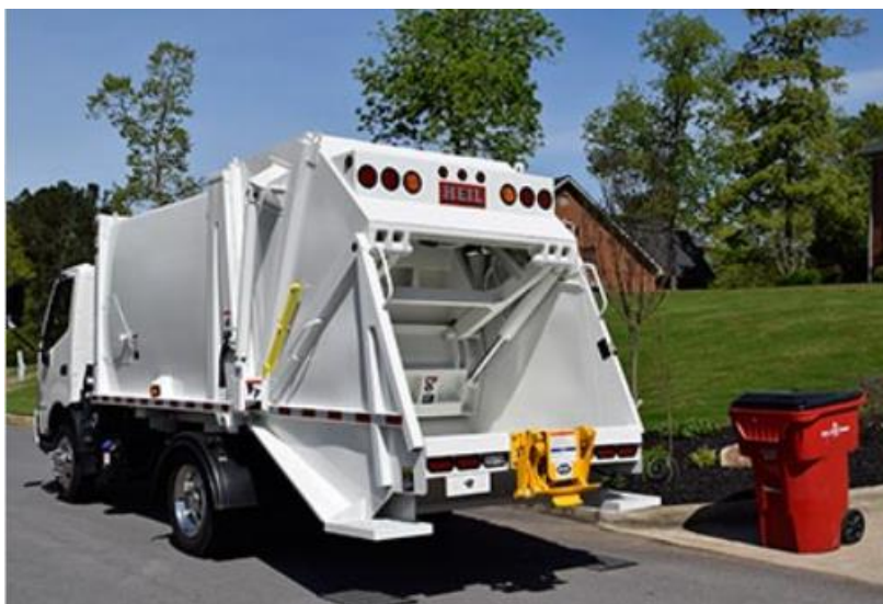
Slika 11. Heil kamion sa stražnjim utovarivanjem [13]
