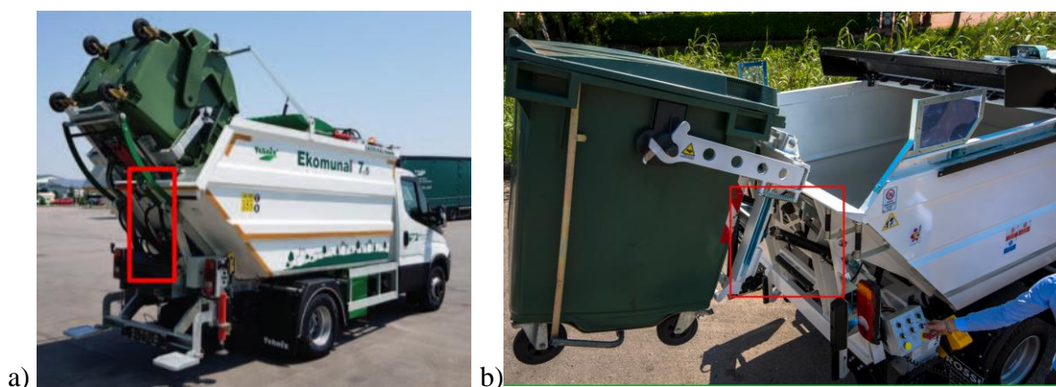
Slika 36. Izvedbe mehanizama za dizanje: a) s jednim cilindrom [33] i b) s četiri cilindra [36]
