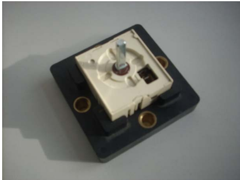
Slika 2.4 Regulator energije na nosaču proizvoda
