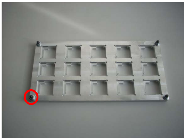
Slika 3.5 Spremnik proizvoda s ugrađenim vijcima
