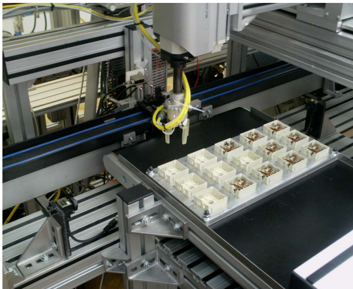
Slika 4.2 Pozicija na kojoj manipulator čeka paletu
