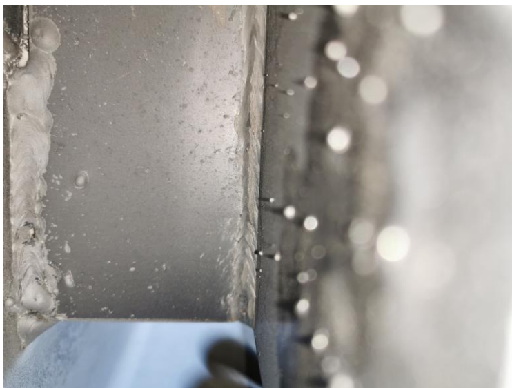
Slika 12. Neočišćena površina od prskotina
