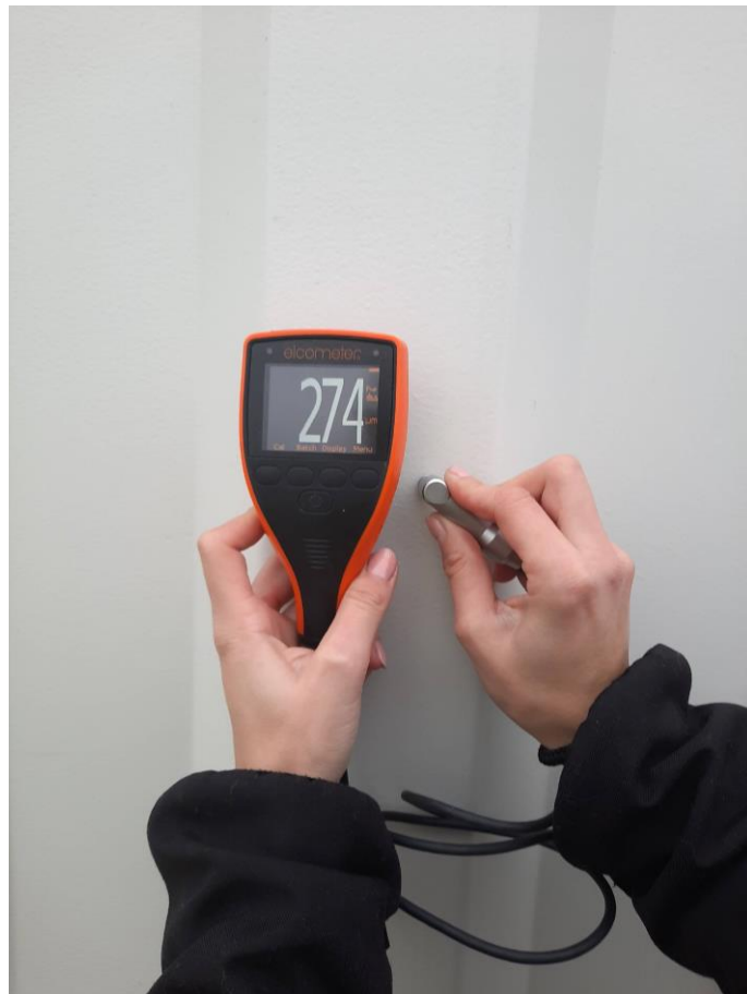
Slika 18. Mjerenje debljine boje
