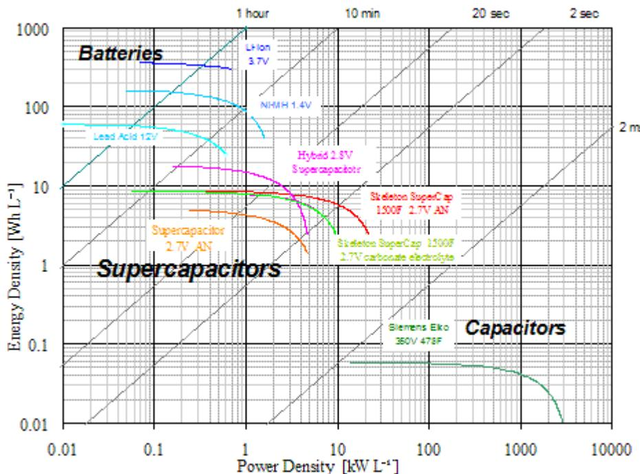
**Slika 4.5.** Usporedba različitih tipova ultrakondenzatora, kondenzatora i baterija
