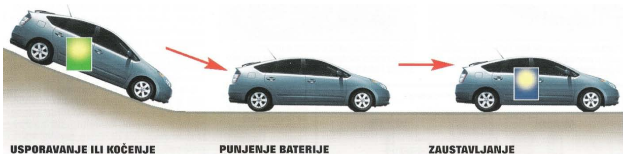
Slika 2.13. HSD-sustav (usporavanje - zaustavljanje)
