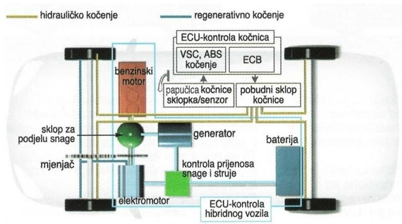
**Slika 2.23.** Sustav pri regenerativnom i hidrauličkom kočenju
