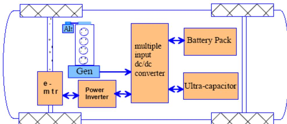
**Slika 4.8.** Upotreba ultrakondenzatora i baterija u hibridnim vozilima
