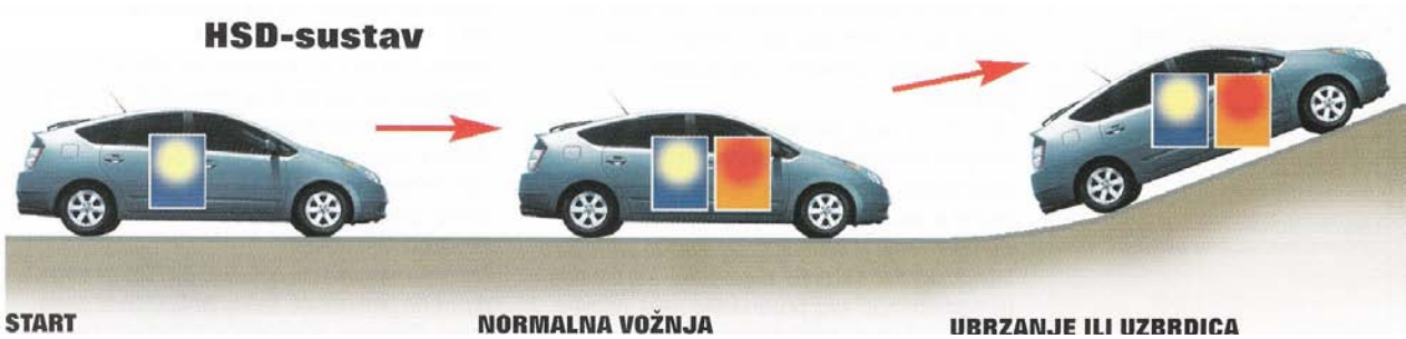
Slika 2.9. HSD-sustav (start - uzbrdica)
