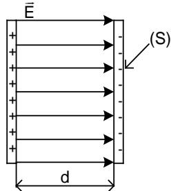
**Slika 4.3.** Prikaz površine i razmaka između ploča kondenzatora
