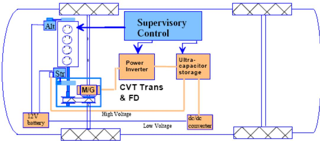
**Slika 4.7.** Upotreba ultrakondenzatora u hibridnim vozilima
