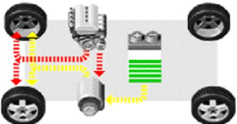
**Slika 2.12.** HSD-sustav: prikaz rada kod ubrzanja (uzbrdice)
