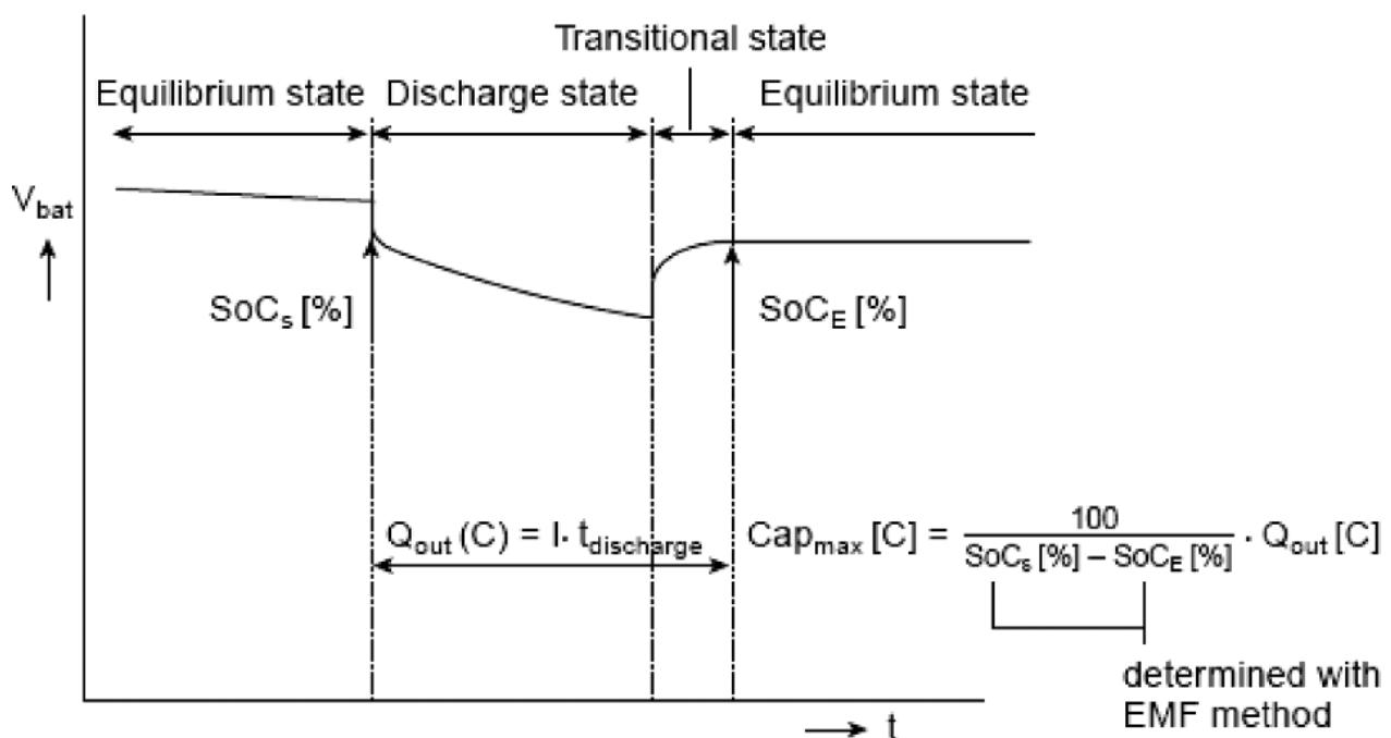
**Slika 6.10.** Određivanje maksimalnog kapaciteta  $\text{Cap}_{\max}$
