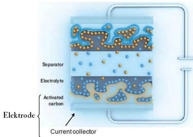
**Slika 4.2.** Ultrakondenzator
