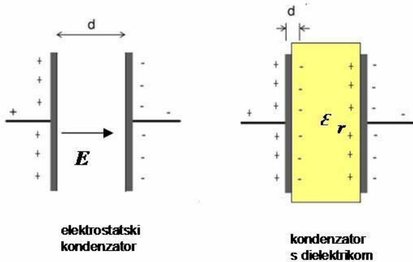
**Slika 4.1.** Prikaz elektrostatskog kondenzatora i kondenzatora s dielektrikom
