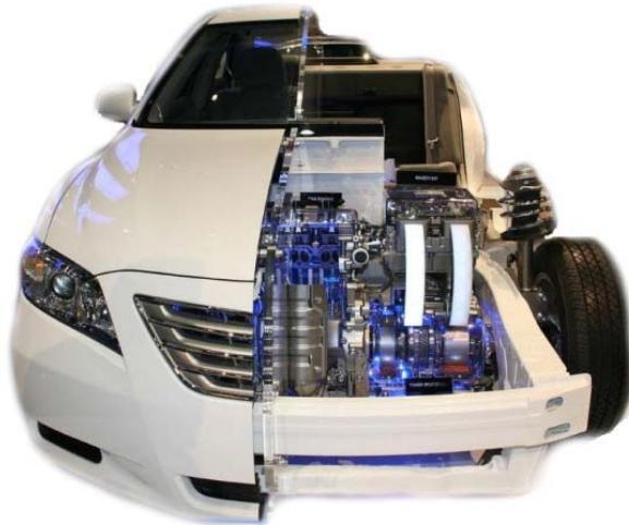
**Slika 2.1.** Hibridno vozilo - presjek
