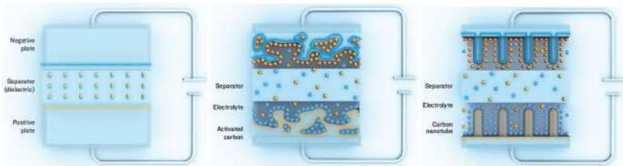
**Slika 4.6.** Razlika između klasičnog tipa pločastog kondenzatora i ultrakondenzatora
