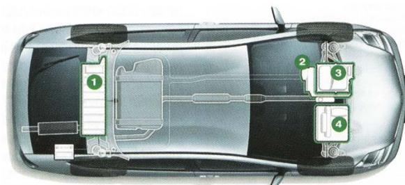
**Slika 2.18.** Prikaz vrhunskih komponenti Hybrid Synergy Drive-a
