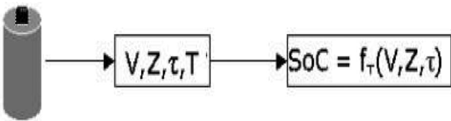
**Slika 6.2.** Osnovni princip SOC na temelju izravnog mjerena
