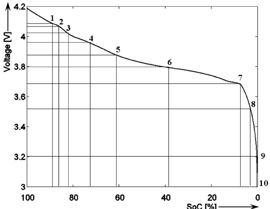
**Slika 6.5.** EMS po dijelovima krivulje za Li-ion bateriju
