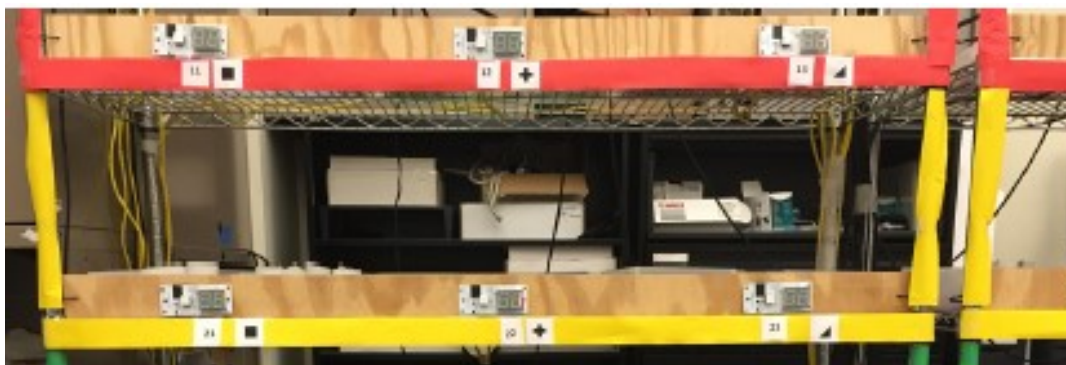
Slika 37. Sustav svjetlom usmjerenog komisioniranja s tipkom za potvrdu [23]
