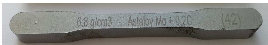
Slika 16. Uzorak epruvete Astaloy Mo+0,2C ( \rho = 6,8 \text{ g/cm}^3 )
