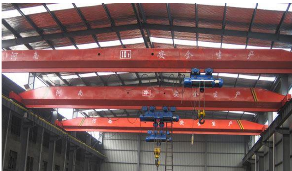
Slika 8. Mosni granik proizvođača Dowell Crane [10]
