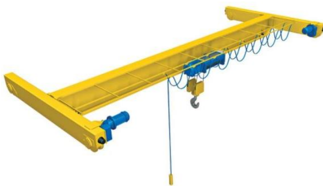
Slika 2. Mosni granik s jednim glavnim nosačem [5]
