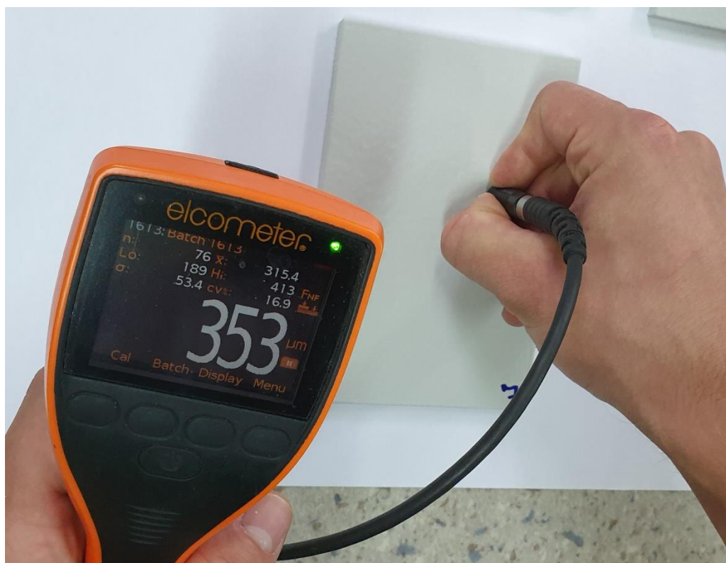
Slika 38. Mjerenje debljine suhog filma (DSF) premaza uređajem Elcometer 456
