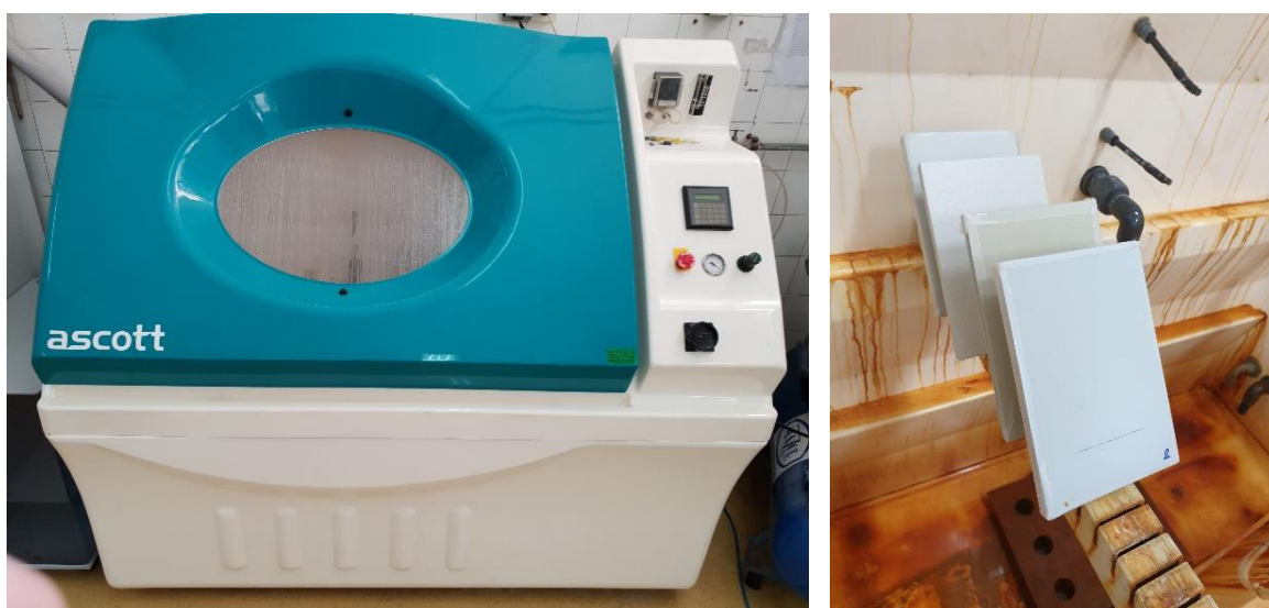
Slika 45. Slana komora u Laboratoriju za zaštitu materijala i ispitni uzorci u njoj
