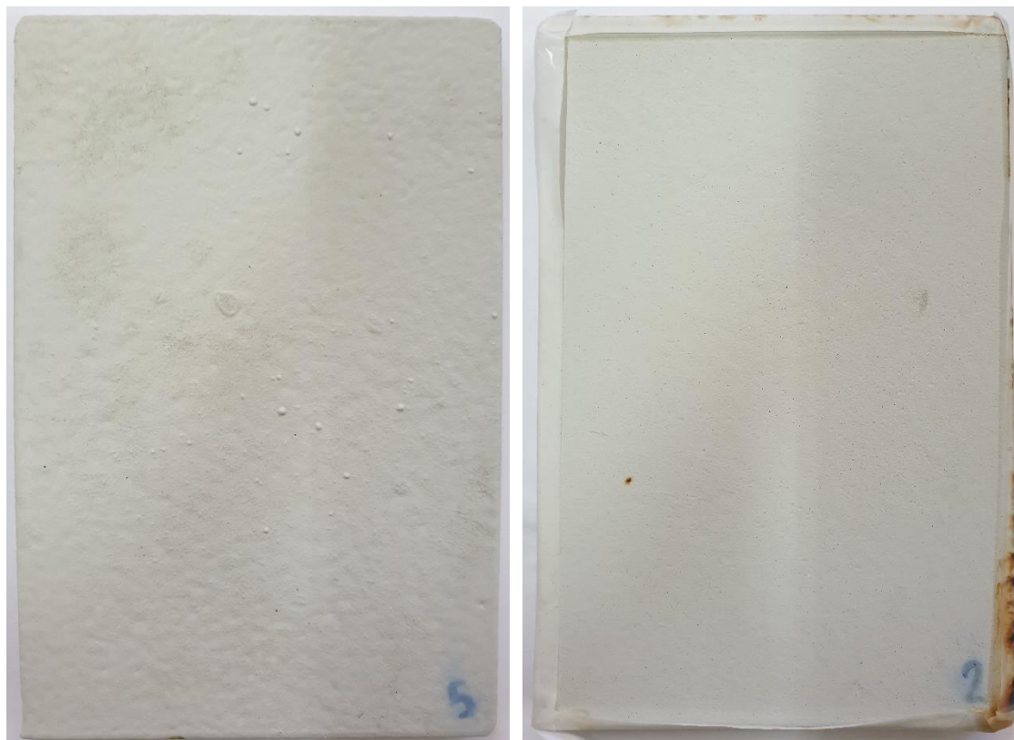
Slika 44. Ispitni uzorci nakon provedenih 30 dana u vlažnoj komori
