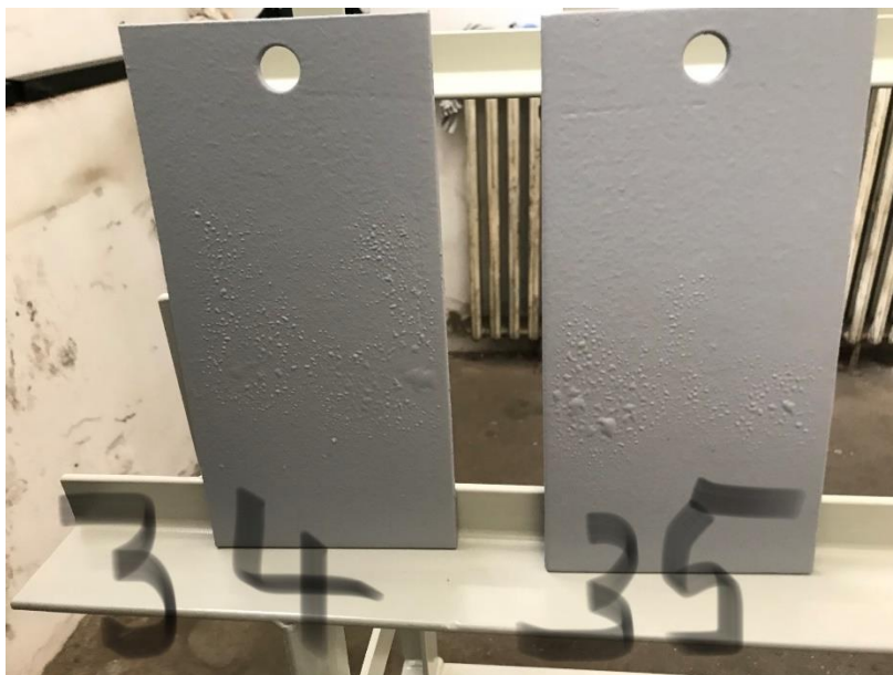
Slika 36. Pojava mjehurića nakon IC sušenja vodorazrjedivih premaza uslijed nedovoljnog „flash-offa“ odnosno sušenja na zraku prije korištenja IC lampe
