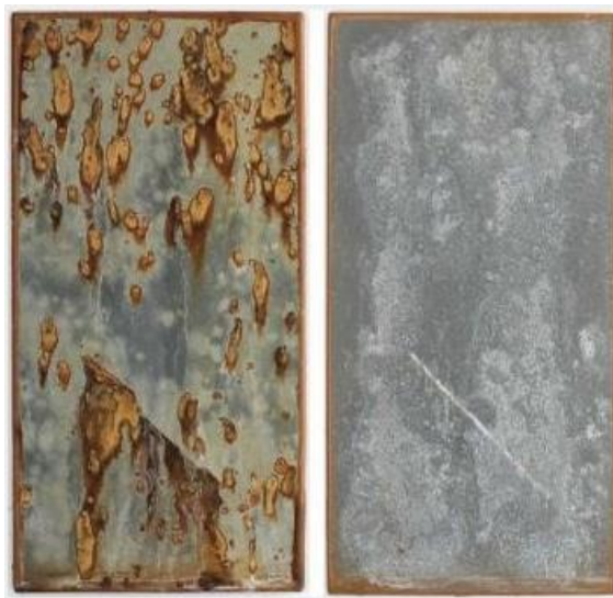
Slika 10. Standardni (lijevo) i aktivirani (desno) cink-epoksi temeljni premaz nakon 1259 sati ispitivanja u slanoj komori prema normi ISO 9227 [7]
