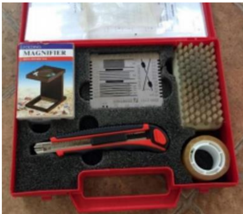
Slika 48. Set za ispitivanje prionjivosti urezivanjem mrežice
