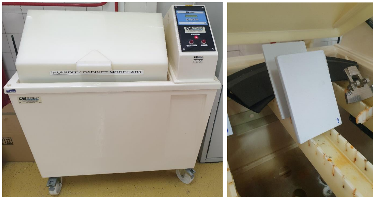
Slika 43. Vlažna komora u Laboratoriju za zaštitu materijala i ispitni uzorci u njoj
