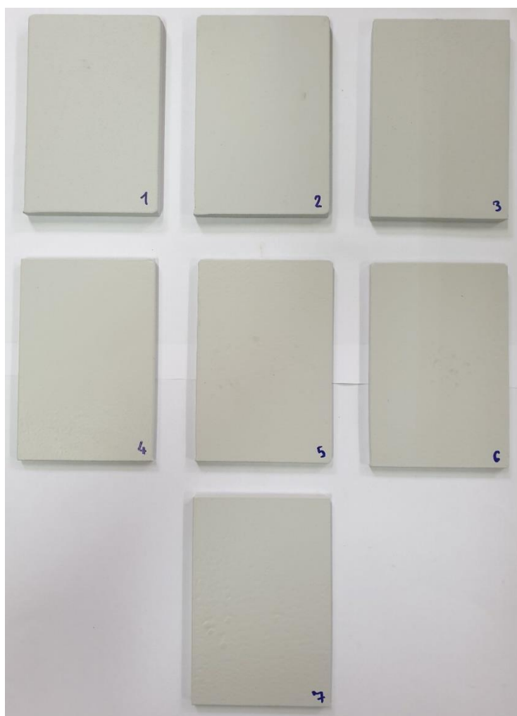
Slika 42. Ispitni uzorci nakon 21 dan sušenja na sobnoj temperaturi za ispitivanja u laboratoriju
