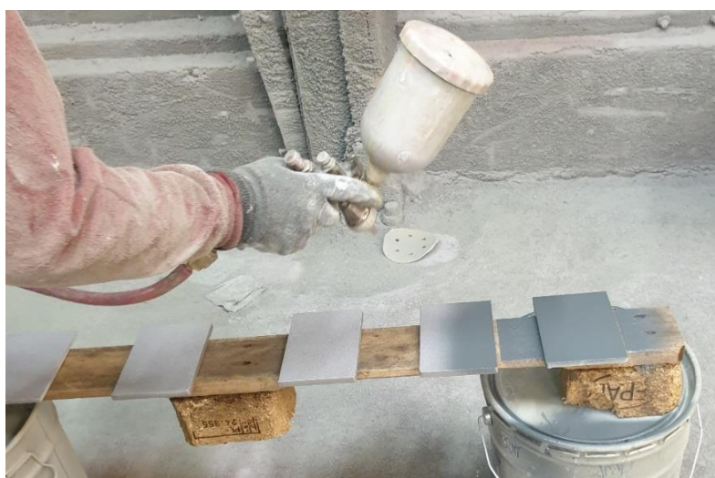
Slika 34. Nanošenje premaza na uzorke zračnim prskanjem
