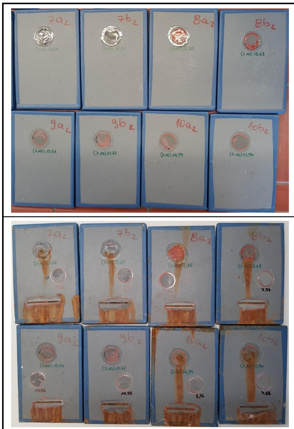
Slika 41. IC sušeni ispitni uzorci poslani iz Končara u CHING, prije (gore) i poslije (dolje) 1440 h slane komore te pripadajuće „pull-off“ vrijednosti prionjivosti
