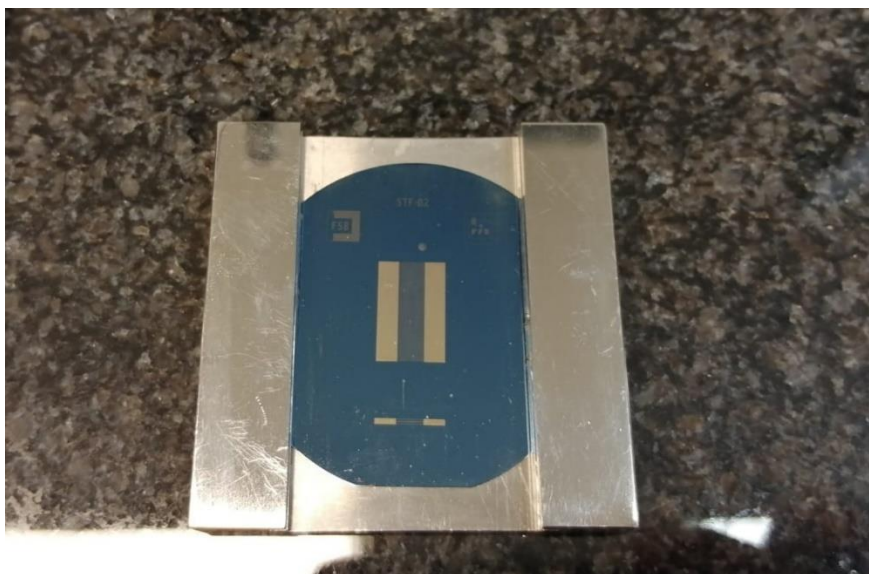
Slika 21. Etalon s regularnom pravokutnom geometrijom
