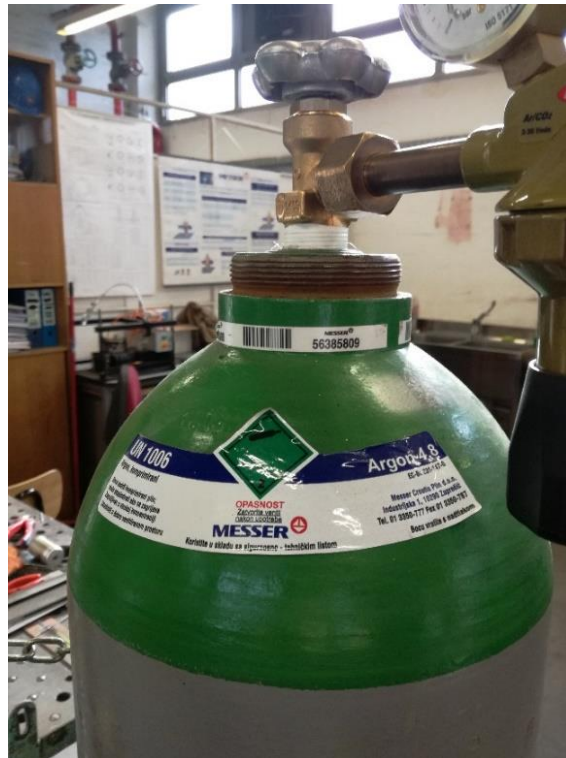
Slika 41. Boca zaštitnog plina Argon 4.8
