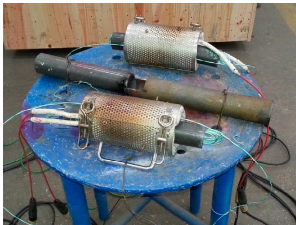
Slika 24. Postavka prilikom predgrijavanja cijevi od čelika [12]
