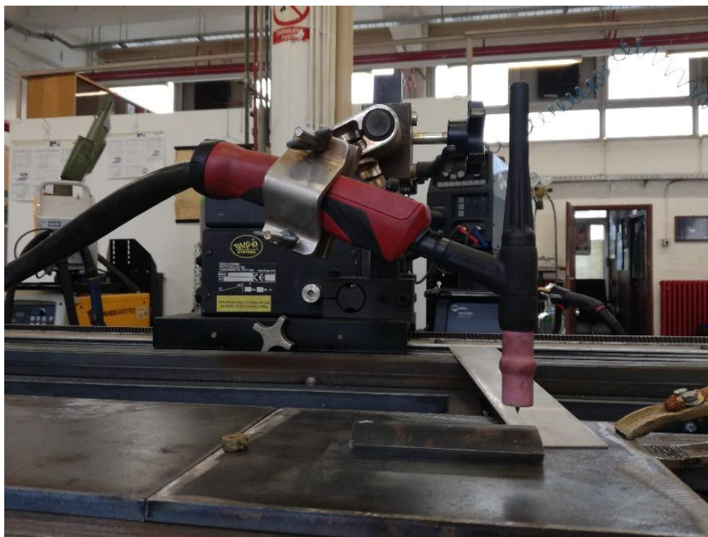
Slika 39. Uzorak 1 pozicioniran u odnosu na pištolj za zavarivanje prije početka protaljivanja
