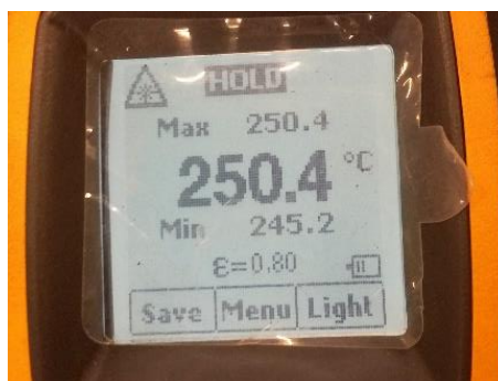
Slika 38. Izmjerena temperatura na termometru Fluke 568 neposredno prije protaljivanja
