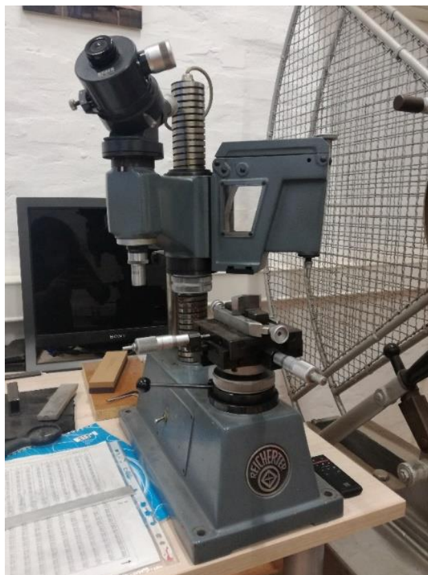
Slika 70. Uređaj za mjerenje tvrdoće Reichert
