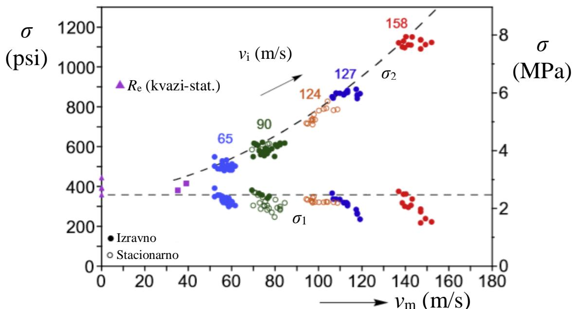
Slika 14. Ovisnost naprezanja o brzini tijekom udarnog opterećenja [7]
