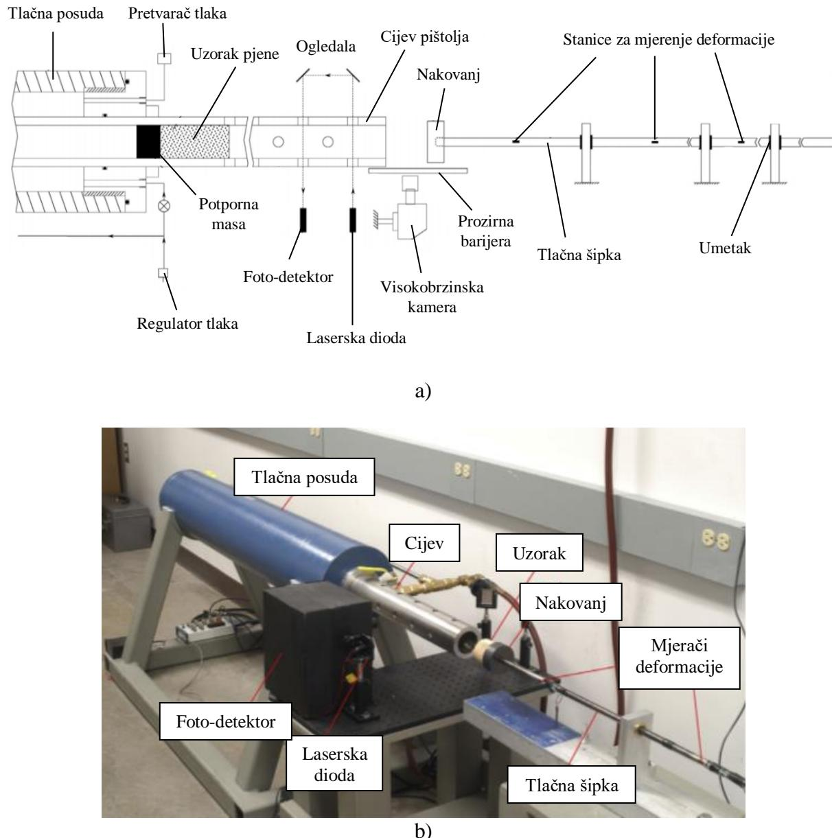
Slika 7. Eksperimentalna postavka za ispitivanje udara prikazana:
