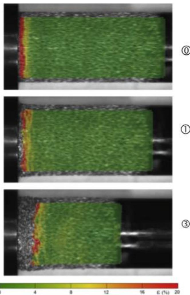
Slika 11. Obrađeni fotografski zapisi visokobrzinske kamere [7]
