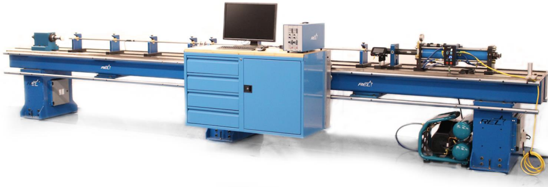
Slika 24. Prikaz cijelog SHPB sustava [8]
