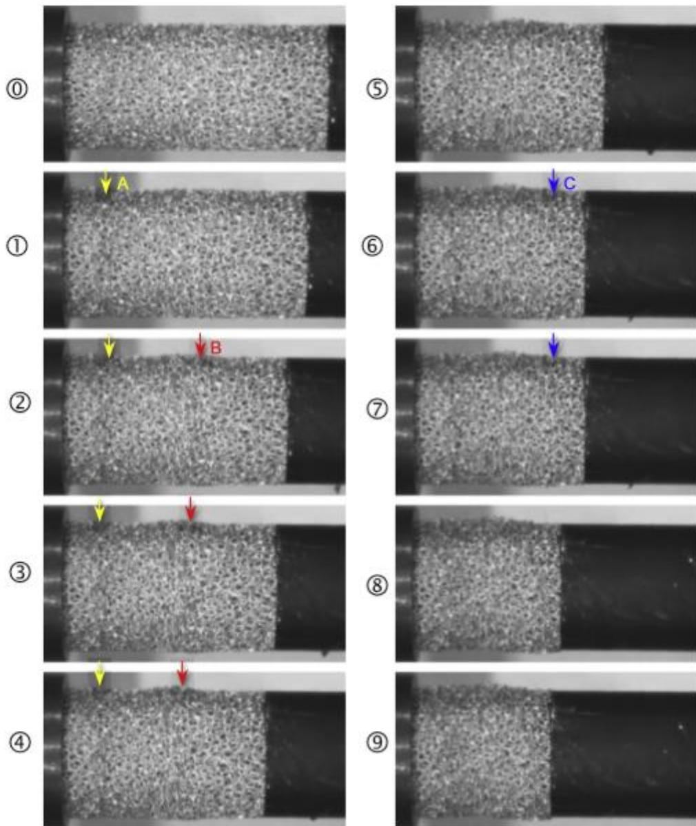
Slika 17. Fotografski zapisi visokobrzinske kamere prilikom ispitivanja izravnog udara pri  $v_i = 35 \text{ m/s}$  [7]
