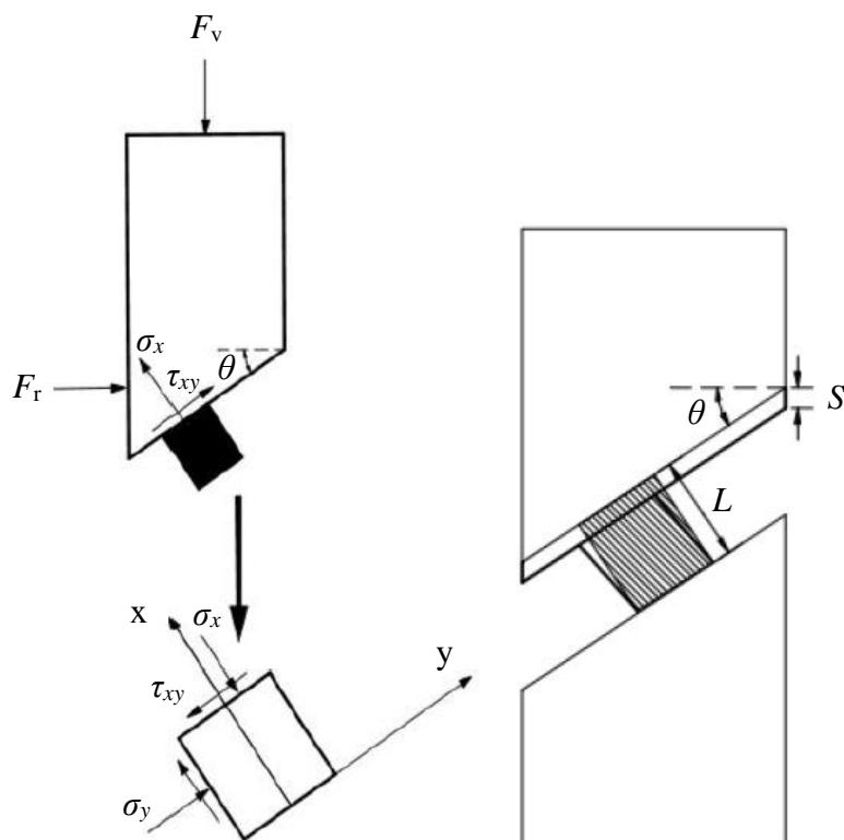
Slika 21. Shematski prikaz kvazi-statičkog višeosnog opterećenja [6]
