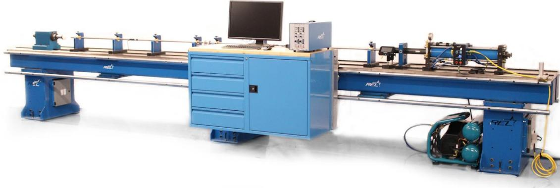
Slika 24. Prikaz cijelog SHPB sustava [8]
