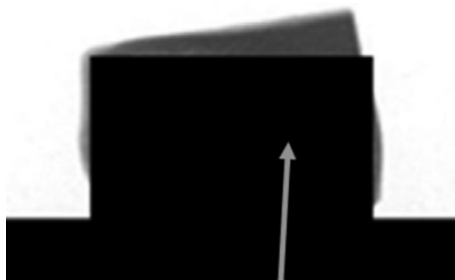
Slika 55. Rana ekspanzija prekursora nakon TO (XY prikaz, strelica označava inicijalni prekursor) [16]
