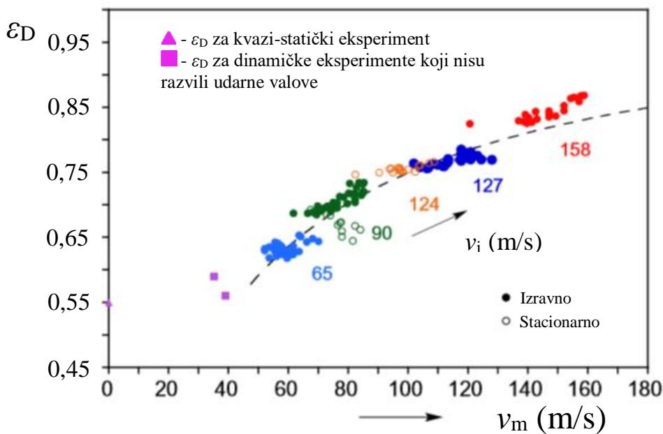
Slika 13. Ovisnost deformacije zgušnjavanja o brzini udara [7]
