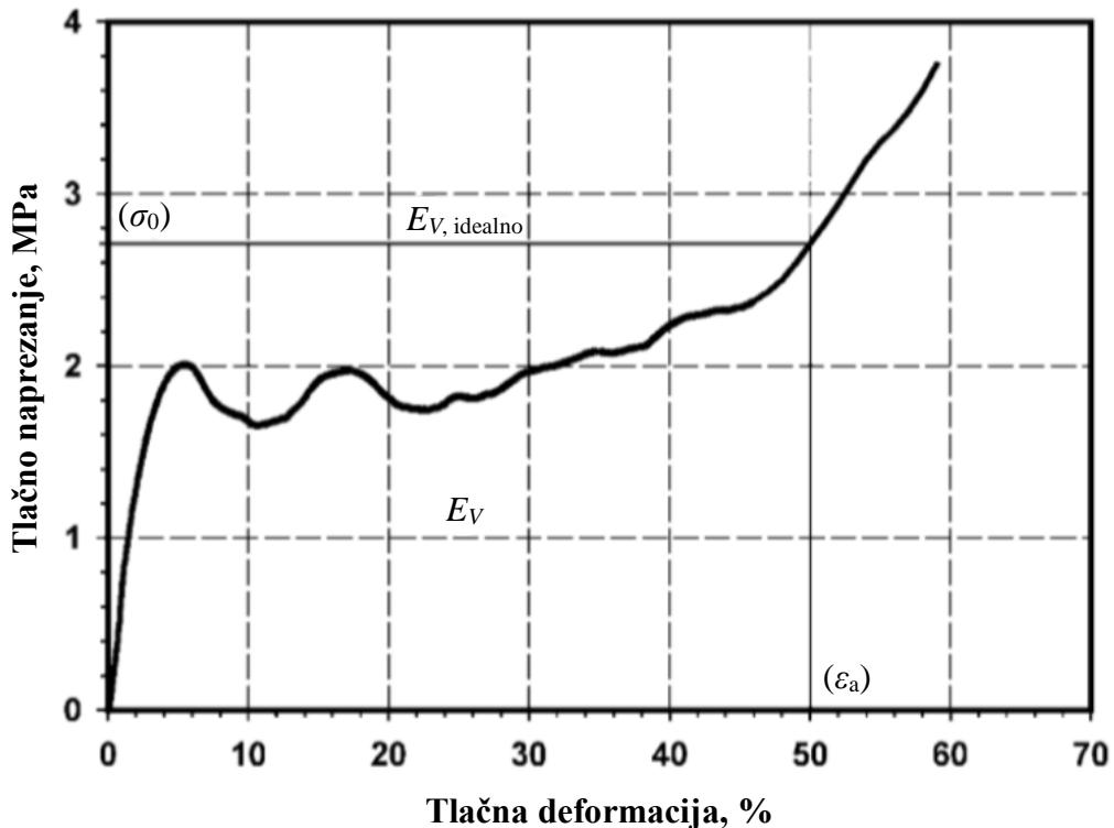
Slika 4. Dijagram naprezanja i deformacije pri tlačnom opterećenju [4]
