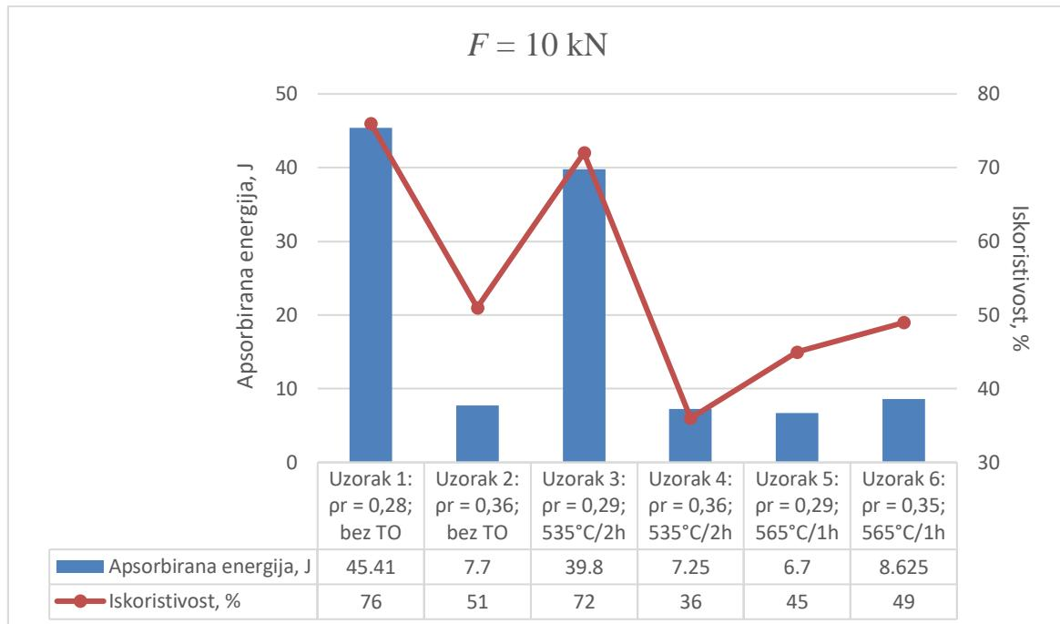
Slika 78. Dijagram apsorbirane energije i iskoristivosti ( $F = 10 \text{ kN}$ )
