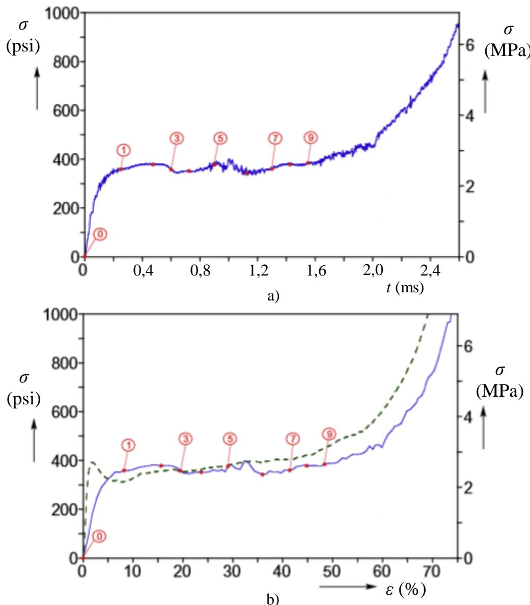
Slika 16. Krivulje apsorpcije energije tijekom ispitivanja izravnog udara pri  $v_i = 35 \text{ m/s}$ :
