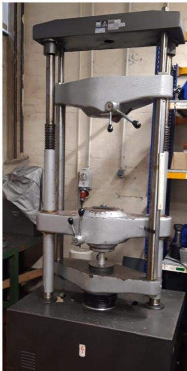
Slika 66. Univerzalna kidalica WPM EU 40 mod.
