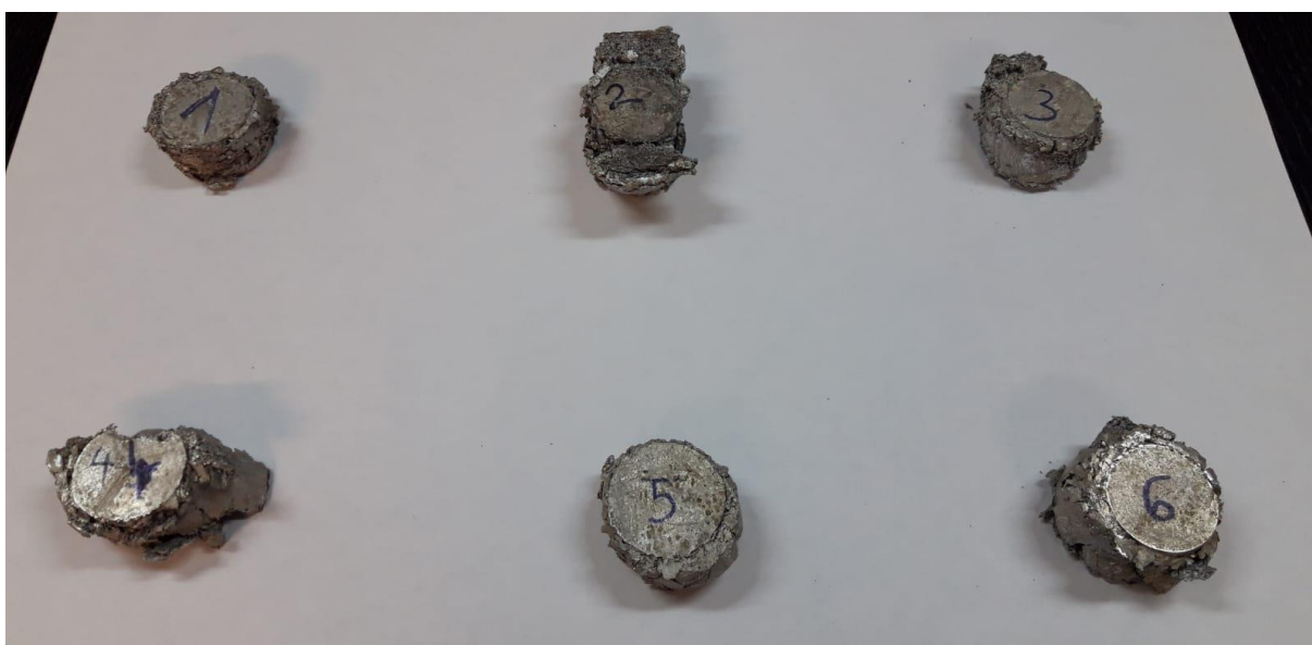
Slika 70. Uzorci nakon tlačenja
