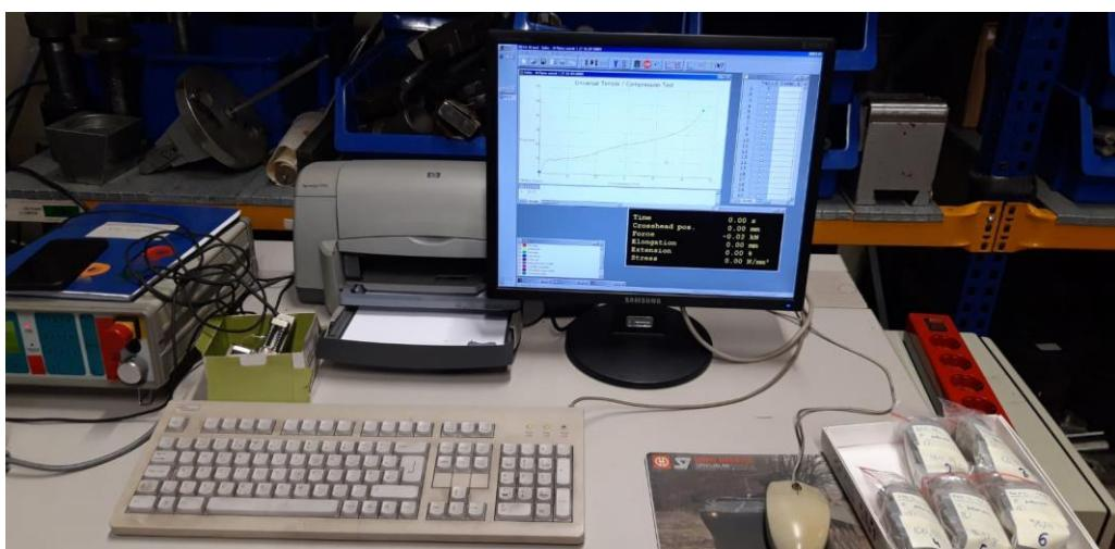
Slika 67. Program TIRAtest System povezan s kidalicom
