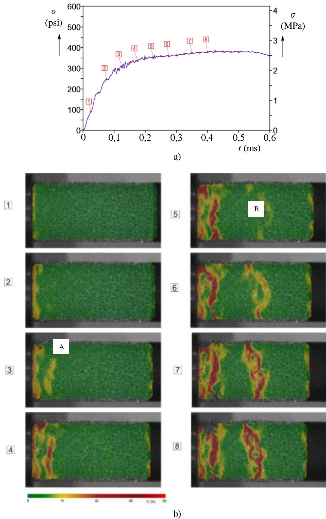
Slika 18. Zone lokalne deformacije koje se javljaju pri brzini udara  $v_i = 35$  m/s (b) te za njih pripadajući dijagram naprezanja u vremenu (a) [7]
