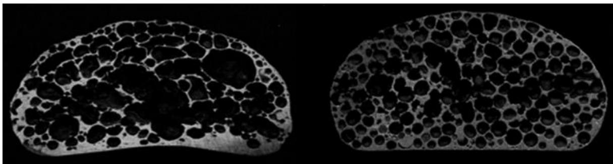
Slika 56. Čelijaste strukture pjene generirane od toplinski neobrađenog (lijevo) i obrađenog prekursorsa (desno) [16]
