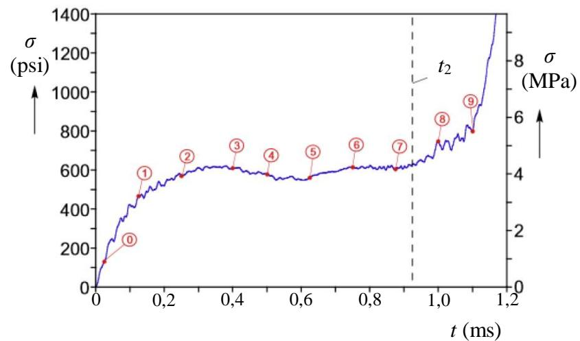
Slika 9. Snimljeni dijagram naprezanja u vremenu za Al pjenu udarenu pri  $v_i = 90$  m/s [7]
