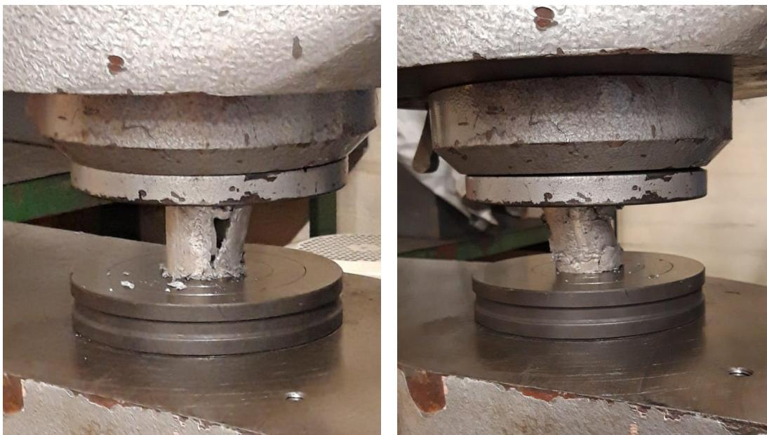
Slika 82. Tlačenje uzorka 2 (lijevo) i uzorka 4 (desno)
