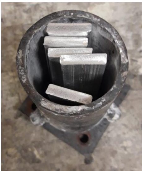
Slika 62. Toplinski neobrađeni prekursori u kalupu
