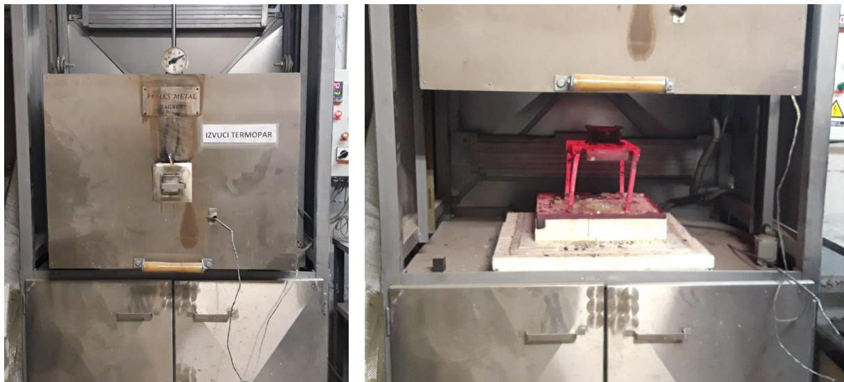
Slika 63. Kalup u peći
