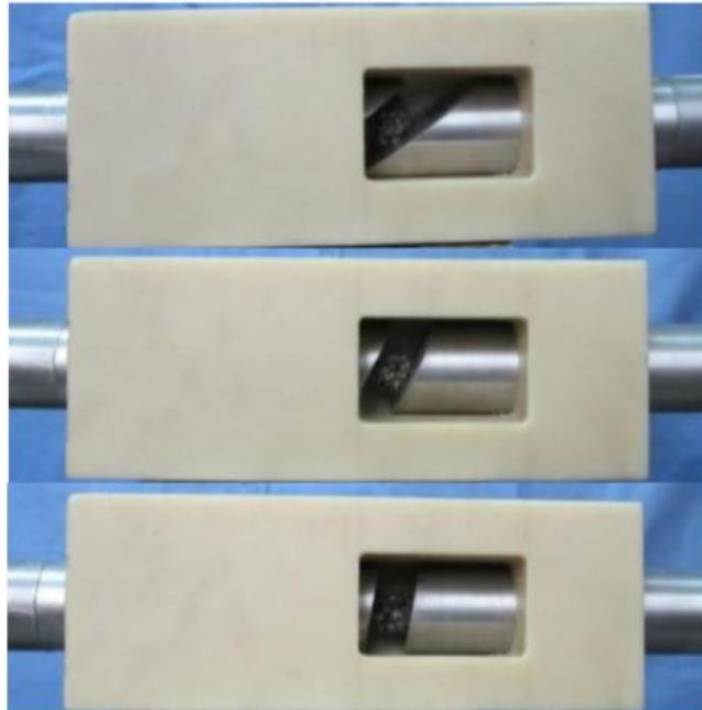
Slika 25. SHPB naprave različitog kuta opterećenja uzorka pjene [6]
