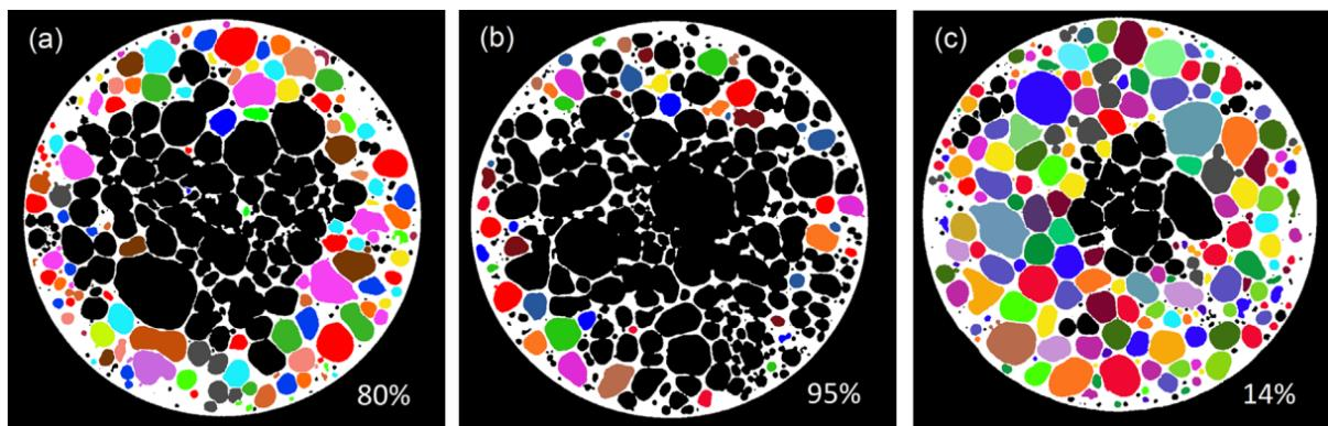
Slika 58. Unutarnja ćelijasta struktura pjena skrućivanih različitim brzinama:
