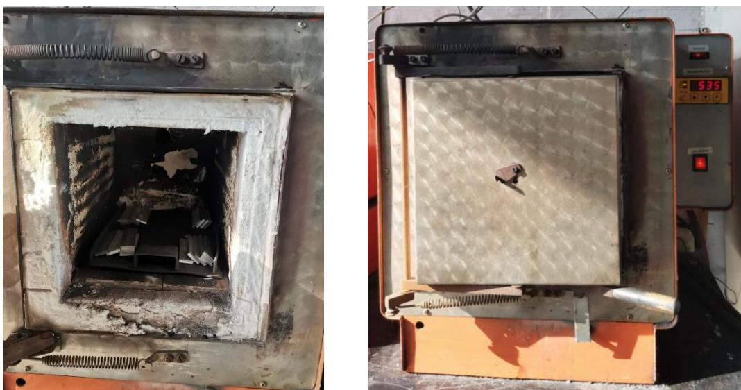
Slika 60. Prekursori u peći za toplinsku obradu
