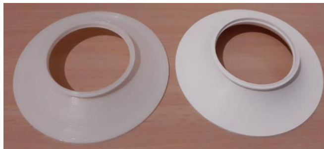
Slika 70. Prikaz difuzora s radijusom zakrivljenosti r=50 mm (lijevo) i r=36 mm (desno)
