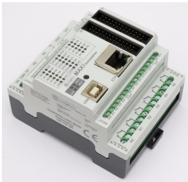
Slika 20. Controllino Maxi Automation uređaj
