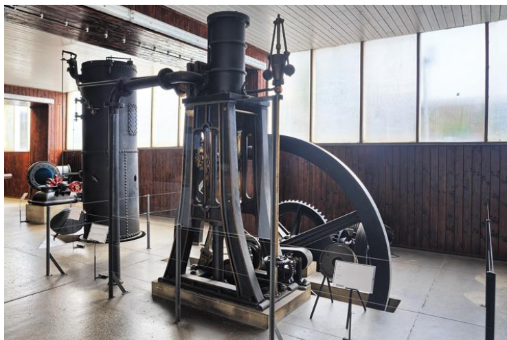
Slika 5: Stojeći stapni parni stroj, 19.st., Tehnički muzej Nikola Tesla, Zagreb [3]
