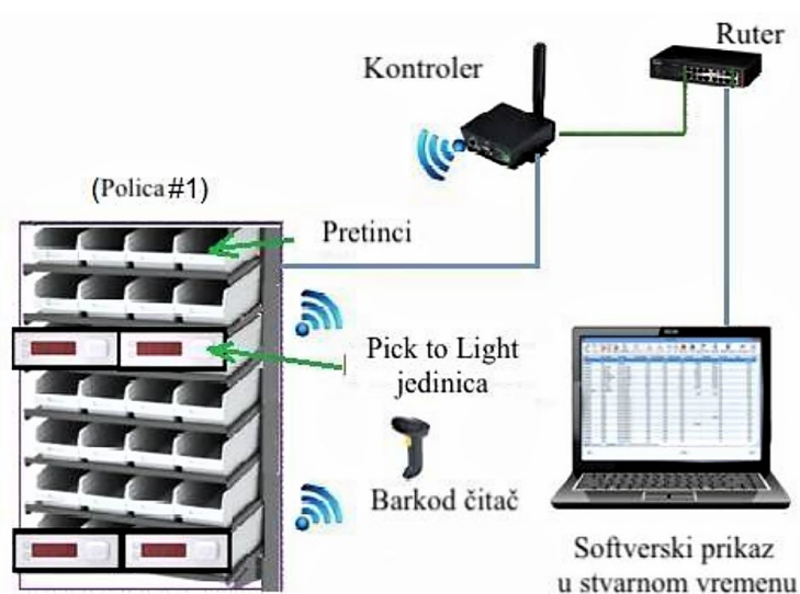
Slika 29. Arhitektura „Pick to light“ sustava
