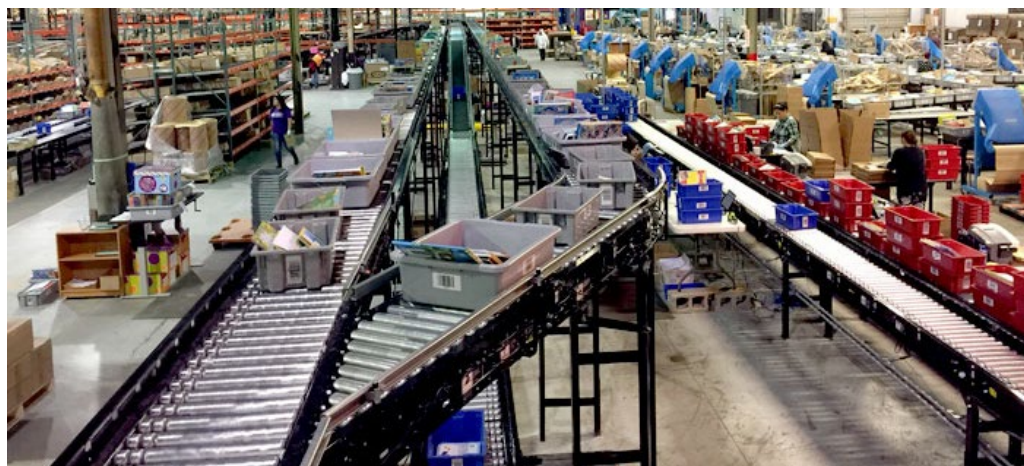
Slika 22. Sustav konvejera za komisioniranje
