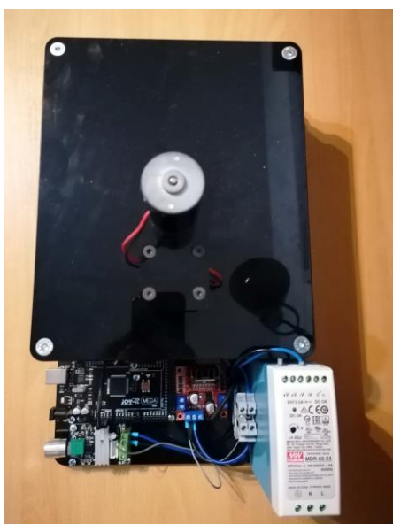
Slika 16 – Prikaz pogonskih i upravljačkih komponenti sustava na stvarnom modelu
