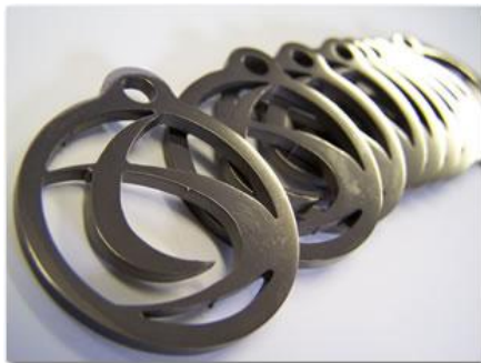
Slika 22. Primjer primjene postupka vanadiranja (TD) [20]
