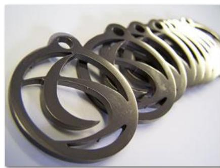
**Slika 22.** Primjer primjene postupka vanadiranja (TD) [20]
