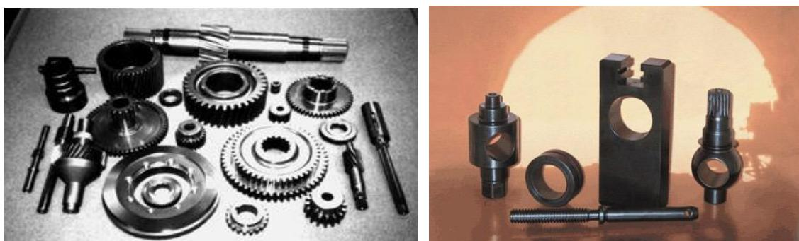
Slika 6. Dijelovi mjenjačke kutije automobila obrađenih nitrokarburiranjem [7]
