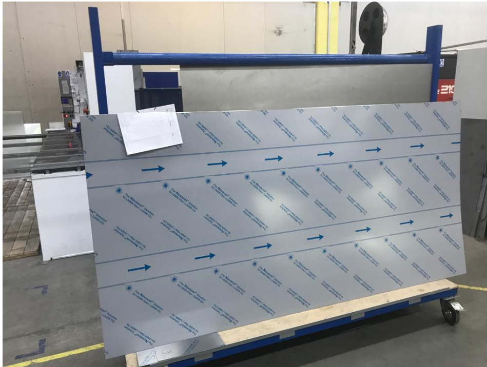
Slika 36. Izrezani lim spreman za CNC obradu
