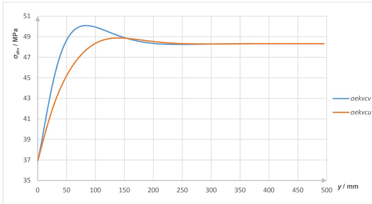
Slika 36. Raspodjela ekvivalentnog naprezanja duž unutarnjeg i vanjskog ruba cilindrične ljske
