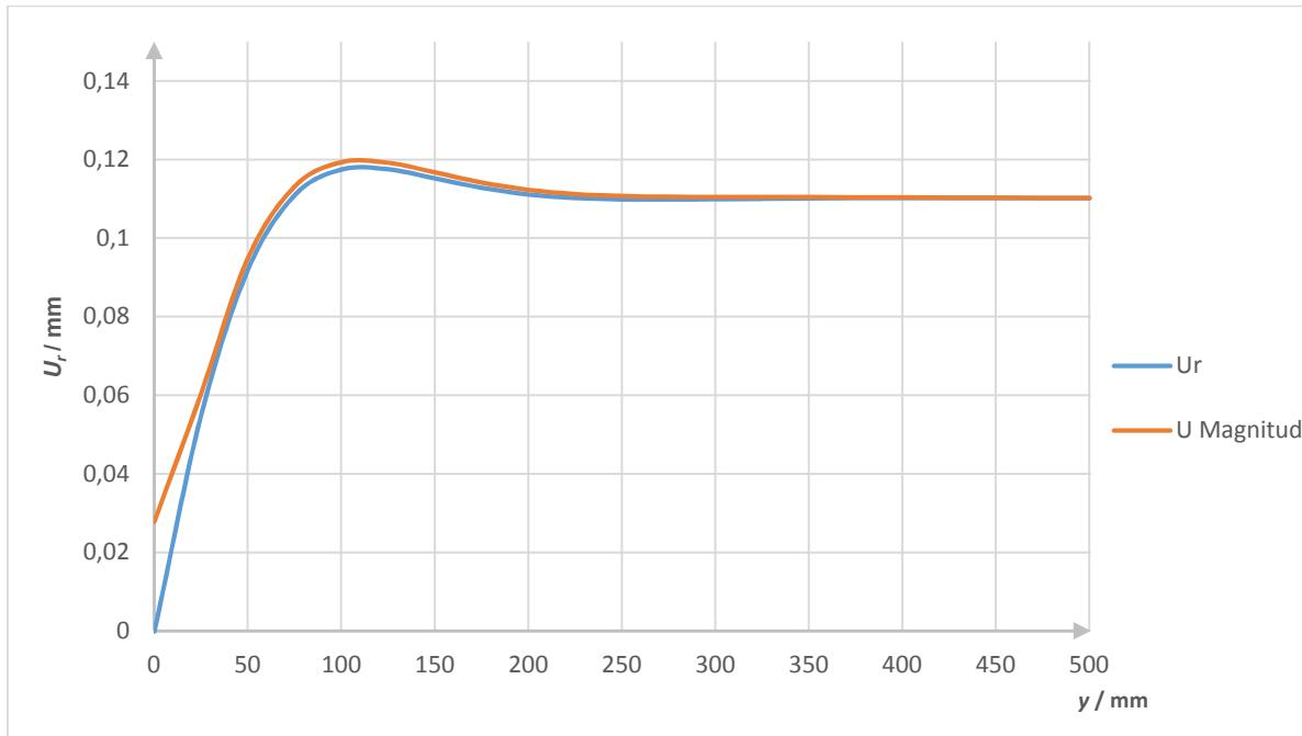
Slika 72. Raspodjela radijalnog pomaka cilindrične ljske - radno opterećenje
