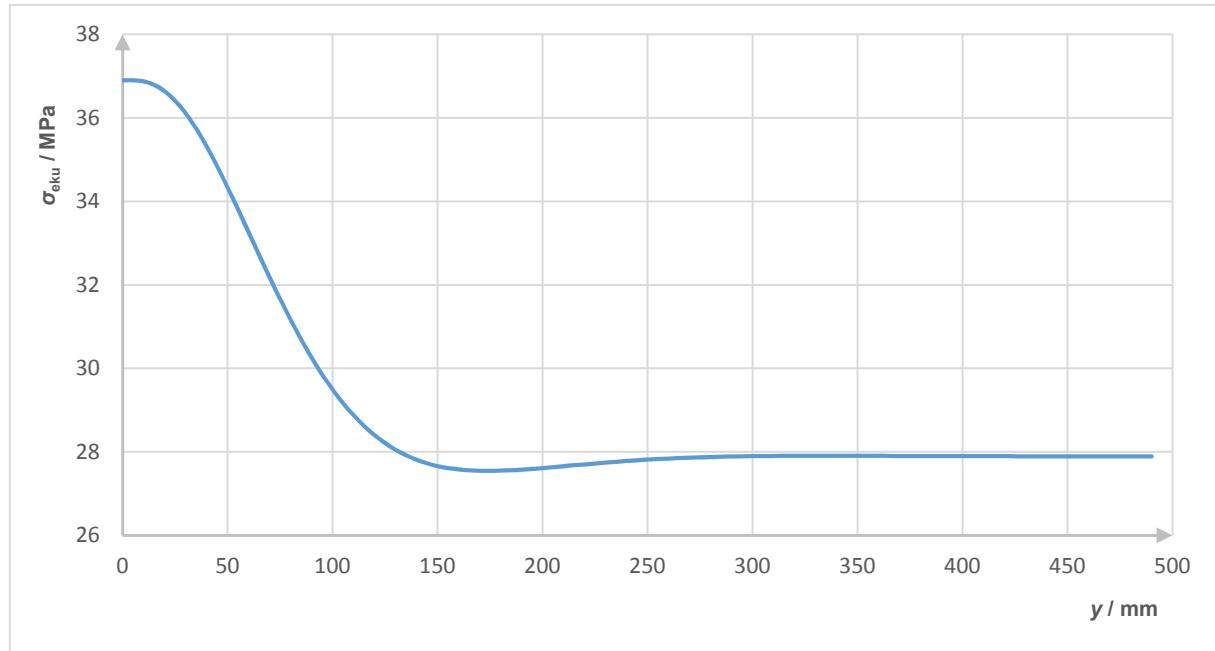
Slika 22. Ekvivalentna naprezanja duž unutrašnjeg ruba sferne ljske
