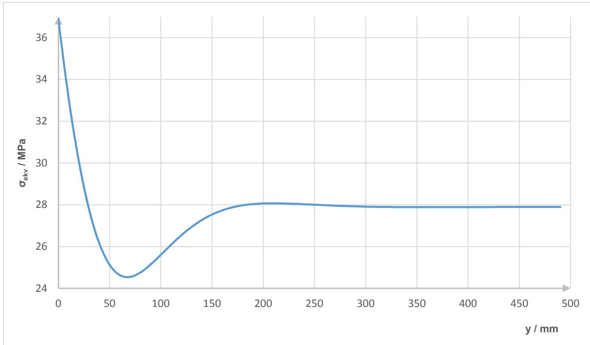
Slika 19. Raspodjela ekvivalentnog naprezanja duž vanjskog ruba sferne ljsuske
