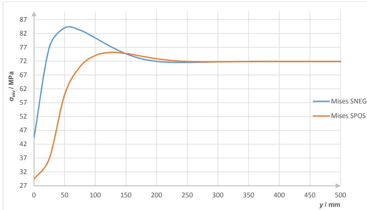
Slika 85. Raspodjela ekvivalentnog naprezanja duž vanjskog i unutarnjeg ruba cilindrične ljske - tlačna proba
