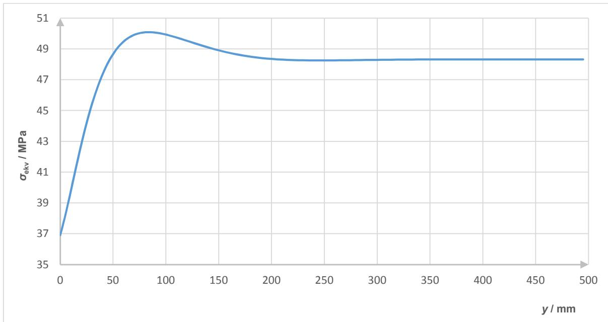
Slika 35. Raspodjelu ekvivalentnog naprezanja duž unutrašnjeg ruba cilindrične ljske
