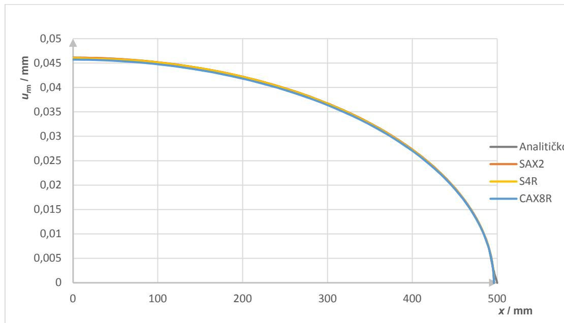
Slika 51. Raspodjela membranskog radijalnog pomaka duž izvodnica sferne ljske
