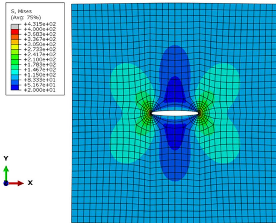
Slika 101. Polje ekvivalentnog naprezanja prema Von Misesu za slučaj elastoplastične analize pri opterećenju  $\sigma_y = 200$  MPa i duljini pukotine  $a = 12\text{mm}$
