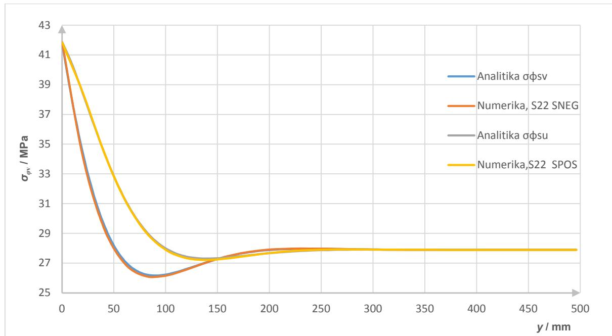
Slika 61. Raspodjela cirkularnog naprezanja duž vanjskog i unutrašnjeg ruba sferne ljske
