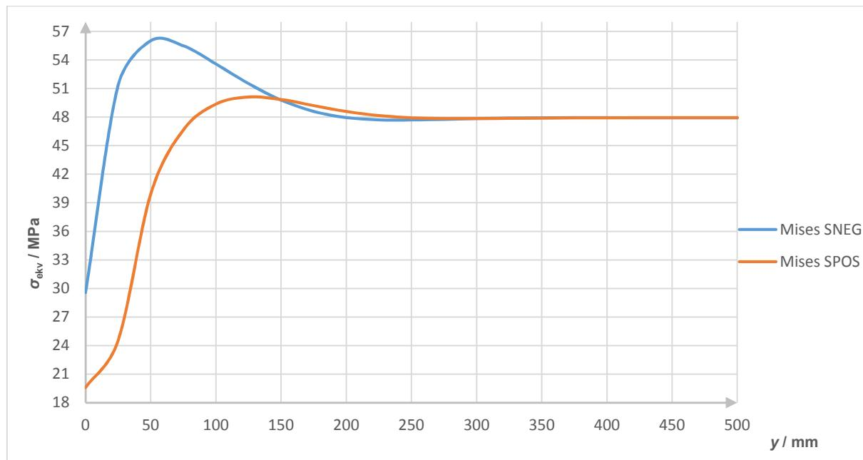
Slika 75. Raspodjela ekvivalentnog naprezanja duž vanjskog i unutarnjeg ruba cilindrične ljske - radno opterećenje
