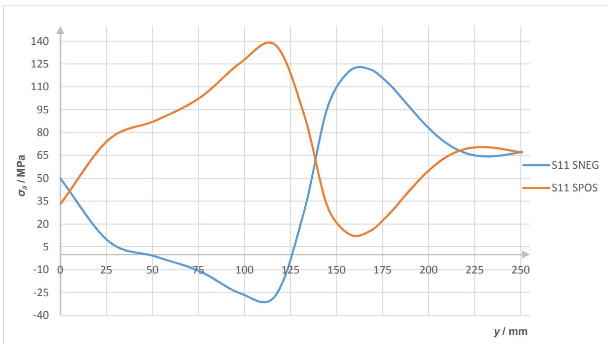
Slika 79. Raspodjela meridijalnih naprezanja duž vanjskog i unutarnjeg ruba torisferne ljske - tlačna proba
