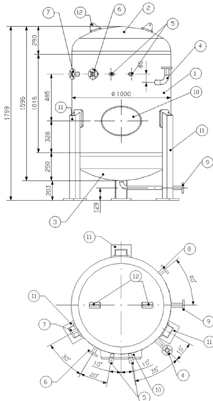
Slika 1. Tlačni spremnik zraka volumena  $1 \text{ m}^3$
