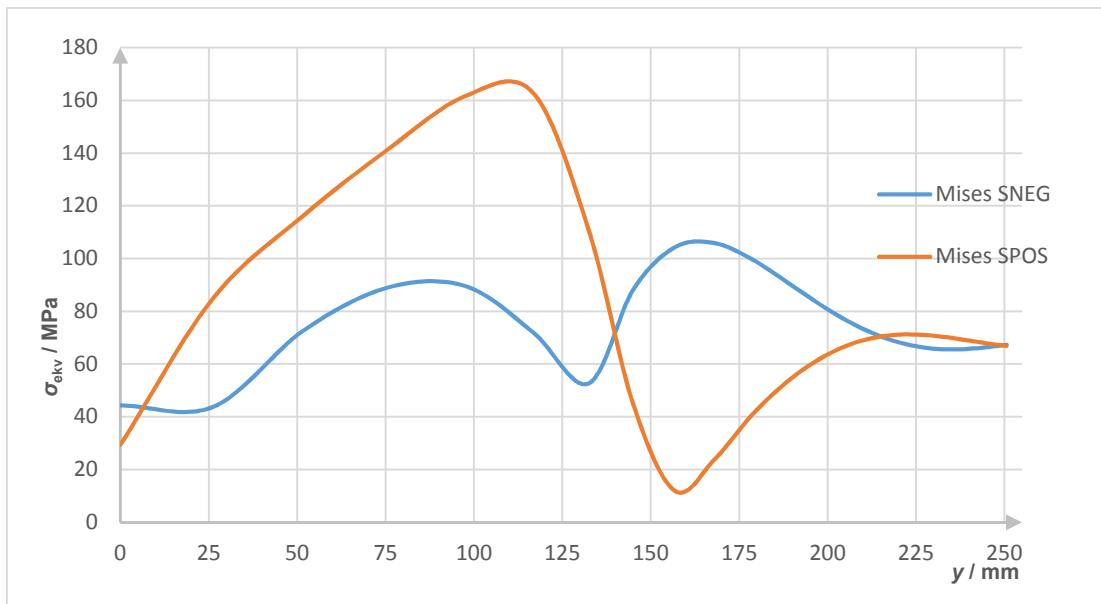
Slika 81. Raspodjela ekvivalentnog naprezanja duž vanjskog i unutarnjeg ruba torisferne ljske - tlačna proba
