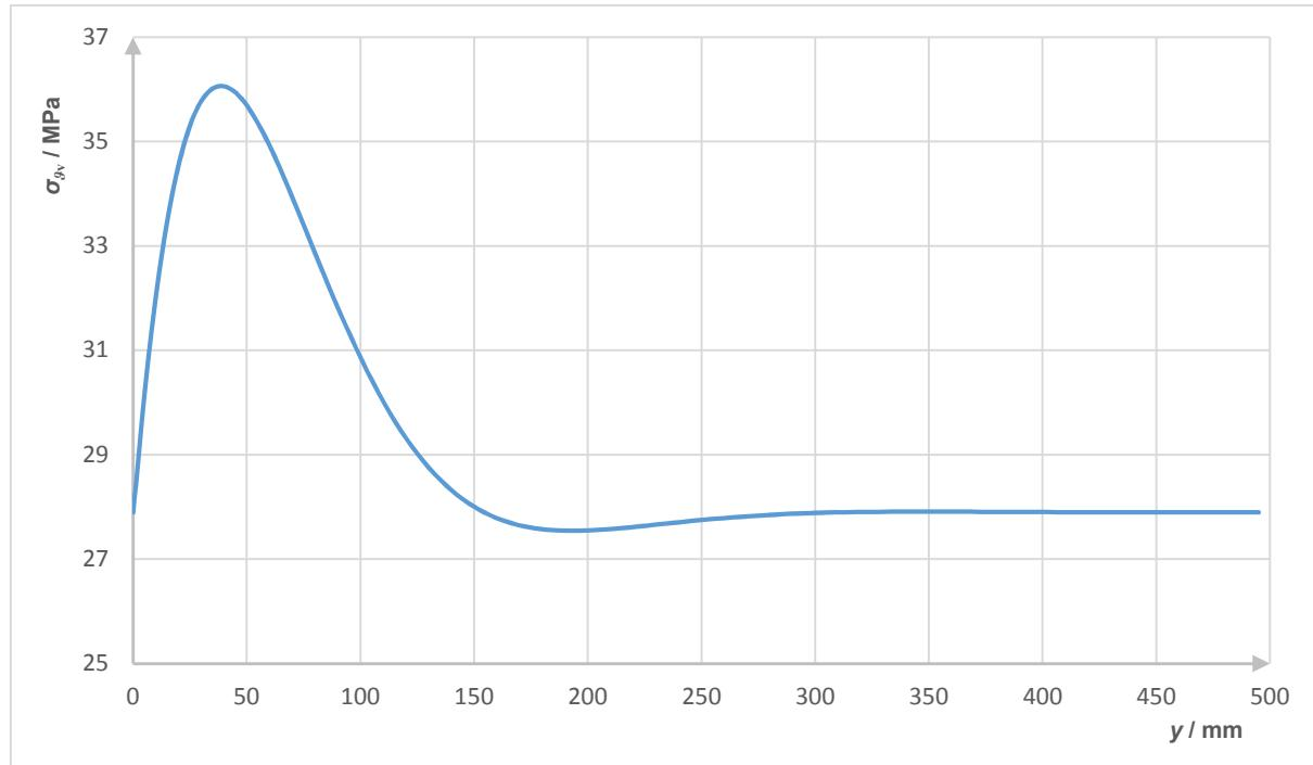
Slika 30. Raspodjela meridijalnih naprezanja duž vanjskog ruba cilindrične ljske
