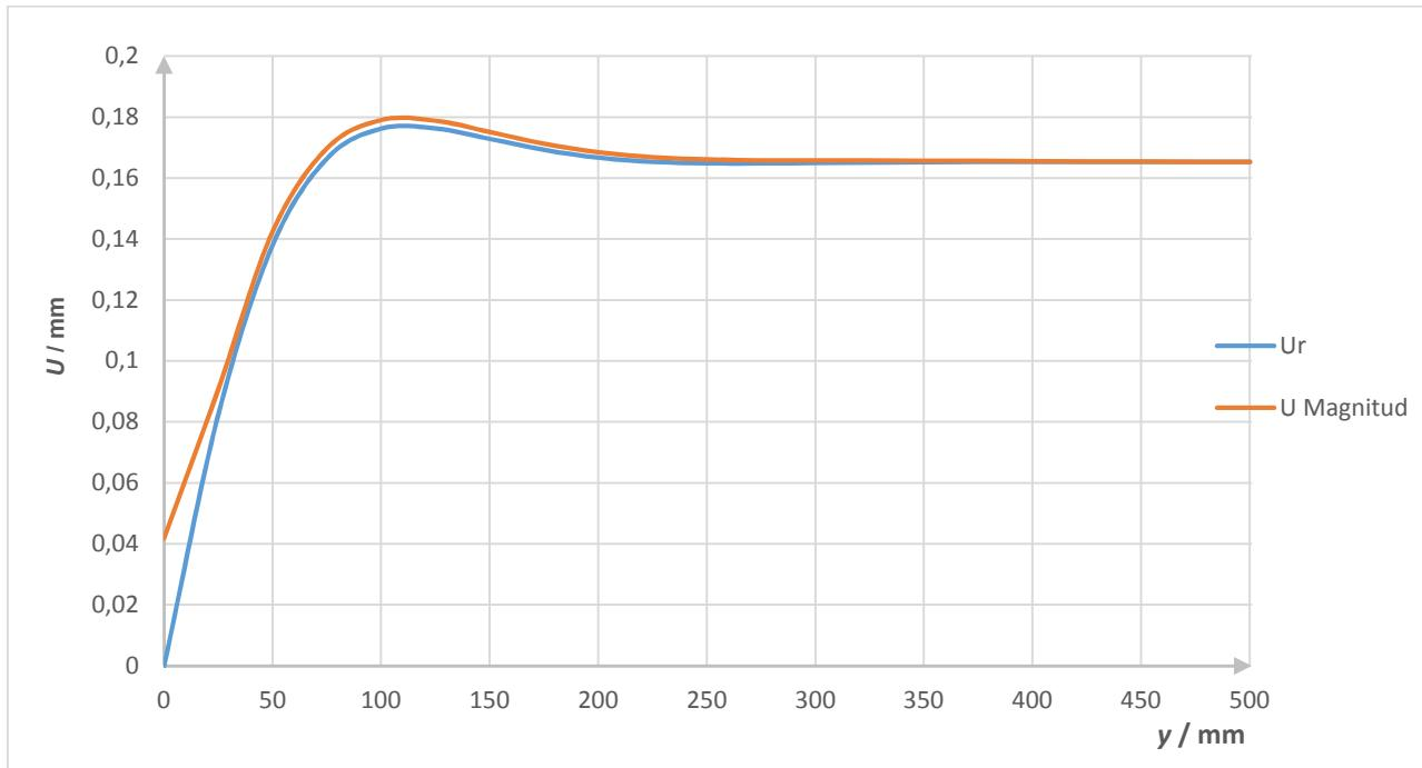
Slika 82 Raspodjela radijalnog pomaka duž cilindrične ljske - tlačna proba
