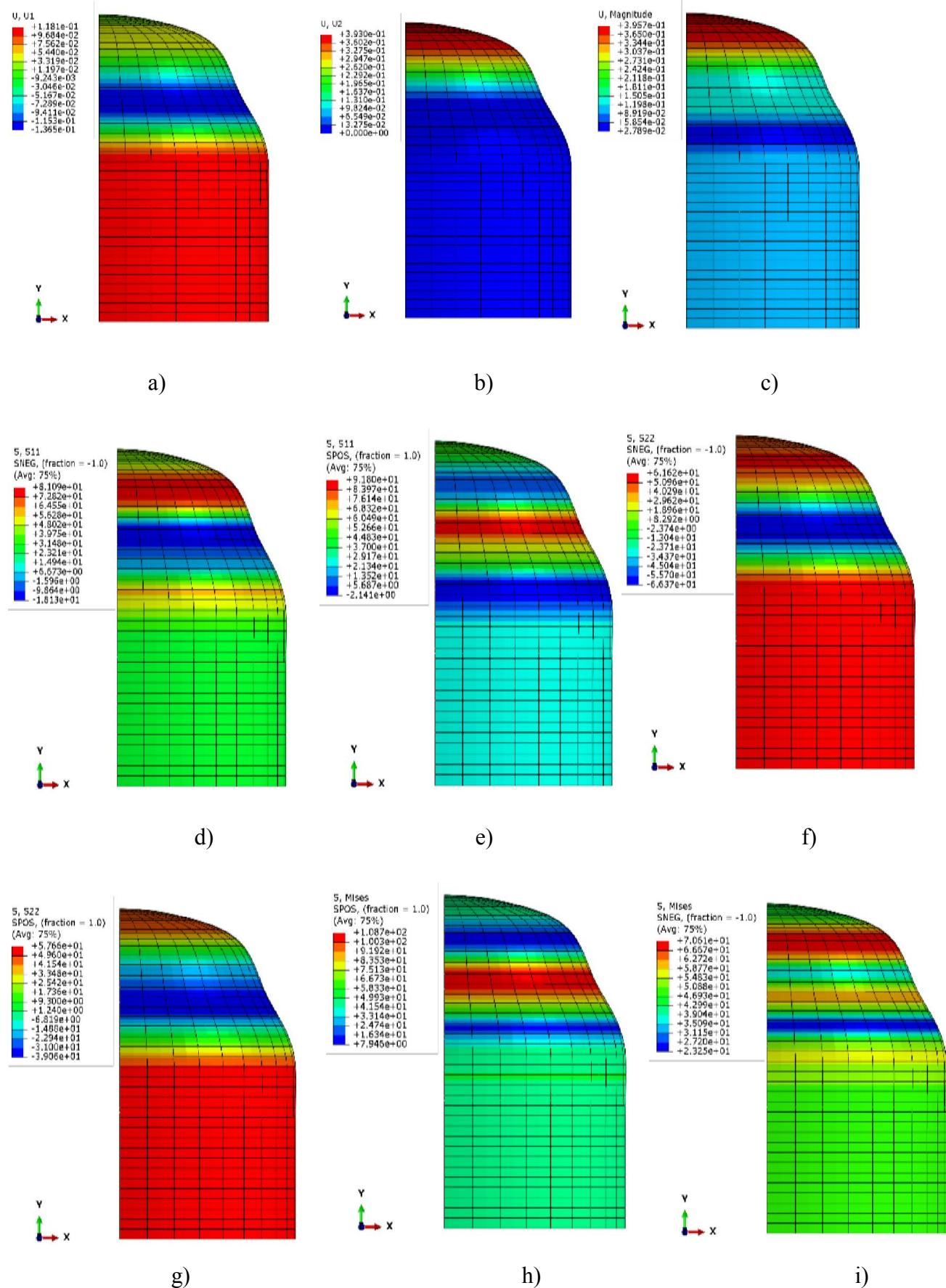
Slika 67. Prikaz raspodjele za radno opterećenje: a) radijalnih pomaka u mm, b) meridijalnih pomaka u mm, c) normalnih pomaka u mm, d) cirkularnih naprezanja sa vanjske strane lјuske u MPa, e) cirkularnih naprezanja sa unutarnje strane u MPa, f) meridijalnih naprezanja sa vanjske strane u MPa, g) meridijalnih naprezanja sa unutarnje strane u MPa, h) ekvivalentnih naprezanja sa vanjske strane u MPa, i) ekvivalentnih naprezanja sa unutarnje strane lјuske u MPa
