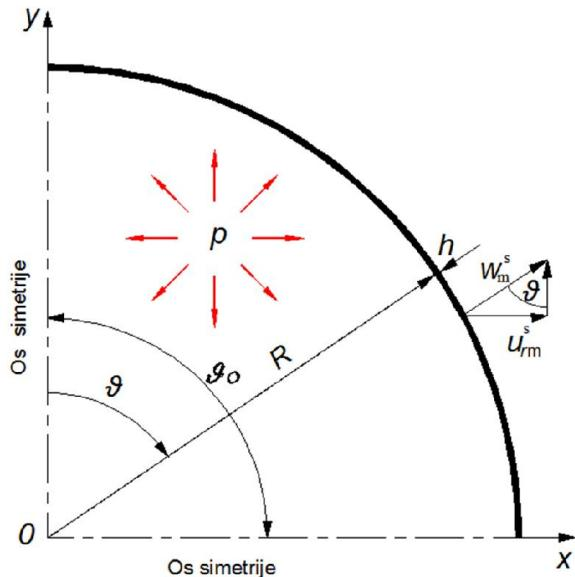
Slika 5. Membransko stanje naprezanja sferne ljeske
