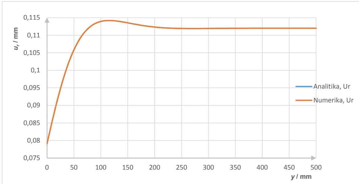
Slika 58. Raspodjela radijalnog pomaka cilindrične lјuske
