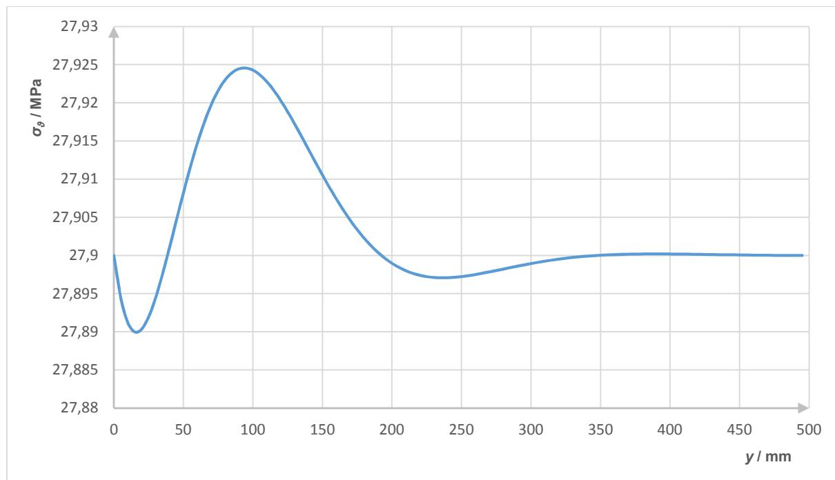
Slika 28. Raspodjela meridijalnog naprezanja cilindrične ljske
