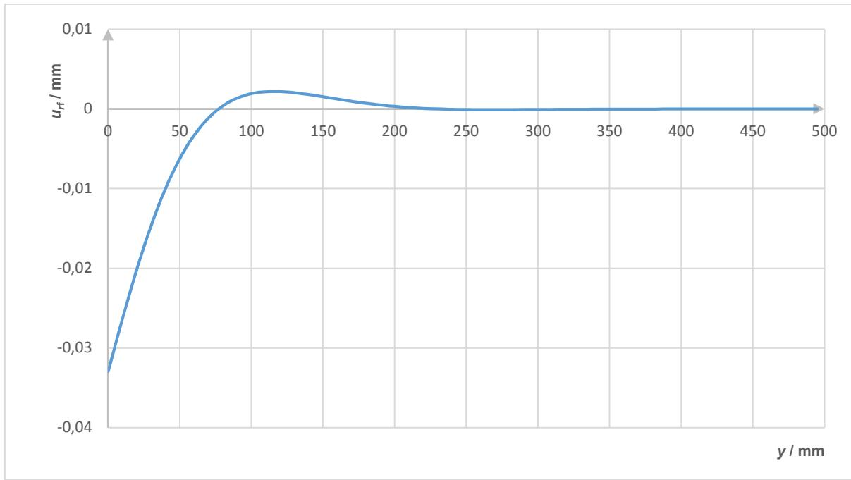
Slika 25. Raspodjela savojnog dijela radijalnog pomaka cilindrične ljske
