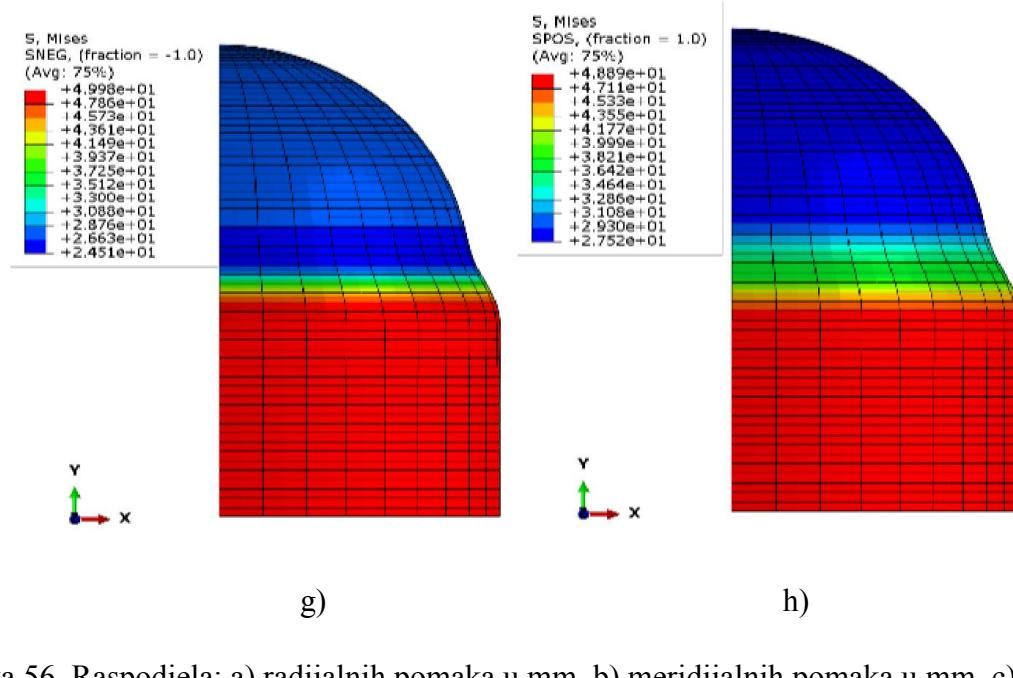
Slika 56. Raspodjela: a) radijalnih pomaka u mm, b) meridijalnih pomaka u mm, c) normalnih pomaka u mm, d) cirkularnih naprezanja sa vanjske strane lјuske u MPa, e) cirkularnih naprezanja sa unutarnje strane lјuske u MPa, f) meridijalnih naprezanja s vanjske strane lјuske i unutarnje strane lјuske u MPa, g) ekvivalentnih naprezanja sa vanjske strane lјuske u MPa, h) ekvivalentnih naprezanja sa unutarnje strane lјuske u MPa
