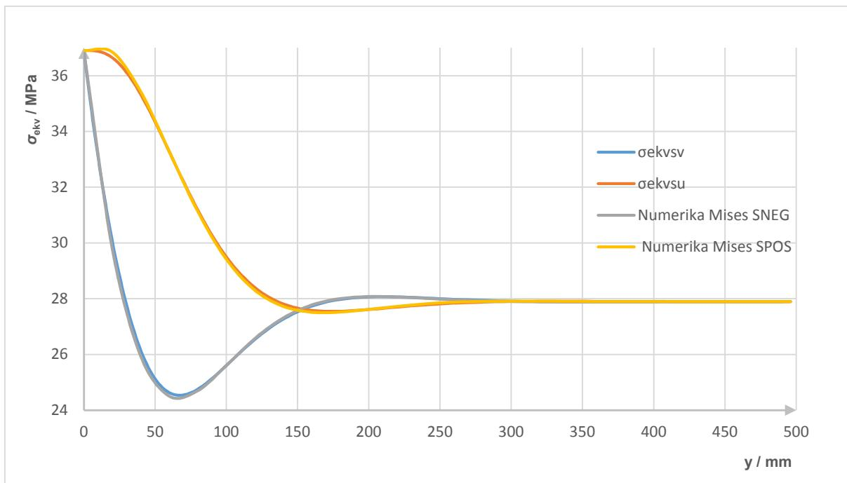
Slika 63. Raspodjela ekvivalentnog naprezanja duž unutrašnjeg i vanjskog ruba sferne ljudske
