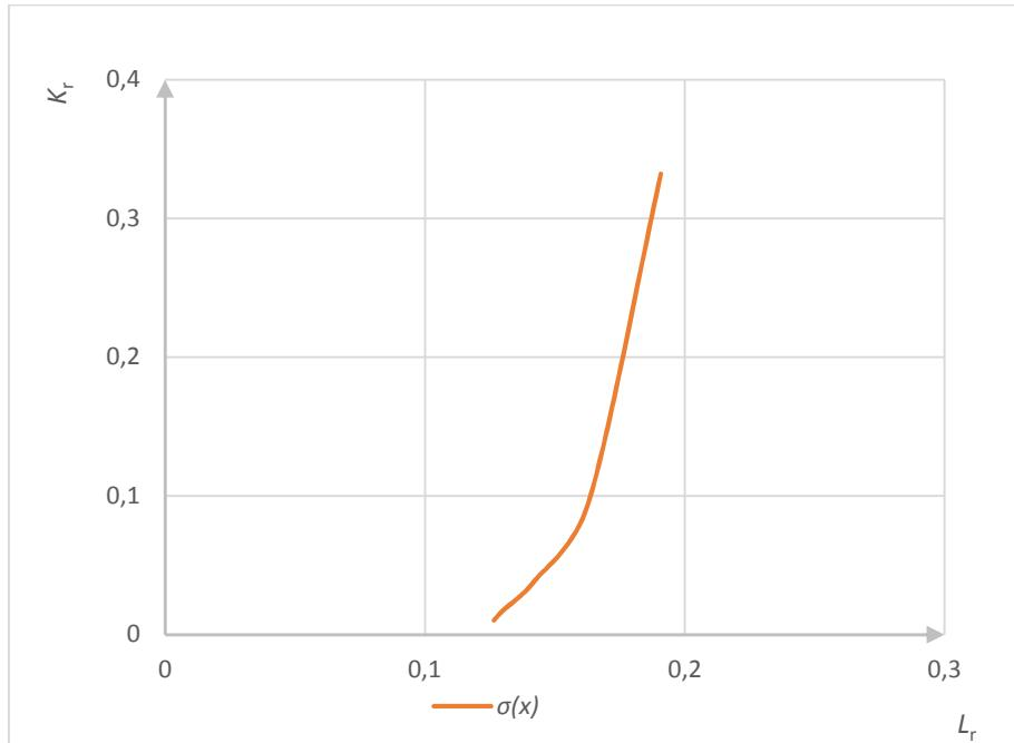
Slika 109. Propagacija cirkularne unutarnje polueliptične pukotine kroz debljinu stjenke tlačne posude u FAD dijagramu
