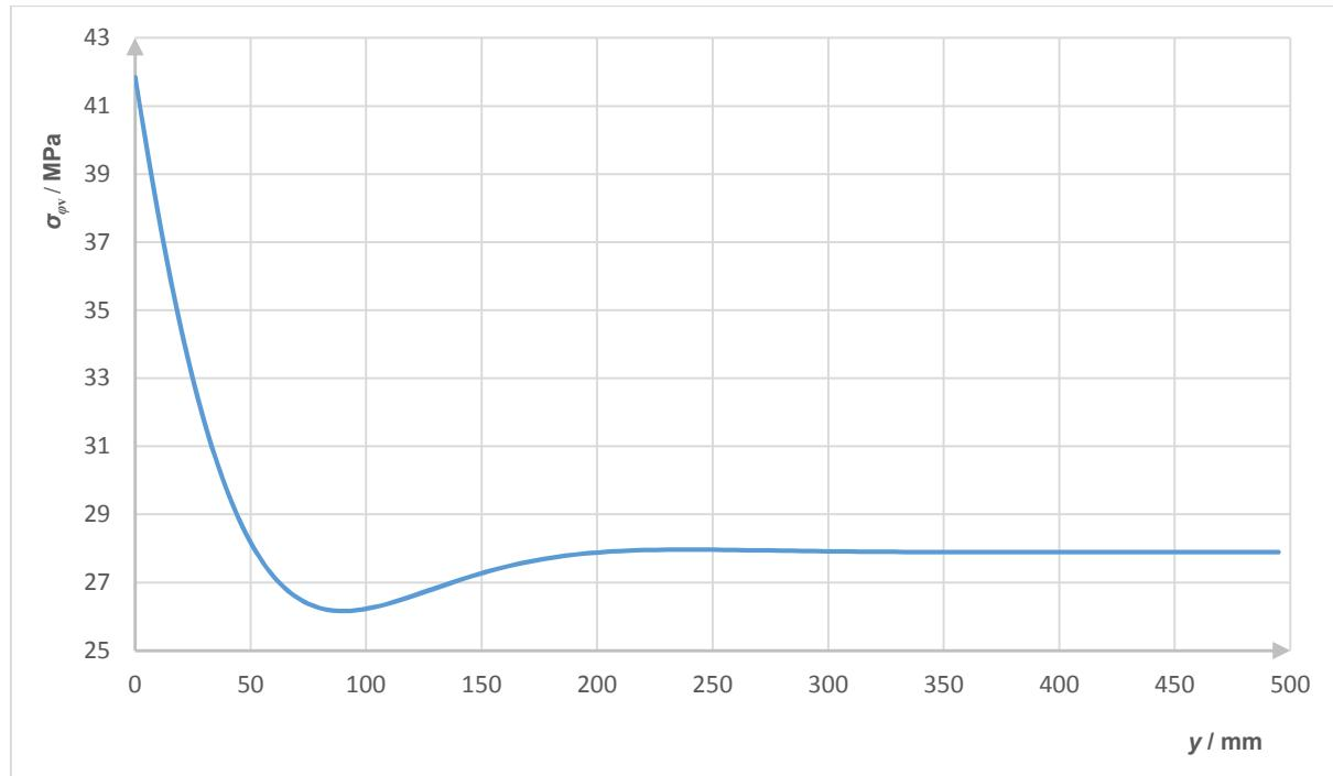
Slika 18. Raspodjela cirkularnih naprezanja duž vanjskog ruba sferne ljske
