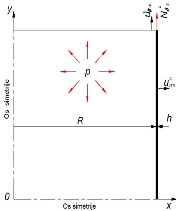
Slika 8. Membransko stanje naprezanja cilindrične ljsuske
