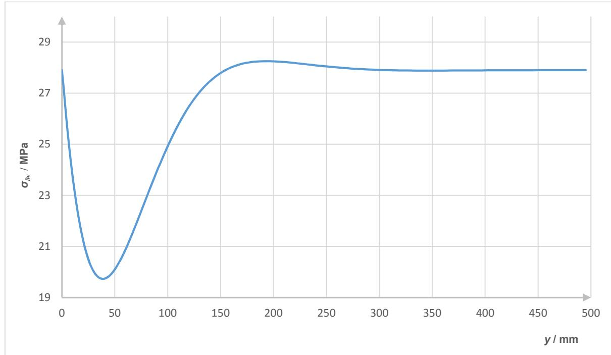
Slika 17. Raspodjela meridijalnih naprezanja duž vanjskog ruba sferne ljeske
