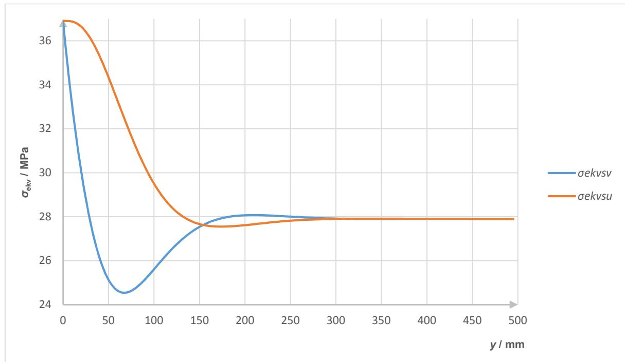
Slika 23. Raspodjela ekvivalentnog naprezanja duž unutarnjeg i vanjskog ruba sferne ljske
