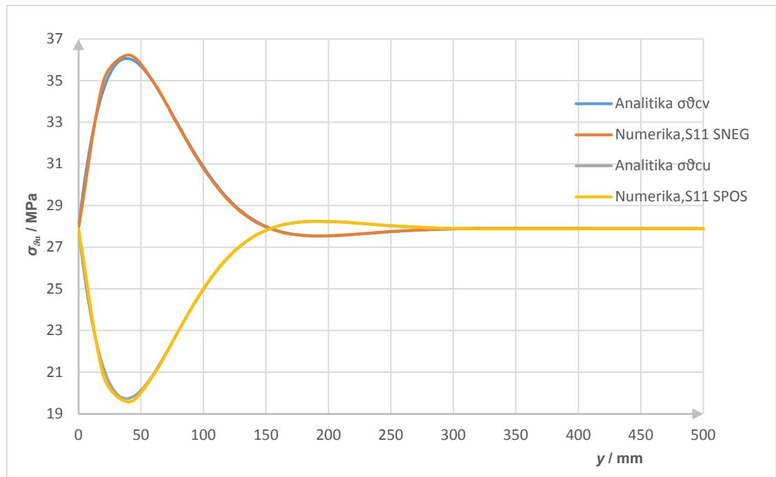
Slika 60. Raspodjela meridijalnog naprezanja duž unutrašnjeg ruba cilindrične ljske
