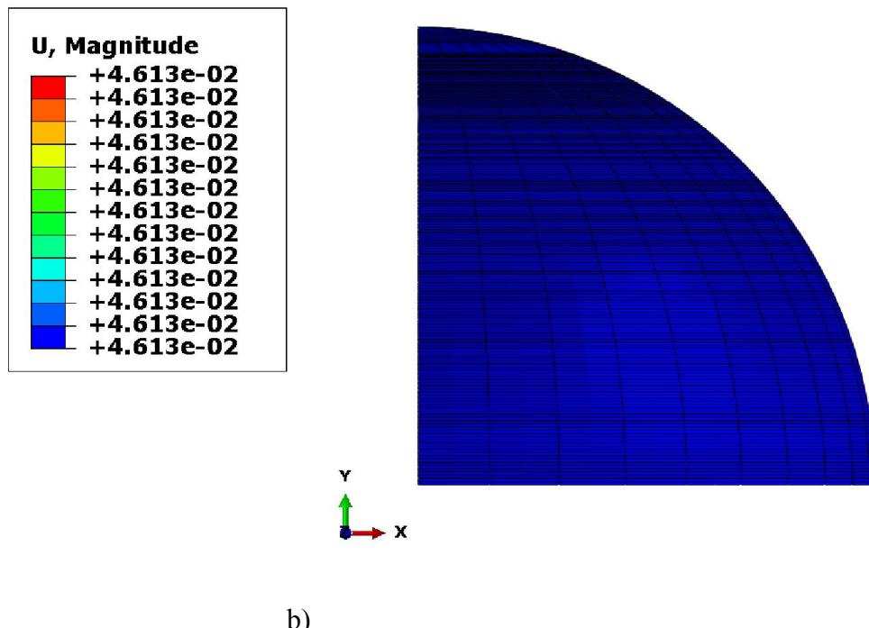
Slika 48. Raspodjela: a) cirkularnih naprezanja u MPa, i b) normalnih pomaka u mm,
