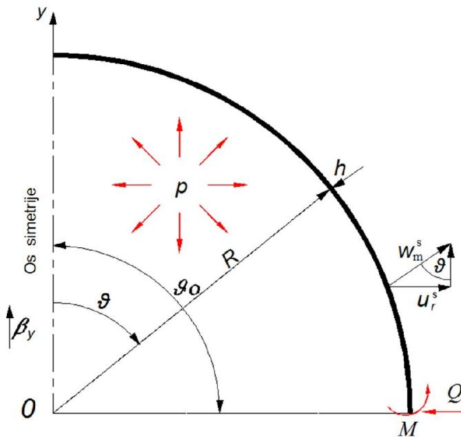
Slika 11. Savijanje sfernog dijela ljsuske spremnika
