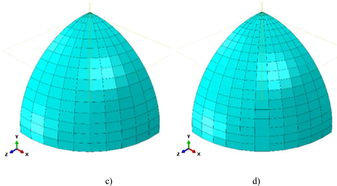
Slika 42. Mreže ljkuskastih elemenata: a) model s 40 elemenata, b) model sa 60 elemenata, c) model s 150 elementa, d) model s 198 elemenata
