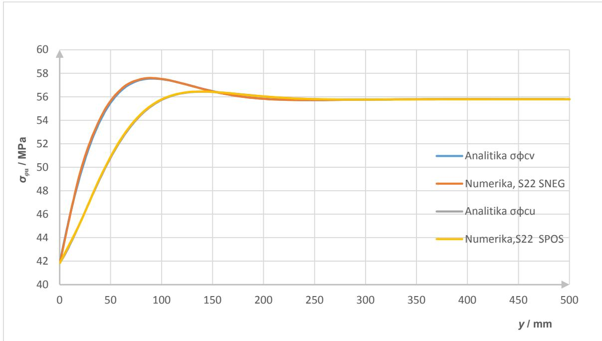
Slika 62. Raspodjela cirkularnog naprezanja duž vanjskog i unutrašnjeg ruba cilindrične ljudske
