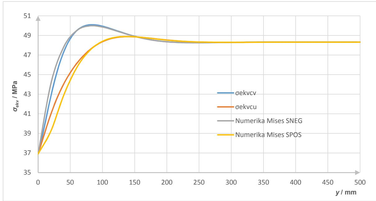
Slika 64. Raspodjela ekvivalentnog naprezanja duž unutrašnjeg i vanjskog i ruba cilindrične ljske
