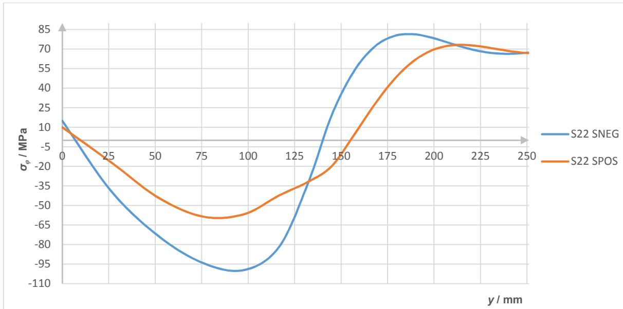
Slika 80. Raspodjela cirkularnih naprezanja duž vanjskog i unutarnjeg ruba torisferne ljske - tlačna proba
