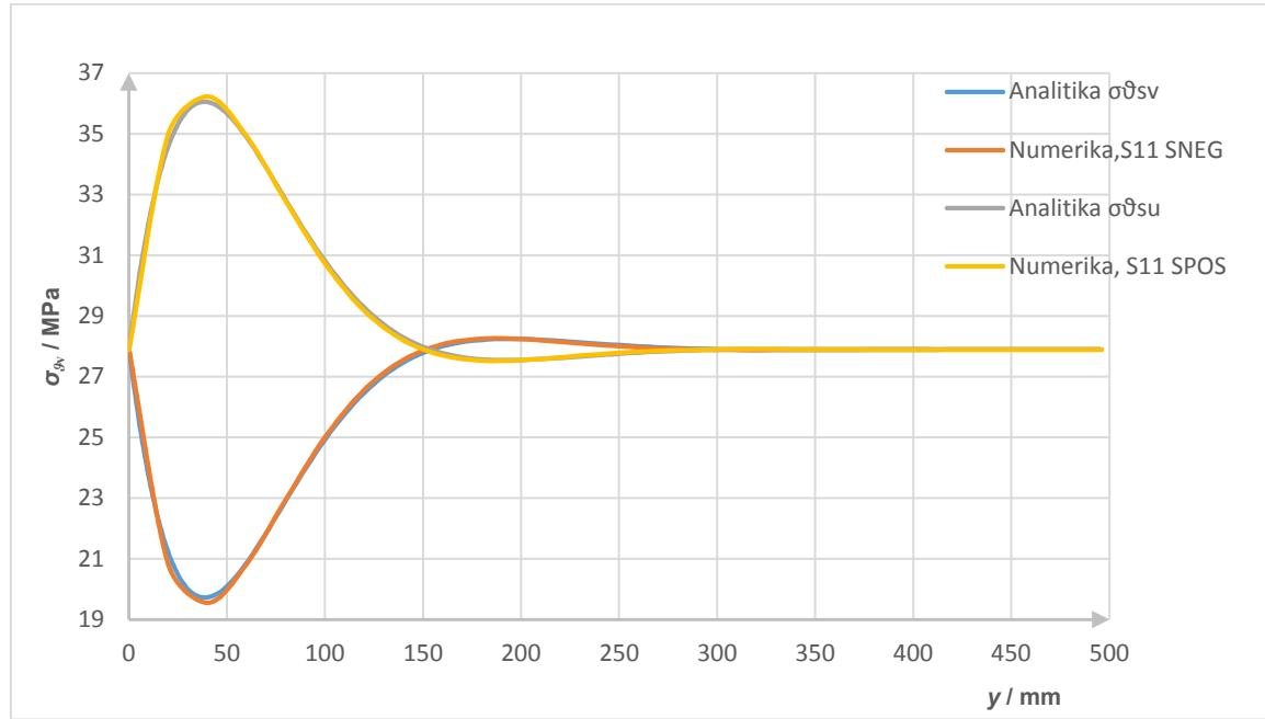
Slika 59. Raspodjela meridijalnih naprezanja duž vanjskog i unutrašnjeg ruba sferne ljske
