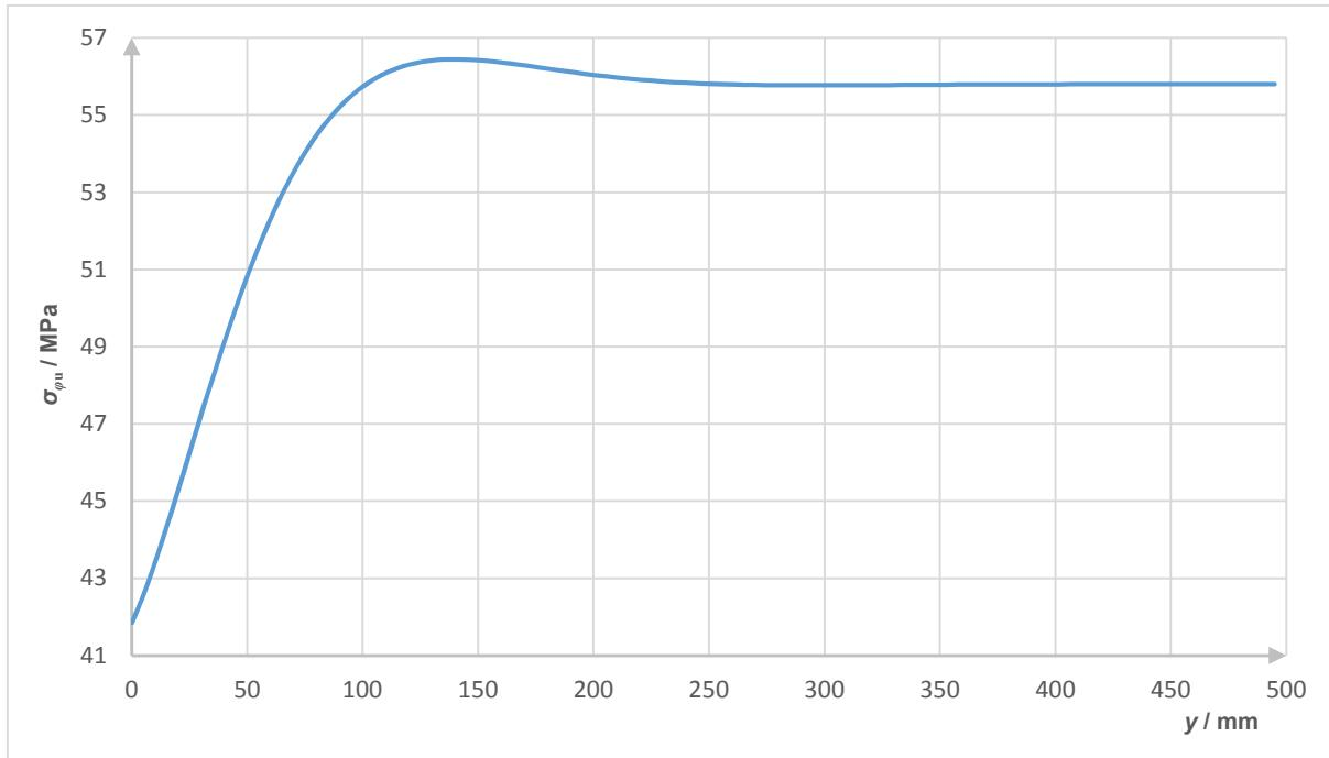
Slika 34. Raspodjela cirkularnih naprezanja duž unutrašnjeg ruba cilindrične ljske
