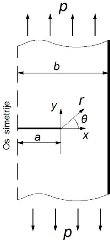
Slika 91. Geometrija vlačno opterećene ploče sa središnjom pukotinom
