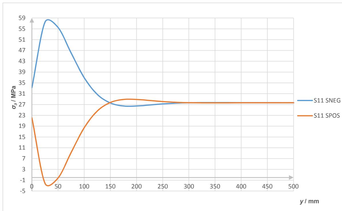
Slika 73. Raspodjela meridijalnih naprezanja duž vanjskog i unutarnjeg ruba cilindrične ljske
