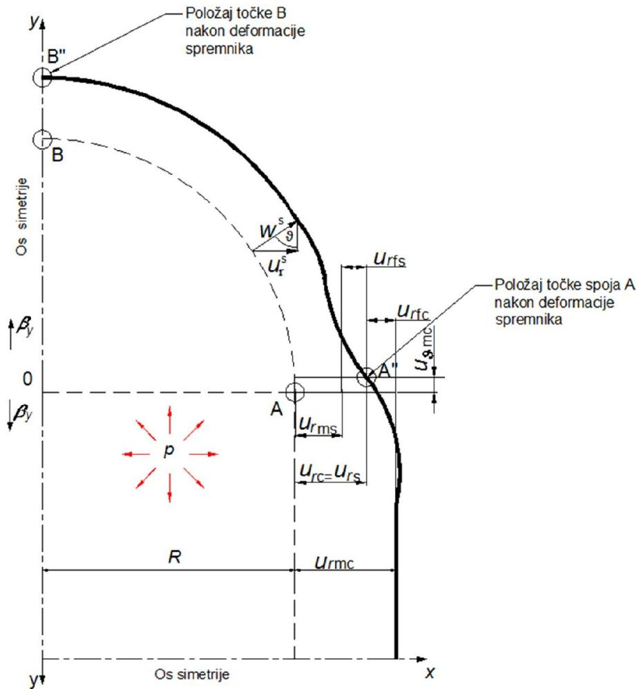
Slika 54. Shematski prikaz spoja sferne i cilindrične ljske
