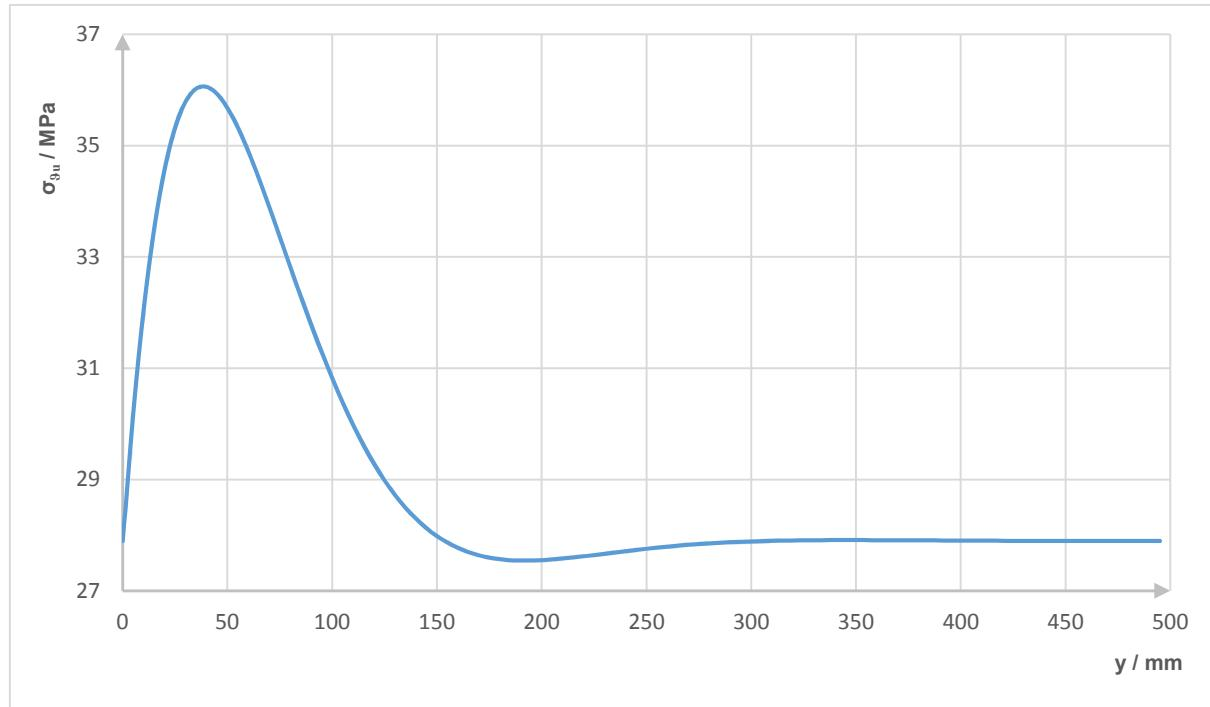
Slika 20. Raspodjelu meridijalnih naprezanja duž unutarnjeg ruba sferne ljske
