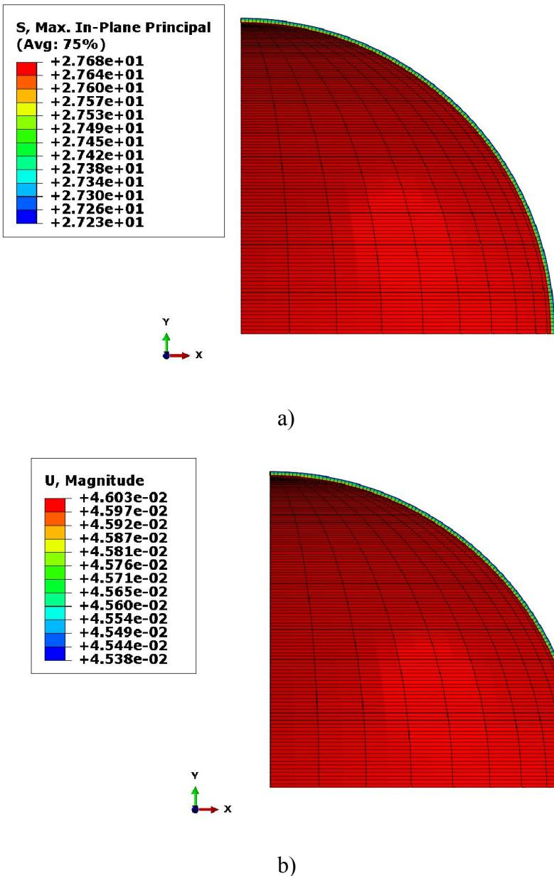
Slika 46. Raspodjela: a) cirkularnih naprezanja u MPa, i b) normalnih pomaka u mm, Tablicom 12. prikazana je usporedba dobivenih numeričkih rješenja cirkularnih naprezanja i radikalnih pomaka prema analitičkim rješenjima s obzirom na odabranu gustoću mreže.
