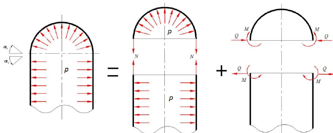
Slika 9. Rastavljanje općeg stanja naprezanja u ljudsci na membransko stanje naprezanja i lokalno savijanje prema [8]
