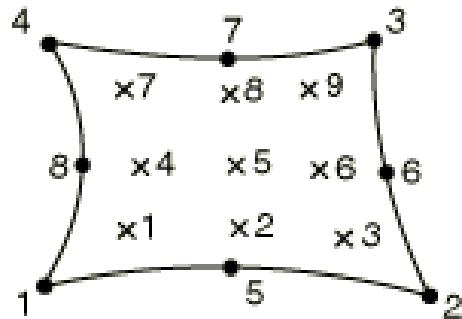
Slika 38. Osnosimetrični pravokutni element drugog reda [10]
