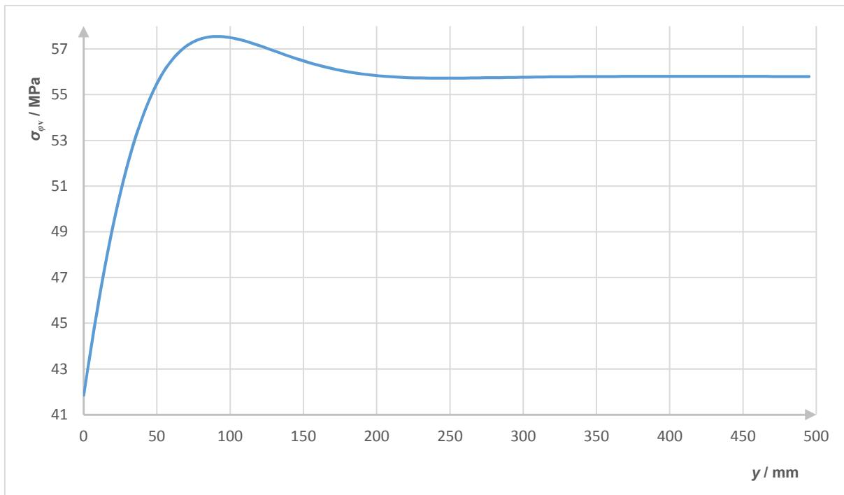
Slika 31. Raspodjela cirkularnih naprezanja duž vanjskog ruba cilindrične ljske
