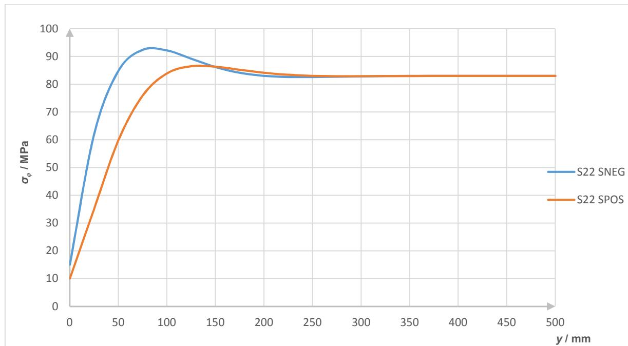
Slika 84. Raspodjela cirkularnih naprezanja duž vanjskog i unutarnjeg ruba cilindrične ljske
