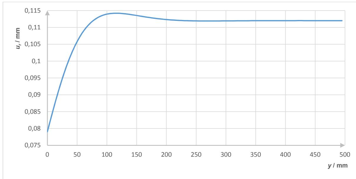
Slika 26. Raspodjela ukupnog radijalnog pomaka cilindrične ljske
