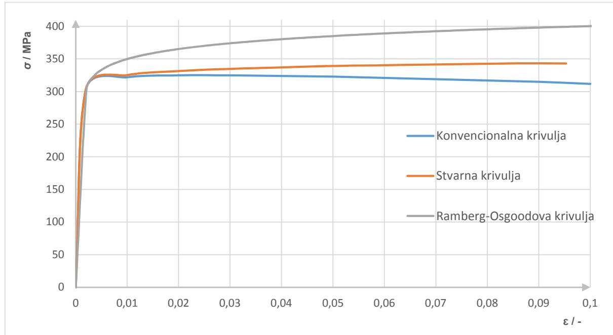
Slika 100. Dijagram naprezanje-deformacija za kotlovski čelik P265GH
