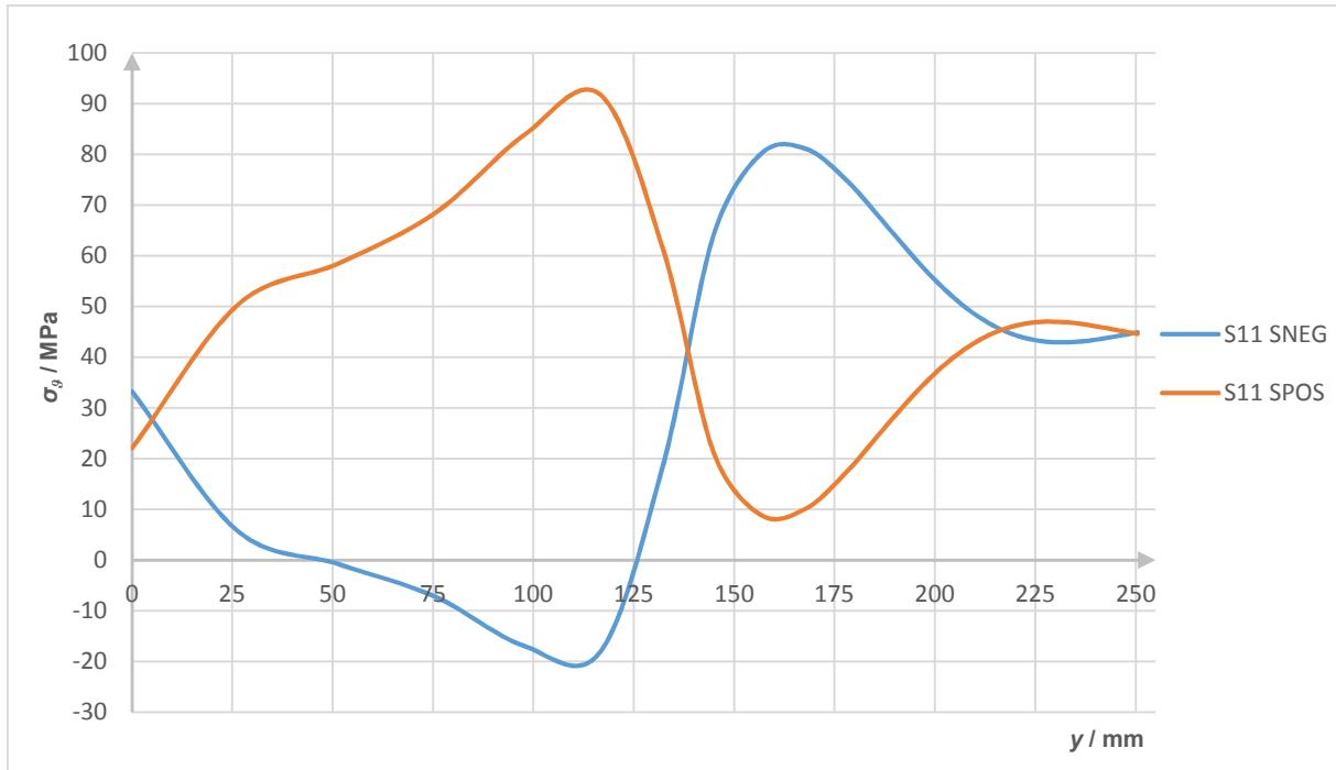
Slika 69. Raspodjela meridijalnih naprezanja - radno opterećenje
