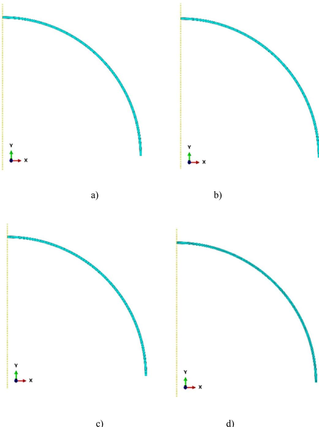
Slika 45. Mreže diskretizirane CAX8 elemenatima: a) model s 32 elementa, b) model s 52 elementa, c) model s 78 elementa, d) model s 130 elemenata
