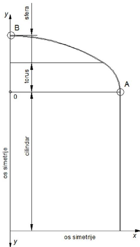
Slika 65. Shematski prikaz torisferne podnice i cilindra
