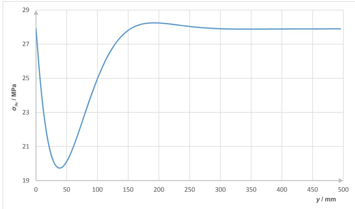
Slika 33. Raspodjela meridijalnih naprezanja duž unutrašnjeg ruba cilindrične ljske
