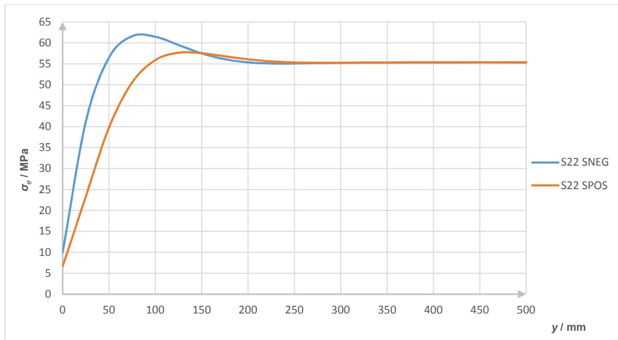
Slika 74. Raspodjela cirkularnih naprezanja duž vanjskog i unutarnjeg ruba cilindrične ljske
