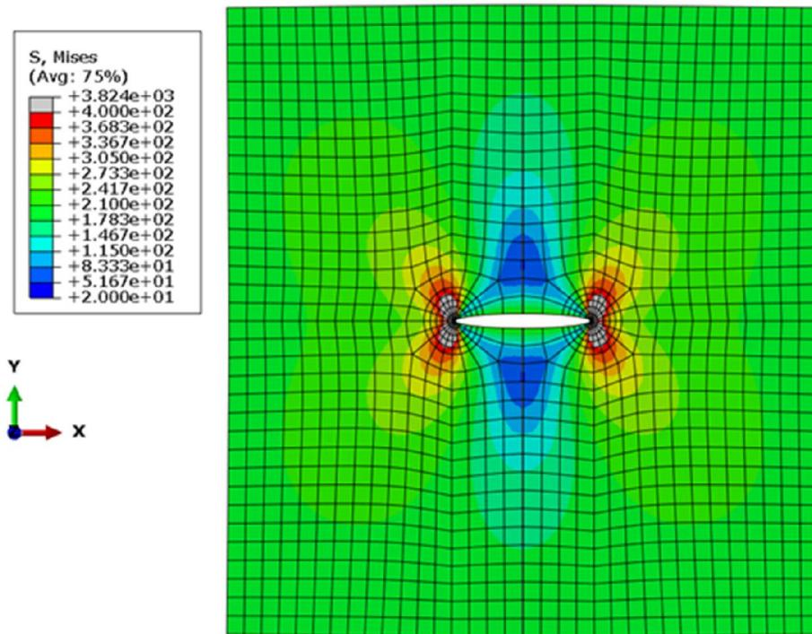
Slika 98. Polje ekvivalentnog naprezanja prema Von Misesu za slučaj linearne elastične analize pri opterećenju  $\sigma_y = 200$  MPa i duljini pukotine  $a = 12$  mm
