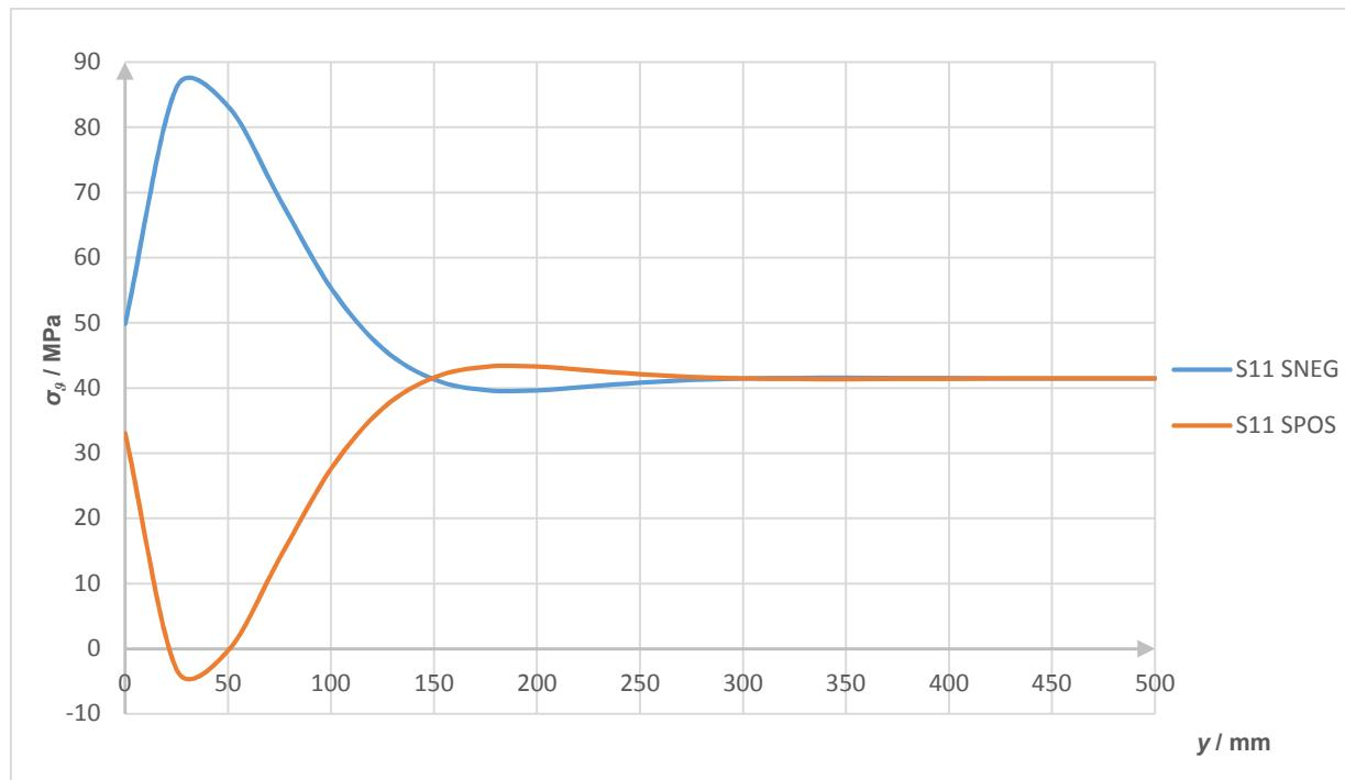
Slika 83. Raspodjela meridijalnih naprezanja duž vanjskog i unutarnjeg ruba cilindrične ljske
