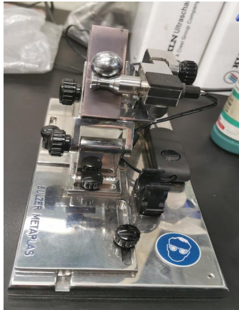
Slika 33. Kalotester na kojem su rađena ispitivanja (Sulzer Metaplast)
