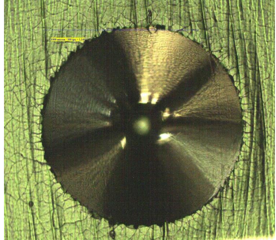
Slika 51. Otisak HRC ispitivanja na kromiranoj prevlakama A2 i B2
