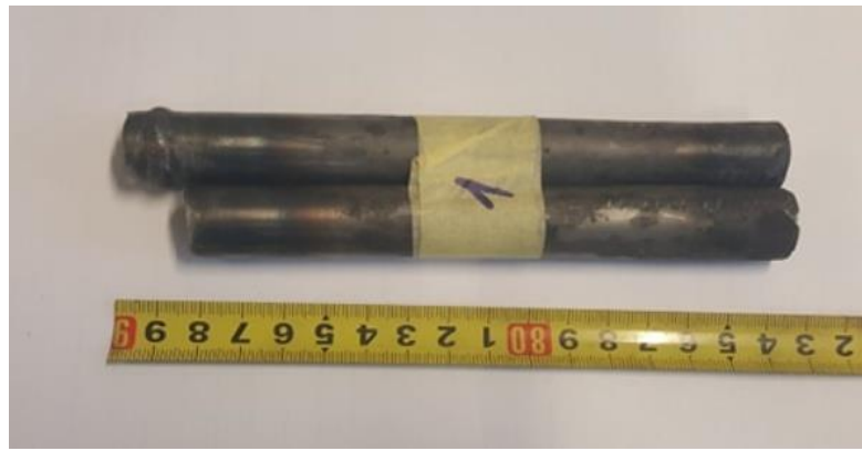
Slika 37: Uzorak A nakon statičnog vlačnog pokusa
