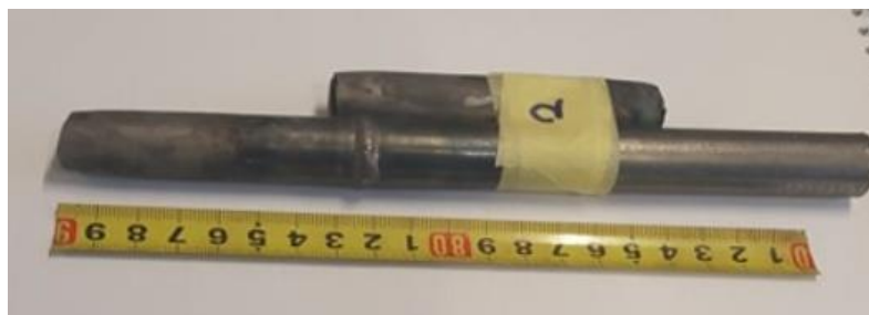
Slika 38: Uzorak B nakon statičkog vlačnog pokusa
