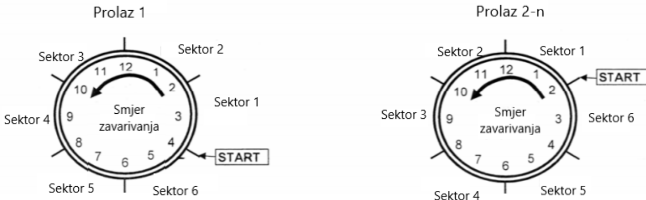
Slika 21: Podjela na sektore kod orbitalnog TIG zavarivanja [20]
