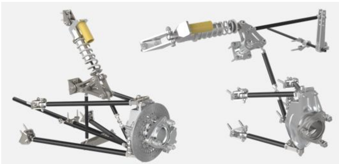
Slika 24: Prikaz ovjesa- prednji (lijevo) i stražnji (desno)
