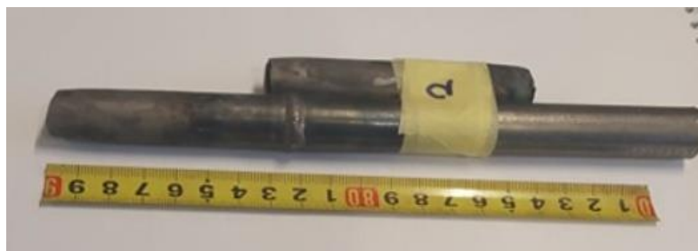
Slika 37: Uzorak A nakon statičnog vlačnog pokusa
